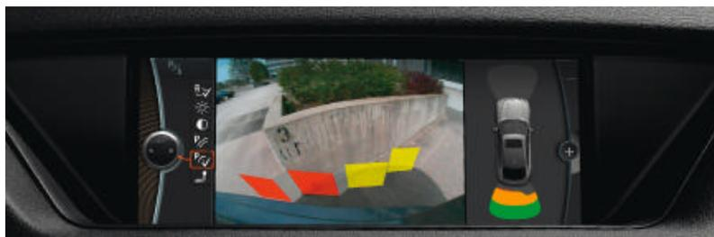
□ **Rückfahrkamera** zeigt den Bereich hinter dem Fahrzeug übersichtlich auf dem Control Display an. Interaktive Spurenlinien zeigen dabei, ob beispielsweise der gewünschte Parkplatz genügend Raum für das Fahrzeug bietet. Verfügt der BMW über eine Anhängerkupplung, vergrößert sich dieser Bildbereich. Die Rückfahrkamera wird automatisch durch Einlegen des Rückwärtsganges aktiviert (in Verbindung mit einem Navigationssystem).
