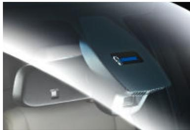
□ **Fernlichtassistent** unterstützt den Fahrer nachts durch automatisches Auf- und Abblenden bei entgegenkommendem und vorausfahrendem Verkehr sowie bei ausreichender Straßenbeleuchtung.
