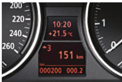
■ **Bordcomputer** informiert über Durchschnittsgeschwindigkeit, Durchschnitts- und Momentanverbrauch, Reichweite und Außentemperatur. ■ **Schaltpunktanzeige** zeigt an, wenn Sie in einem anderen Gang verbrauchsgünstiger fahren würden. Das System gibt Empfehlungen zum Hoch- oder Zurückschalten und passt diese Ihrem Fahrstil an (für Fahrzeuge mit 6-Gang Schaltgetriebe).
