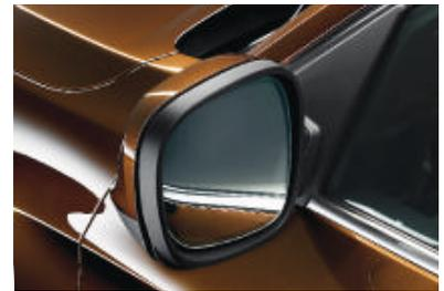
■ **Außenspiegel,** in Wagenfarbe lackiert, elektrisch verstellbar und auf der Fahrerseite asphärisch. Darüber hinaus sind die Spiegel beheizt. □ **Innen- und Außenspiegel, automatisch abblendend;** ab einem definierten Lichteinfall durch nachfolgende Fahrzeuge blenden die Spiegel automatisch ab.
