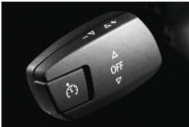
□ **Geschwindigkeitsregelung mit Bremsfunktion** speichert ab ca. 30 km/h die gewünschte Geschwindigkeit und hält sie konstant (Betätigung über Lenkstockhebel links).
