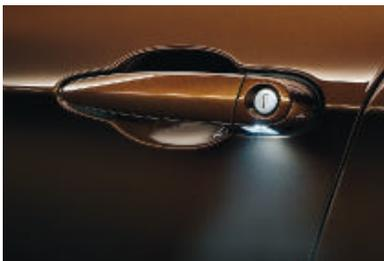
□ **Lichtpaket** umfasst die Vorfeldbeleuchtung in den Türgriffen, die nach dem Entriegeln der Türen den Einstiegsbereich 20 Sekunden lang ausleuchtet – für einen sicheren Einstieg bei Dunkelheit. Weitere Umfänge: Leseleuchten vorn und hinten, Fußraumleuchte vorn, Make-up-Spiegel-Beleuchtung für Fahrer und Beifahrer und Ambientlicht.
