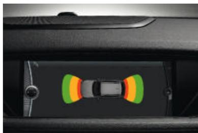
□ **Park Distance Control, vorn und hinten**, erleichtert das Einparken und Rangieren auf engstem Raum; die Entfernung von Ihrem Fahrzeug zu einem Hindernis wird akustisch und in Verbindung mit einem optionalem Navigationssystem auch optisch im Control Display gemeldet.
