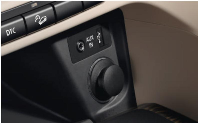
■ **AUX-IN Anschluss**, inkl. 12-V-Steckdose, zum Anschluss einer externen Audioquelle, wie zum Beispiel eines MP3-Players.
