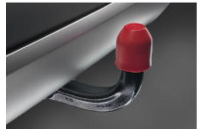
□ **Anhängerkupplung** mit abnehmbarem Kugelkopf (der abgenommene Kugelkopf lässt sich praktisch unter dem Laderaumboden verstauen). Die Anhängelast beträgt je nach Modell bis zu 2.000 kg.
