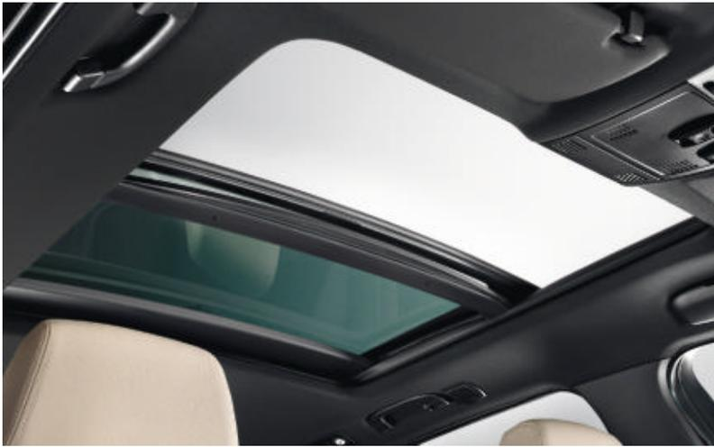
□ **Panorama-Glasdach** mit großzügigem Öffnungs- und Durchsichtsbereich sowie Windabweiser. Die vordere Glashälfte lässt sich per Tippfunktion elektrisch anheben und verfügt zusätzlich über Schiebefunktion, elektrischen Schwebehimmel (Sonnenschutz) sowie Komfortöffnung/-schließung mit Einklemmschutz.
