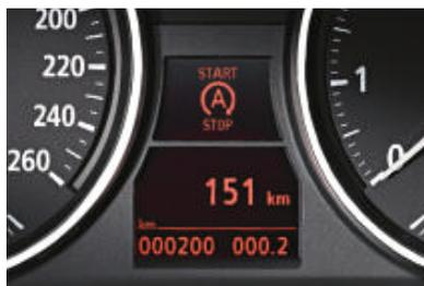
■ **Auto Start Stop Anzeige** signalisiert im Info Display, wenn der Motor über die Auto Start Stop Funktion abgeschaltet ist (z. B. vor einer Ampel oder bei einem Stau). Die Anzeige erlischt wieder beim erneuten automatischen Starten des Motors (für alle Vierzylinder-Modelle in Verbindung mit 6-Gang Schaltgetriebe).
