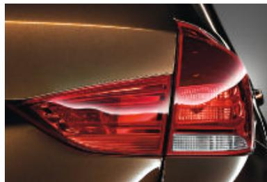
■ **Dynamische Bremsleuchten** helfen nachfolgenden Fahrzeugen, Ihre Bremssituation besser einschätzen zu können: Bei einem normalen Bremsvorgang leuchten die Bremsleuchten großflächig auf – erst im Falle einer Notbremsung beginnen die Bremsleuchten zu blinken. So kann der nachfolgende Verkehr sofort ein leichtes Bremsen von einer Vollbremsung unterscheiden – für noch mehr Fahrsicherheit.
