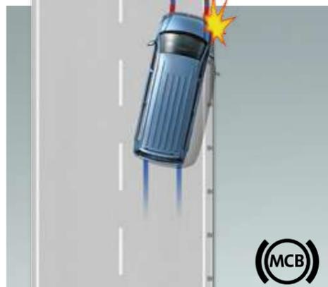
**Multikollisionsbremse.** Leitet nach einer Kollision den Bremsvorgang ein, um im Idealfall Folgekollisionen zu vermeiden. Die Multikollisionsbremse wird aktiv, wenn zwei voneinander unabhängige Sensoren einen Unfall erkennen. Nach einer kurzen Verzögerung wird das Fahrzeug schubweise auf 10 km/h abgebremst, wobei der Fahrer jederzeit wieder die Kontrolle übernehmen kann.<sup>1)</sup>
