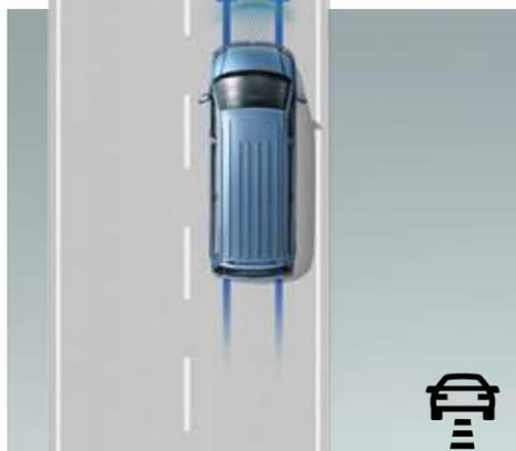
**Automatische Distanzregelung ACC.** Passt die Geschwindigkeit automatisch der des vorausfahrenden Fahrzeugs an und hält dabei den vom Fahrer eingegebenen Abstand. Die eingestellte Geschwindigkeit wird dabei nicht überschritten.<sup>1), 2), 5)</sup> Enthält bereits das Umfeldbeobachtungssystem „Front Assist“.
