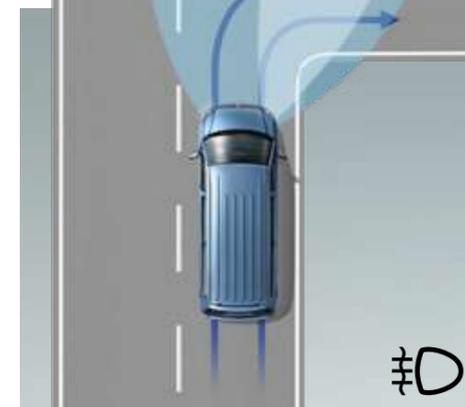
**Nebelscheinwerfer mit integriertem Abbiegelicht.** Sorgen bei schlechter Witterung für optimale Sicht. Beim Abbiegen leuchtet der jeweils kurveninnere Scheinwerfer den Straßenrand aus.<sup>1), 2)</sup>
