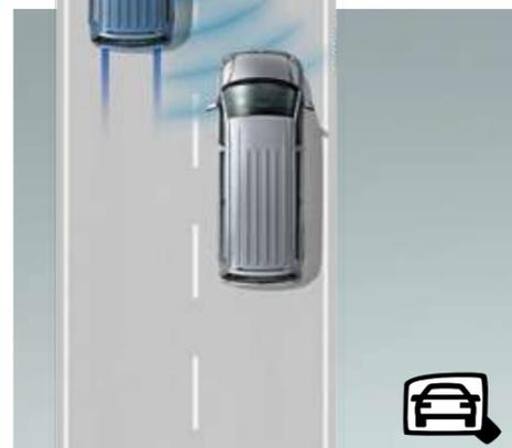
**Spurwechselassistent „Side Assist“.** Warnt über eine Anzeige im Außenspiegel<sup>1)</sup>, sobald sich beim Spurwechsel ein von den Sensoren erkanntes Fahrzeug im nicht einsehbaren Bereich befindet.<sup>2)</sup>
