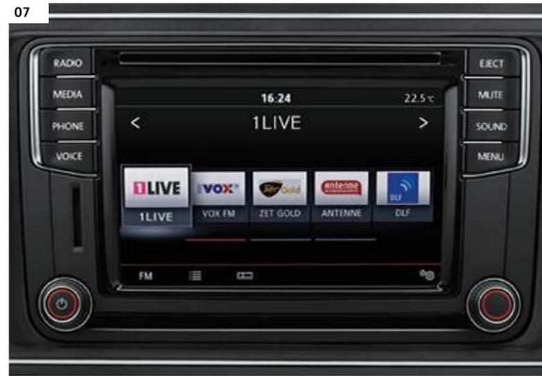
**07 Radiosystem „Composition Media“.** Das System umfasst ein 16,5 cm (6,33 Zoll) großes TFT-Farbdisplay, einen Touchscreen mit Annäherungssensor, ein MP3- und WMA-fähiges CD-Laufwerk, 4 x 20 Watt Leistung mit sechs Lautsprechern, einen SD-Kartenschacht, eine AUX-IN-Schnittstelle und eine u. a. iPhone-fähige USB-Schnittstelle im Handschuhfach, eine Bluetooth-Anbindung für Mobiltelefone sowie einen Doppel-Tuner mit Phasen-Diversity. | TL | CL | PA | HL |
