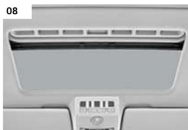
**06 Standheizung.** Sie arbeitet unabhängig von der Heizungs- und Belüftungsanlage und ist sowohl über das zentrale Bedienfeld steuerbar als auch per Fernbedienung. Auf Wunsch ist alternativ auch eine Wasserzusatzheizung erhältlich. | TL | CL | PA | HL |
