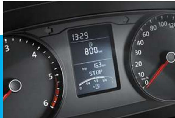
**01 Start-Stopp-System.** Es schaltet den Motor im Leerlauf und bei gelöster Kupplung<sup>2)</sup> automatisch ab, z. B. an einer roten Ampel. Zum Starten genügt ein Tritt auf die Kupplung und der Motor springt wieder an.
