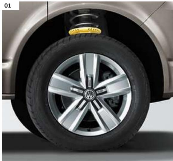
**01 Fahrzeughöherlegung.** Durch ca. 30 mm mehr Bodenfreiheit wird die Gefahr des Aufsetzens verringert und so die Geländegängigkeit optimiert. Die Fahrzeughöherlegung umfasst den Austausch von Federn und Dämpfern sowie eine abschließende Achsvermessung zur Feinabstimmung.<sup>1), 2)</sup> | TL | CL | PA | HL |
