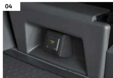
**03 230-V-Steckdose im Fahrgastraum.** Über eine zweite Batterie liefert die 230-V-Steckdose während der Fahrt und auch im Stand Strom (230 V/150 W/50 Hz). Sie ist im Bereich der linken C-Säule angebracht.<sup>1)</sup> | TL | CL | PA | HL |
