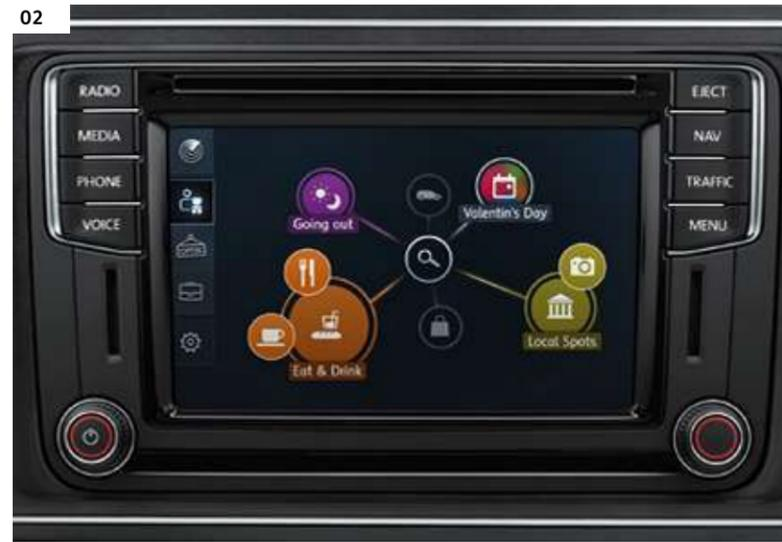
**02 Car-Net App-Connect.**<sup>2), 3)</sup> Mit dieser Funktion können Sie kompatible Apps Ihres Smartphones während der Fahrt bedienen. Dazu werden diese über eine USB-Schnittstelle auf das Display des Radio- oder Navigationssystems gespiegelt und über den Touchscreen gesteuert. | TL | CL | PA | HL |
