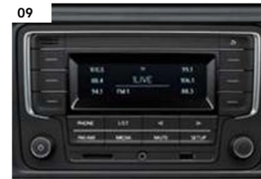
**09 Radiosystem „Composition Audio“.** Das System umfasst ein monochromes TFT-Display, 4 x 20 Watt Leistung mit vier Lautsprechern, einen SD-Kartenschacht, eine AUX-IN-Schnittstelle und eine USB-Schnittstelle sowie eine Bluetooth-Anbindung für Mobiltelefone. | TL |
