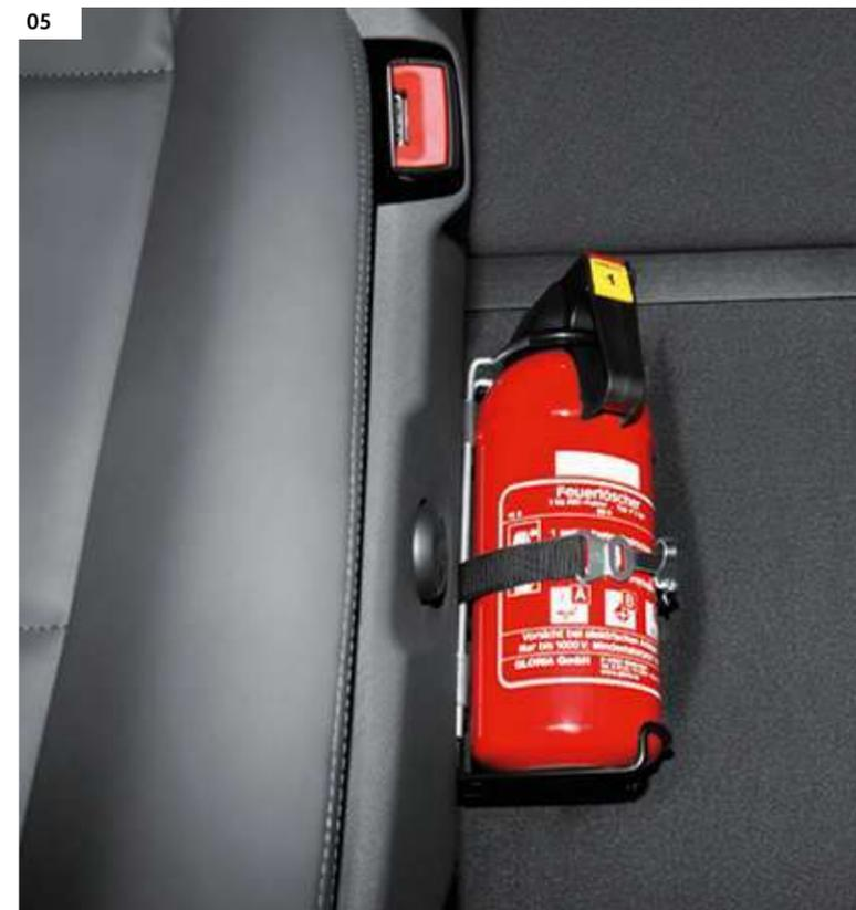
**05 Feuerlöscher.** Für eine schnelle Erreichbarkeit wird der Feuerlöscher links am Sitzkasten des Beifahrersitzes montiert. Er ist mit einem Manometer ausgestattet und fasst 2 kg Füllmenge.<sup>1)</sup> | TL | CL | PA | HL |
