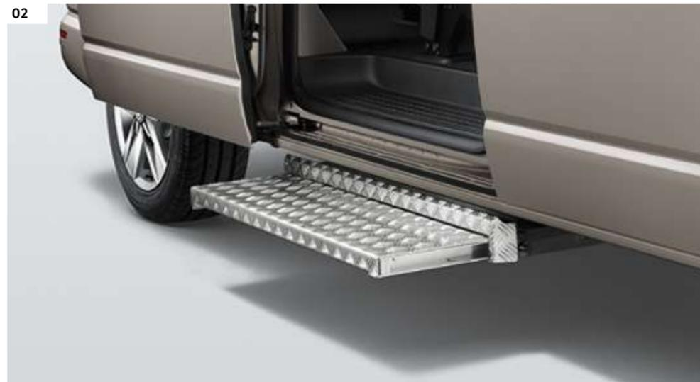
**02 Elektrische Trittstufe.** Beim Öffnen und Schließen der Schiebetüren fährt die elektrische Trittstufe automatisch aus und ein. Für Sicherheit sorgt die robuste Trittfläche aus Aluminium-Riffelblech, 300 kg Belastbarkeit und die zuverlässige Hindernisabschaltung. Die elektrische Trittstufe ist nur für Fahrzeuge mit zwei Schiebetüren erhältlich und wird beidseitig angebracht. | TL | CL | HL |
