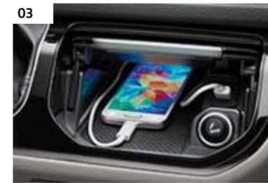
**03 Mobiltelefon-Schnittstelle „Comfort“.**<sup>6)</sup> Das spezielle Ablagefach für Ihr Mobiltelefon verfügt über eine kabellose Außenantennenanbindung zur Optimierung der Mobilfunk-Sende- und Empfangsqualität. Auch das Aufladen geht ganz einfach: Dazu muss das Telefon lediglich mit der USB-Schnittstelle des Ablagefachs verbunden werden. | TL | CL | PA | HL |
