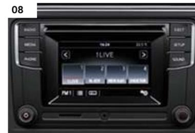
**08 Radiosystem „Composition Colour“.** Das System umfasst ein 12,7 cm (5 Zoll) großes TFT-Farbdisplay mit Touchscreen, ein MP3- und WMA-fähiges CD-Laufwerk, 4 x 20 Watt Leistung mit sechs Lautsprechern, einen SD-Kartenschacht, eine AUX-IN-Schnittstelle, eine u. a. iPhone-fähige USB-Schnittstelle und eine Bluetooth-Anbindung für Mobiltelefone sowie einen Doppel-Tuner mit Phasen-Diversity für bestmöglichen Radioempfang. | TL | CL | PA | HL |
