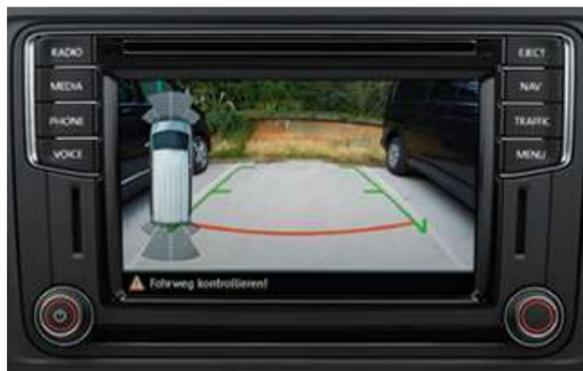
**Rückfahrkamera „Rear View“.** Erleichtert das Einparken, indem sie ein eingeschränktes Bild des Bereichs hinter dem Fahrzeug auf dem Display des Radio-<sup>1)</sup> oder Navigationssystems abbildet. Zusätzliche Hilfslinien unterstützen den Einparkvorgang. Die Rückfahrkamera ist nur in Kombination mit der Heckklappe erhältlich. | TL | CL | PA | HL |
