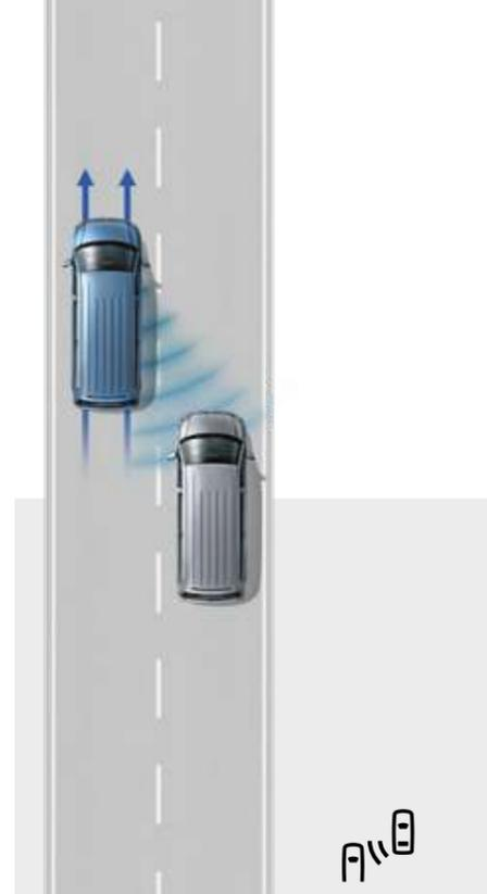
**Spurwechselassistent „Side Assist“.**<sup>3)</sup> Warnt über eine Anzeige im Außenspiegel, sobald sich beim Spurwechsel ein von den Sensoren erkanntes Fahrzeug im nicht einsehbaren Bereich befindet. | TL | CL | HL |
