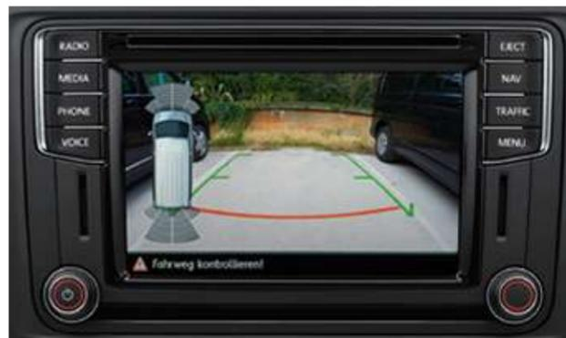
**Rückfahrkamera „Rear View“.** Erleichtert das Einparken, indem sie ein eingeschränktes Bild des Bereichs hinter dem Fahrzeug auf dem Display des Radio<sup>-2)</sup> oder Navigationssystems abbildet. Zusätzliche Hilfslinien unterstützen den Einparkvorgang. | TL | CL | HL |
