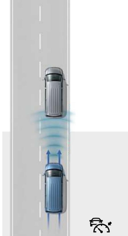
**Automatische Distanzregelung ACC.**<sup>3)</sup> Passt die Geschwindigkeit automatisch der des vorausfahrenden Fahrzeugs an und hält dabei den vom Fahrer vorgegebenen Abstand. Die eingestellte Geschwindigkeit wird dabei nicht überschritten. Enthält bereits das Umfeldbeobachtungssystem „Front Assist“. | TL | CL | HL |
