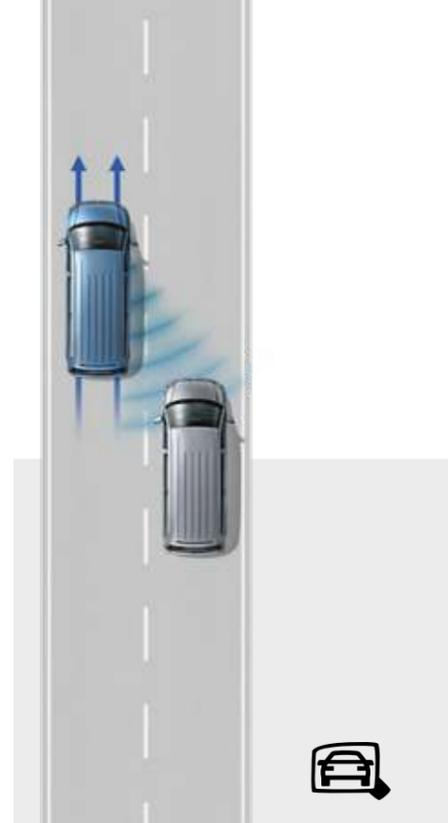
**Spurwechselassistent „Side Assist“.**<sup>1)</sup> Warnt über eine Anzeige im Außenspiegel, sobald sich beim Spurwechsel ein von den Sensoren erkanntes Fahrzeug im nicht einsehbaren Bereich befindet. | TL | CL | HL |
