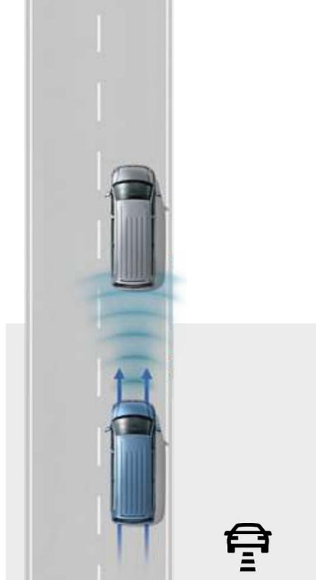
**Umfeldbeobachtungssystem „Front Assist“ mit City-Notbremsfunktion<sup>3), 1)</sup>** Mittels eines Radarsystems hilft es bei erkannten kritischen Abstandssituationen, den Anhalteweg zu verkürzen. Warnt den Fahrer in erkannten Gefahrensituationen optisch und akustisch sowie mit einem Bremsdruck. | TL | CL | HL |
