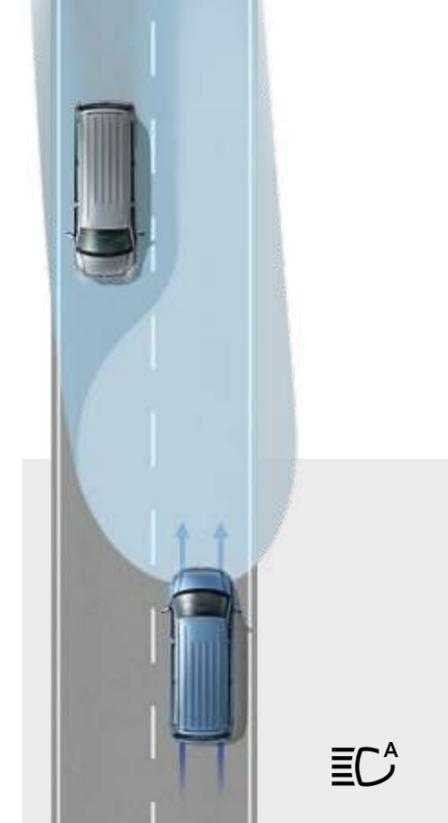
**Fernlichtregulierung „Light Assist“.** Blendet bei entgegenkommenden oder vorausfahrenden Fahrzeugen automatisch ab, bevor diese geblendet werden. Ab 60 km/h und bei völliger Dunkelheit schaltet sich das Fernlicht bei zuvor aktiviertem System selbstständig ein. | TL | CL | HL |
