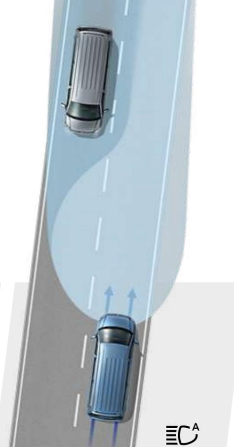
**Fernlichtregulierung „Light Assist“.** Blendet bei entgegenkommenden oder vorausfahrenden Fahrzeugen automatisch ab, bevor diese geblendet werden. Ab 60 km/h und bei völliger Dunkelheit schaltet sich das Fernlicht bei zuvor aktiviertem System selbstständig ein. | BE | CO | OC |
