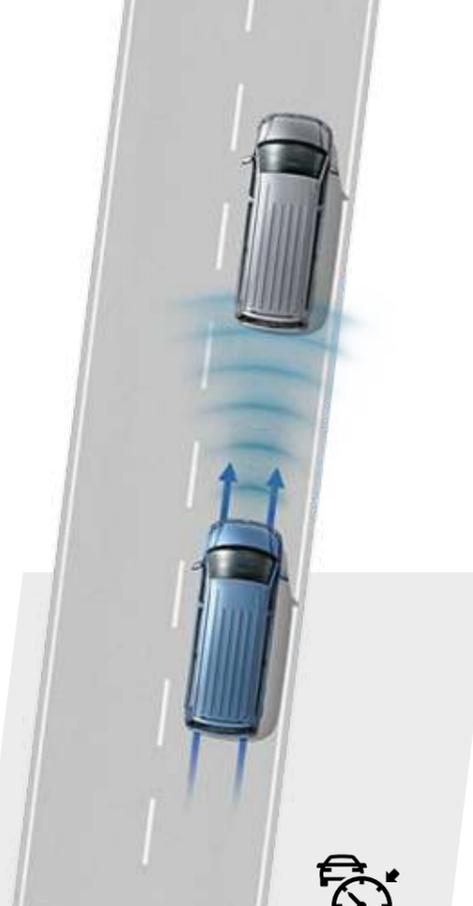
**Automatische Distanzregelung ACC.**<sup>2)</sup> Passt die Geschwindigkeit automatisch der des vorausfahrenden Fahrzeugs an und hält dabei den vom Fahrer vorgegebenen Abstand. Die eingestellte Geschwindigkeit wird dabei nicht überschritten. Enthält bereits das Umfeldbeobachtungssystem „Front Assist“. | BE | CO | OC |
