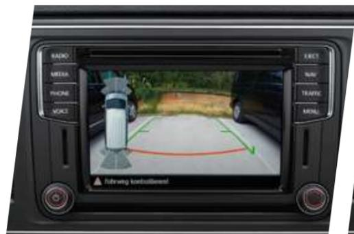
**Rückfahrkamera „Rear View“.** Erleichtert das Einparken, indem sie ein eingeschränktes Bild des Bereichs hinter dem Fahrzeug auf dem Display des Radio-<sup>1)</sup> oder Navigationssystems abbildet. Zusätzliche Hilfslinien unterstützen den Einparkvorgang. | BE | CO | OC |
