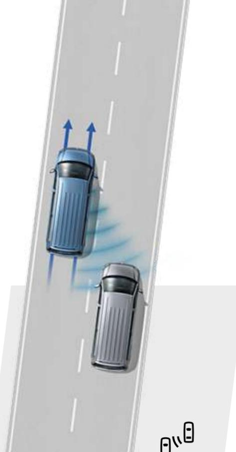
**Spurwechselassistent „Side Assist“.**<sup>2)</sup> Warnt über eine Anzeige im Außenspiegel, sobald sich beim Spurwechsel ein von den Sensoren erkanntes Fahrzeug im nicht einsehbaren Bereich befindet. | BE | CO | OC |
