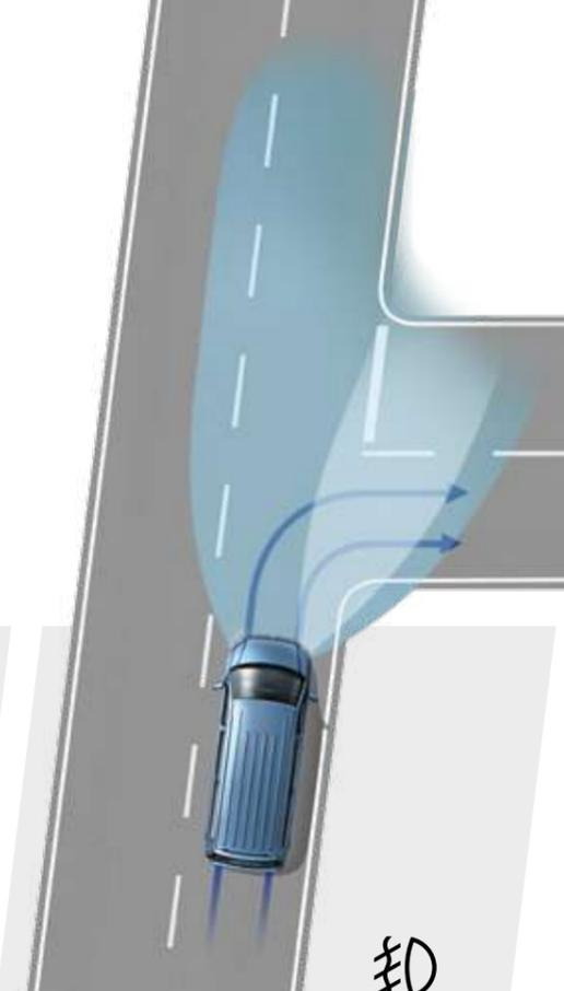
**Nebelscheinwerfer mit integriertem Abbiege-licht.** Sorgen bei schlechter Witterung für optimale Sicht. Beim Abbiegen leuchtet der jeweils kurveninnere Scheinwerfer den Straßenrand aus. | BE | CO | OC |
