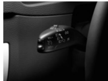
Die **Geschwindigkeitsregelanlage**. Ab einer Geschwindigkeit von 30 km/h können Sie per Knopfdruck das gewählte Tempo konstant halten. Eine kurze Betätigung der Bremse genügt, um die Anlage zu deaktivieren.
