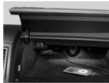
Die **MEDIA-IN-Schnittstelle**. An ein USB-Adapterkabel können externe Audioquellen angeschlossen werden, z. B. MP3-Player. Die Bedienung erfolgt über das serienmäßige Radio „RCD 310“ oder über ein optionales Radio-Navigationssystem.
