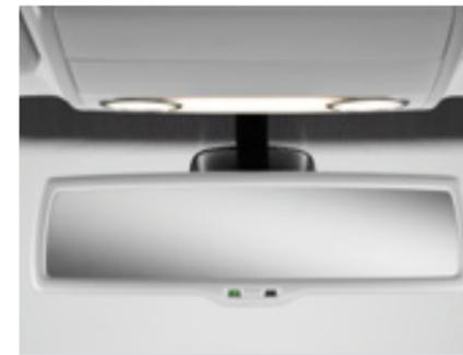
Der **automatisch abblendende Innen Spiegel** und der **Regensensor**. Der Innenspiegel dunkelt bei zu hellen Scheinwerfern des Fahrzeugs hinter Ihnen selbsttätig ab. Der Regensensor aktiviert bereits bei leichtem Regen die Scheibenwischer.
