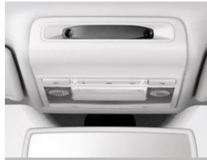
Die Diebstahlwarnanlage mit Innenraumüberwachung reagiert mithilfe von Sensoren auf Manipulationen an der Motorhaube, den Türen und der Heckklappe. Zusätzlich geben Einzeltüröffnung, Wegfahrsperrung, Abschleppschutz und Back-up-Horn ein sicheres Gefühl.
