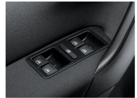
**Elektrische Fensterheber vorn und hinten** regeln die Luftzufuhr ganz bequem. Sobald der hochsensible Einklemmschutz einen Widerstand zwischen Fenster und Rahmen registriert, wird die Scheibe sofort ein Stück abgesenkt.
