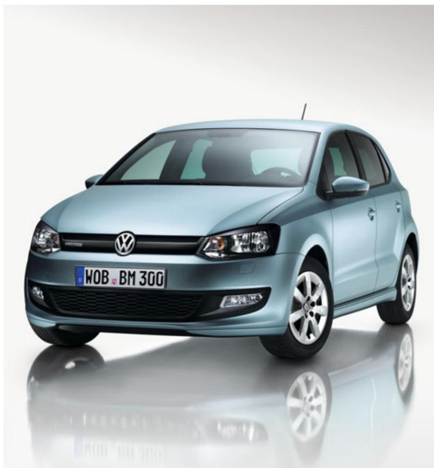
Eine ganze Reihe von Maßnahmen trägt zum Erreichen der überzeugenden Verbrauchs- und Emissionswerte des Polo BlueMotion bei. So ist der schwarze Kühlergrilleinsatz ebenso aerodynamisch optimiert wie der Frontspoiler, der Seitenschweller und der modifizierte Unterboden. Das Ergebnis dieser Verbesserungen ist dabei nicht nur eine herausragende Aerodynamik, sondern ein Auto, das auch aufgrund seines faszinierenden Designs als ein ganz besonderes zu erkennen ist.
