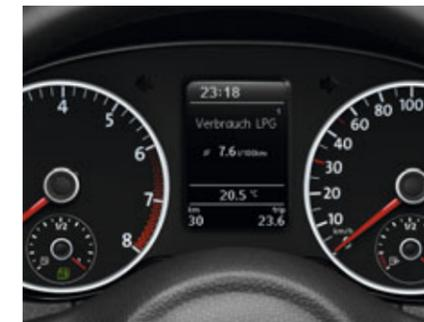
Dem **Kombi-Instrument** können Sie entnehmen, ob Sie gerade im Autogas- oder Benzinbetrieb unterwegs sind. Zudem informiert es Sie über den Durchschnittsverbrauch, die Restreichweite sowie den aktuellen Tankfüllstand beider Betriebsarten.
