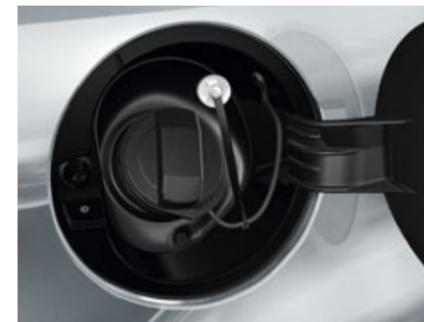
Tanken wie gewohnt: Der **Autogas-einflüllstutzen** für den Tank lässt sich einfach und sicher handhaben.
