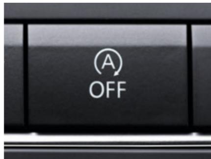
Das Start-Stop-System steht für sparsames und schadstoffarmes Fahren. Beim Halten im Stau oder an einer Ampel reicht es, die Kupplung zu lösen und den Gang herauszunehmen, und der Motor schaltet sich aus. Zum Weiterfahren kuppeln Sie einfach wieder ein.
