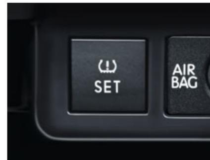
Die **Reifenkontrollanzeige** hält Sie über den Luftdruck der Reifen auf dem Laufenden. Dieser ist eine wichtige Sicherheitskomponente, die regelmäßig automatisch geprüft wird.
