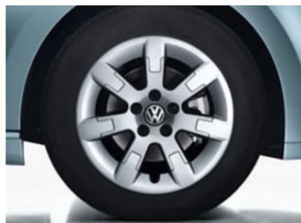
Da der Rollwiderstand herkömmlicher Reifen für bis zu 15 Prozent des Verbrauchs verantwortlich ist, sind auf das Leichtmetallrad „Grönland“<sup>(1)</sup> im Format 5 1/2 J x 15 spezielle, rollwiderstandsoptimierte Reifen gezogen.
