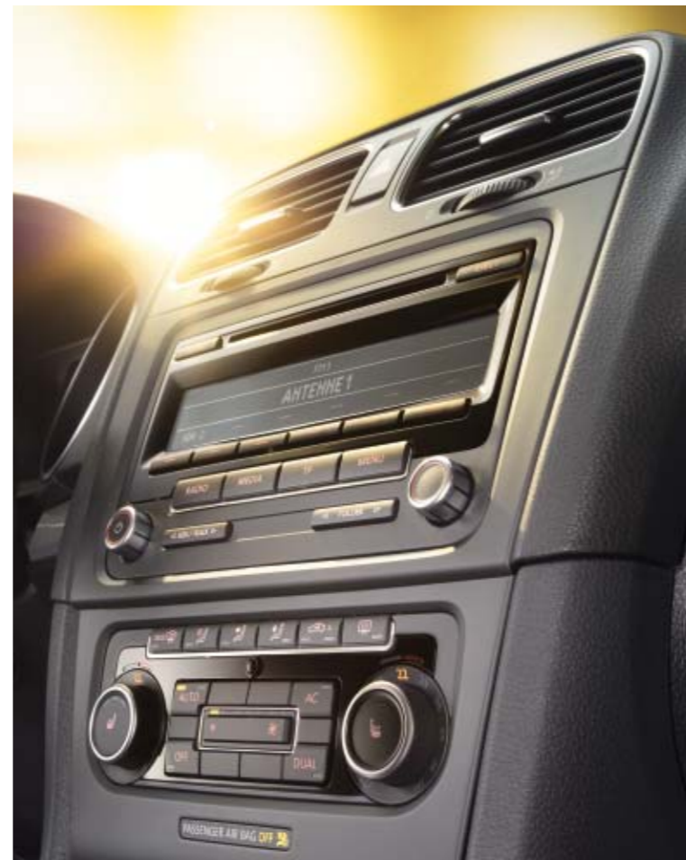
Klimaanlage „Climatronic“ und Radio „RCD 310“ Die Klimaanlage „Climatronic“ regelt die Temperatur elektronisch und teilt den Innenraum in zwei Klimazonen für Fahrer- und Beifahrerseite. Temperatur, Luftzufuhr und -verteilung können individuell eingestellt werden. Einen weiteren Beitrag zum Wohlgefühl-Ambiente liefert das Radio „RCD 310“ mit großem, zweifarbigen Display, Titelanzeige und AUX-IN-Buchse. Es hat acht Lautsprecher sowie 4 x 20 Watt Ausgangsleistung, verfügt über eine 2fach-Klangregelung und spielt auch MP3- und WMA-Dateien ab.
