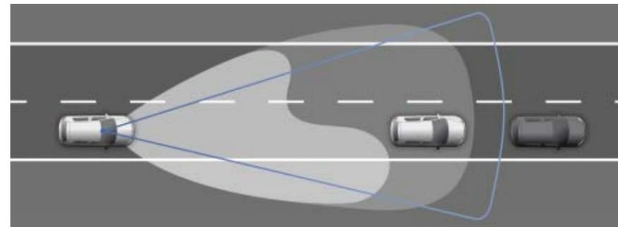
Auch wenn Sie sich bei eingeschaltetem Fernlicht einem vorausfahrenden Kraftfahrzeug so weit genähert haben, dass dessen Fahrer von Ihnen geblendet werden könnte, erkennt die Fernlichtregulierung „Light Assist“ dies und schaltet das Fernlicht ab. Ist der Bereich vor Ihnen frei, wird es automatisch wieder aktiviert. Durch dieses intelligente System wird die Einschaltzeit des Fernlichts deutlich erhöht. Es entlastet den Fahrer und bietet dank der verbesserten Sicht zusätzlichen präventiven Schutz.
