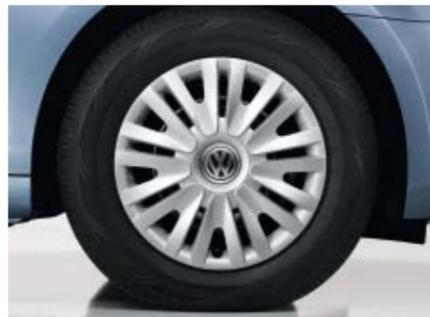
Das **Stahlrad** im Format 6 J x 15 mit Radvollblenden und Bereifung 195/65 R 15 bringt Verlässlichkeit und Beständigkeit mit sich.
