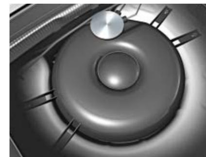
Der **Autogastank** des Golf BiFuel befindet sich in der Reserveradmulde und ist damit ausgesprochen platzsparend untergebracht. Selbstverständlich genügt seine Konstruktion höchsten Sicherheitsstandards.
