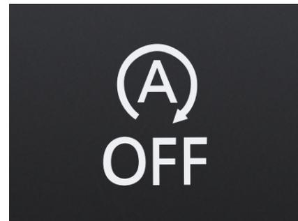
Das **Start-Stopp-System** steht für sparsames und schadstoffarmes Fahren. Beim Halten im Stau oder an einer Ampel reicht es, die Kupplung zu lösen und den Gang herauszunehmen, und der Motor schaltet sich aus. Zum Weiterfahren koppeln Sie einfach wieder ein.
