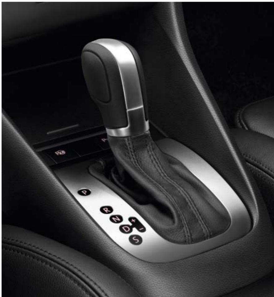
Ein Meilenstein in der Entwicklung des modernen Getriebebaus ist das **Doppelkupplungsgetriebe DSG**. Dieses innovative Automatikgetriebe von Volkswagen wechselt in wenigen Hundertstelsekunden nahezu unmerklich und ohne Zugkraftunterbrechung in den bereits vorgewählten nächsten Gang. Sportliches Beschleunigen macht durch diese extrem kurzen Reaktionszeiten und das direkte Ansprechverhalten gleich doppelt so viel Spaß.
