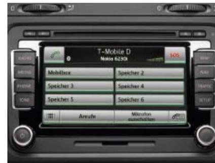
Die **Mobiltelefonvorbereitung „Premium“<sup>(3)</sup>** ist eine Top-Freisprechanlage für höchste Komfortansprüche. Ihr Handy verbindet sich selbstständig mit der Fahrzeug-Außenantenne und kann so beispielsweise in der Jackentasche verbleiben.
