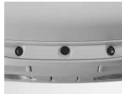
Die Diebstahlwarnanlage „Plus“ verfügt im Innenleuchtenmodul des Dachhimmels über eine Innenraumüberwachung. Inklusiv elektronischer Wegfahrsperrung und Abschleppschutz.
