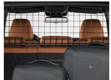
Das stabile **Trenngitter** teilt den Fahrergastraum vom Gepäckraumbereich ab. Mittels Gewindehaken und handlicher Rändelmutter lässt es sich ganz einfach befestigen. Die Gepäckraumabdeckung kann auch mit dem Trenngitter weitergenutzt werden.
