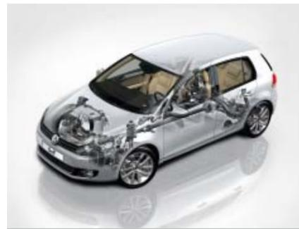
**4MOTION** ist ein permanenter Allradantrieb und bietet neben zuverlässiger Traktion und besserer aktiver Sicherheit auch bei widrigen Wetterbedingungen oder schlechten Fahrbahnverhältnissen einen konstant guten Geradeauslauf für höchste Stabilität.
