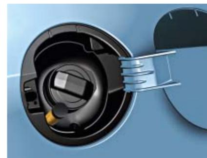
Tanken wie gewohnt: Der **Autogaseinfüllstutzen** für den Tank lässt sich einfach und sicher handhaben. Den Gasfüllstand können Sie im Kombi-Instrument ablesen.
