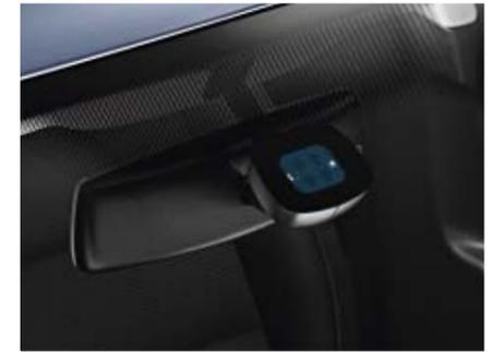
Als Teil des **Licht-und-Sicht-Pakets** regelt der **Regensensor** je nach Regenintensität automatisch die Wischhäufigkeit des Scheibenwischers. Für den Fahrer bedeutet dies mehr Komfort und Sicherheit.
