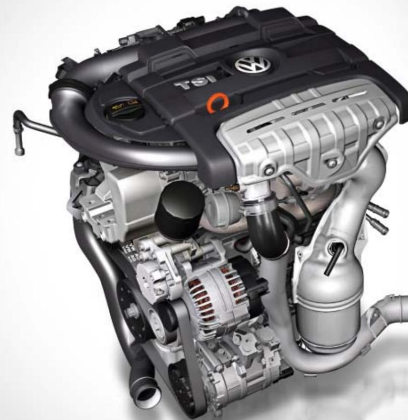
Die Kombination aus Benzin-Direkteinspritzung und intelligenter Aufladetechnik lässt die **Benzinmotoren mit TSI-Technologie** besonders effektiv arbeiten: Damit schaffen sie es, Vorteile wie starke Leistung, hohes Drehmoment und geringen Verbrauch zu verbinden. Je nach Motorisierung kommt dabei entweder der nur von Volkswagen angebotene TSI-Twincharger mit Doppelaufladung oder die TSI-Turbocharger-Technik zum Einsatz.
