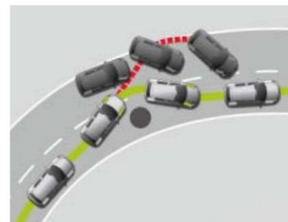
Das Elektronische Stabilisierungsprogramm<sup>1)</sup> verhindert in kritischen Fahrsituationen ein Ausbrechen des Fahrzeugs, indem es gezielt in das Brems- und Motormanagement eingreift. So erreicht das Fahrzeug maximale Richtungsstabilität.
