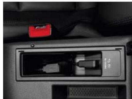
Die **Multimediabuchse MEDIA-IN<sup>1)</sup>** in der Mittelarmlehne mit USB-Schnittstelle erlaubt den Anschluss externer Audioquellen und deren Bedienung über das jeweilige Radio oder Radio-Navigationssystem. MEDIA-IN ist auch mit iPod-Adapterkabel erhältlich.
