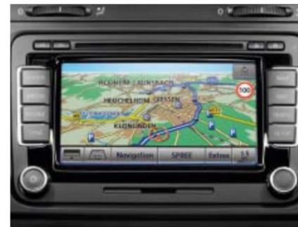
Das **Radio-Navigationssystem „RNS 510“** mit Sprachbedienung, Picture Navigation, Touchscreen, großem Farbdisplay, DVD-Laufwerk, 30-Gigabyte-Festplatte, SD-Kartenschacht, AUX-IN-Buchse und Verkehrszeichenanzeige ist mit vorinstallierten Europakarten ausgestattet.
