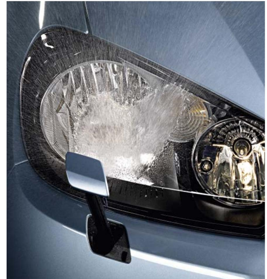
Die **Scheinwerfer-Reinigungsanlage** ist Teil des **Winterpakets**, genau wie beheizbare Vordersitze, eine Warnleuchte für den Waschwasserstand und automatisch beheizte Scheibenwaschdüsen vorn.
