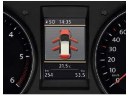
Das große, hochauflösende TFT-Display der farbigen Multifunktionsanzeige „Premium“ ermöglicht die brillante Darstellung wichtiger Fahrinformationen, der Navigationssystem-Zielführung oder des Status Ihres angeschlossenen Mobiltelefons.
