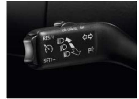
Ab 30 km/h hält die Geschwindigkeitsregelanlage Ihr gewähltes Tempo konstant und trägt auf diese Weise vor allem auf längeren Strecken zum entspannten Fahren bei.
