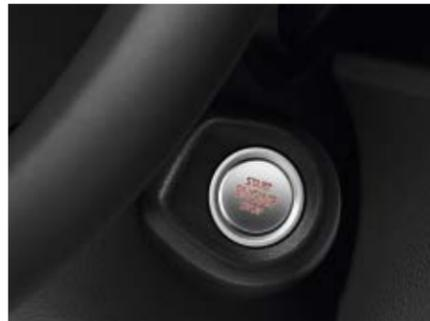
Für höchsten Komfort steht das schlüssellose Schließ- und Startsystem „Keyless Access“. Eine ausgeklügelte Funk- und Sicherheitstechnik ermöglicht das Öffnen und Schließen ohne aktive Nutzung des Schlüssels. Das Starten und Abstellen des Motors erfolgt per Knopfdruck.
