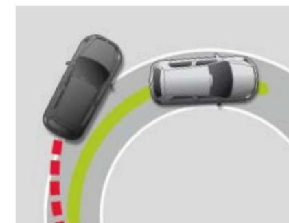
Die elektronische Differenzialsperre XDS<sup>2)</sup> ist eine Erweiterung des Elektronischen Stabilisierungsprogramms. In schnellen Kurven wird das Handling wirkungsvoll verbessert und die Neigung zum Untersteuern vermindert. Mehr Sicherheit, Dynamik und Fahrspaß sind das Ergebnis.
