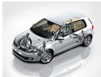
Die **adaptive Fahrwerksregelung DCC** stellt innerhalb von Millisekunden jeden Dämpfer individuell auf die Fahrbahn und die Fahrsituation ein. Per Knopfdruck entscheiden Sie, wie straff oder komfortabel das um zehn Millimeter tiefergelegte Fahrwerk abgestimmt sein soll. Dabei können Sie zwischen den drei Stufen **SPORT**, **NORMAL** und **COMFORT** wählen. In der Einstellung **SPORT** wird zusätzlich die Lenkungscharakteristik an eine sportliche Fahrweise angepasst.
