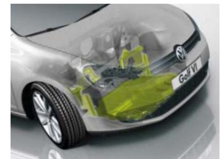
Die Marderschutzvorrichtung<sup>3)</sup> verhindert durch Bürsten in den vorderen Radhauskästen das Eindringen von Mardern in den Motorraum. Neben einem Unterbodenschutz bietet zudem ein spezielles Lochblech im Bereich der Abgasanlage Schutz vor Mardern.
