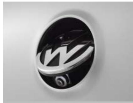
Die Rückfahrkamera „Rear Assist“ befindet sich hinter dem Volkswagen Logo am Heck und wird bei Einlegen des Rückwärtsganges ausgeklappt. So verschmutzt die Linse nicht und eine klare Bildwiedergabe ist gewährleistet.
