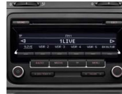
Das **Radio „RCD 310“** mit großem, zweifarbigen Display, Titelanzeige und AUX-IN-Buchse hat ein CD-Laufwerk, acht Lautsprecher sowie 4 x 20 Watt Ausgangsleistung. Es spielt MP3- und WMA-Dateien ab und verfügt über eine 2fach-Klangregelung.
