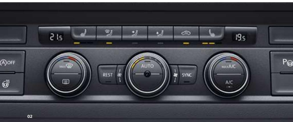
**02 Klimaanlage „Climatronic“.** Dieses System bietet eine 2/3-Zonen-Temperaturregelung für Fahrer, Beifahrer und Lade-/Fahrgastraum\*. Es erkennt die Stärke der Sonneneinstrahlung und die Außentemperatur und führt entsprechend mehr oder weniger kühle Luft zu. Die automatische Umluftschaltung, der Luftgütesensor, zusätzliche Luftausströmer in der Dachverkleidung\* und die optionale Zusatzheizung schaffen ein angenehmes Klima. | KA | KO |
