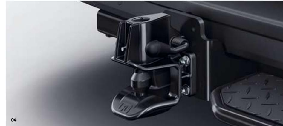
**Vorbereitung für Anhängerkupplung** (o. Abb.). Verschiedene Vorbereitungen für Anhängelasten bis 3,5 t sind erhältlich. | KA | KO | PR | FG |
