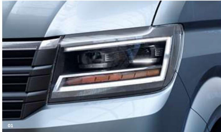
**01 LED-Frontscheinwerfer.** Tagfahr-, Ablend- und Fernlicht werden über energie-sparende LEDs erzeugt. Die hohe Betriebssicherheit und die lange Lebensdauer von LEDs erhöhen die Sicherheit durch die verringerte Ausfallwahrscheinlichkeit. | KA | KO | PR | FG |
