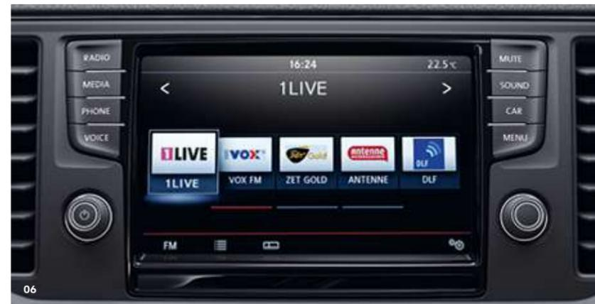
**06 Radiosystem „Composition Media“.** Das System umfasst ein 20,8 cm (8,0 Zoll) großes TFT-Farbdisplay, einen Touchscreen mit Annäherungssensoren, ein MP3- und WMA-fähiges CD-Laufwerk, 4 x 20 Watt Leistung mit vier Lautsprechern\*, einen SD-Kartenschacht, eine AUX-IN-Schnittstelle und eine USB-Schnittstelle in der Schalttafel, eine Bluetooth-Anbindung für Mobiltelefone sowie einen Doppeltuner mit PhasenDiversity für bestmöglichen Radioempfang. | KA | KO | PR | FG |
