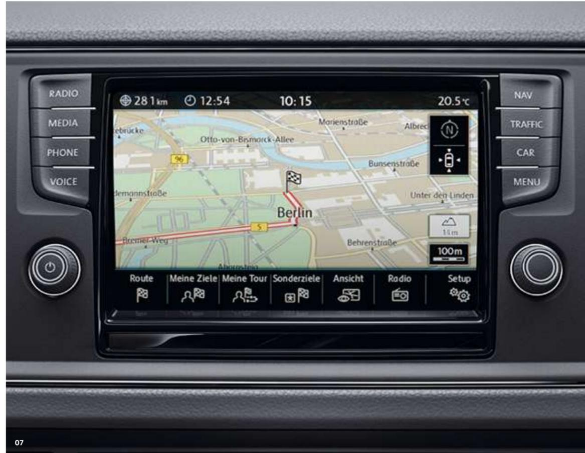
**07 Navigationssystem „Discover Media“.** Zusätzlich zu den Funktionen des Radiosystems „Composition Media“ ist ein zweiter SD-Kartenschacht integriert, der die SD-Karte mit dem Kartenmaterial aufnimmt. Für das installierte Kartenmaterial für Europa stehen mit Volkswagen MapCare kostenlose Aktualisierungen über die Volkswagen Homepage zur Verfügung. | KA | KO | PR | FG |
