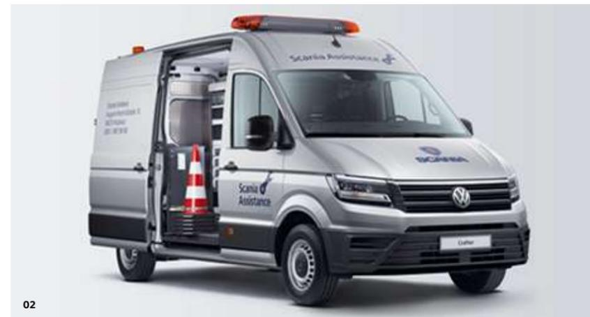
**02 Mobile Pannenhilfe.** Der große Laderaum im neuen Crafter mit Hochdach ist ideal zum Ausbau als mobile Werkstatt. Zur Ausstattung gehören eine Wärmeschutzverglasung, ein Bodenfach mit Alu-Schwenklappe, vier Schubladen, drei Regalwannen, eine Arbeitsplatte mit Schraubstock sowie eine gelbe Dachsignalanlage. Für optimale Arbeitsbedingungen im Laderaum sorgen die LED-Beleuchtung, eine 12-V-Steckdose und ein Dachlüfter.
