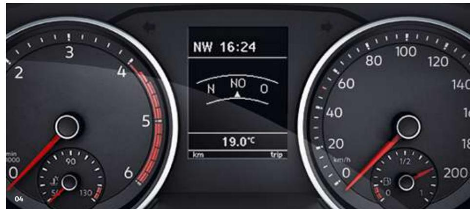
**03 Multifunktionsanzeige.** Der Bordcomputer zeigt aktuelle Informationen an, u. a. die zurückgelegten Kilometer, die Außentemperatur und den Durchschnittsverbrauch. | KA | KO | PR | FG |
