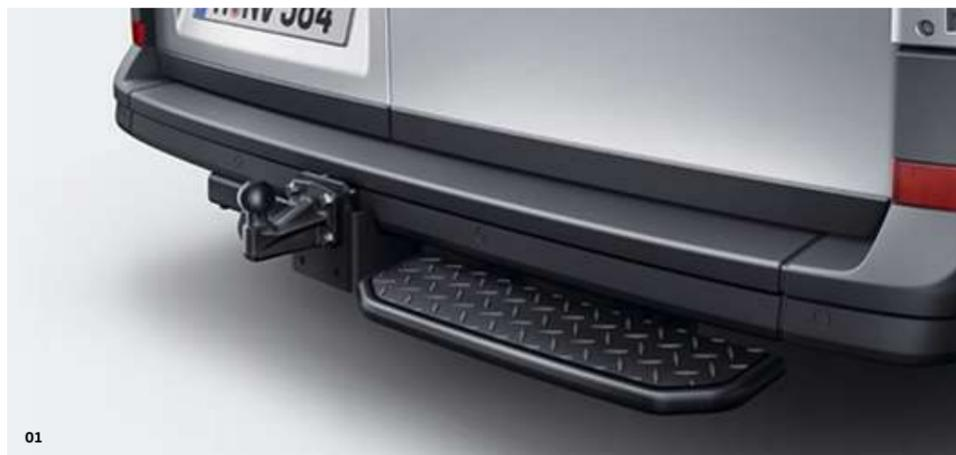
**01 Anhängerbock und die Trittstufe.** Der Anhängerbock ermöglicht das unkomplizierte Wechseln des Kugelkopfes und der Maulkupplung.<sup>1)</sup> Die optionale Trittstufe sorgt für ein noch bequemerer Ein- und Aussteigen.<sup>2)</sup> | KA | KO |
