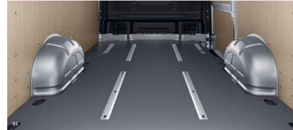
**01 Holzboden.**<sup>1), 2)</sup> Der 8 mm starke Holzboden im Laderaum bildet die optimale Standfläche für Ihre Ladung. Robustes Buchenholz sorgt für herausragende Stabilität und Langlebigkeit.
