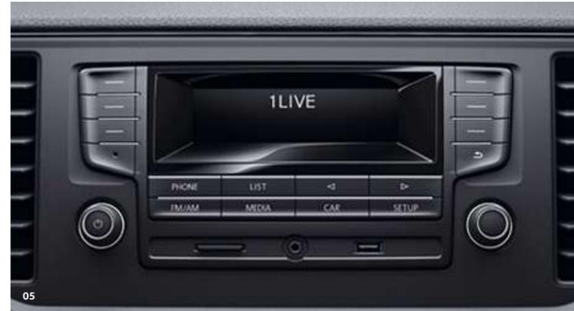
**05 Radiosystem „Composition Audio“.** Das System umfasst ein monochromes TFT-Display, 2 x 20 Watt Leistung mit zwei Lautsprechern\*, einen SD-Kartenschacht, eine AUX-IN-Schnittstelle und eine USB-Schnittstelle sowie eine Bluetooth-Anbindung für Mobiltelefone. | KA | KO | PR | FG |
