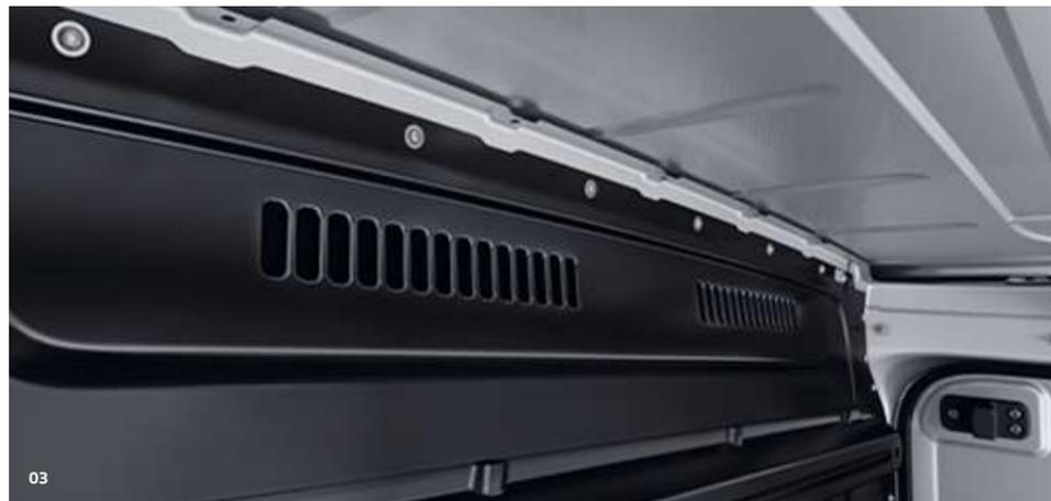
**03 Klimaanlage „Climatic“ mit zweitem Verdampfer.** Für die professionelle Beförderung von Personen oder temperatursensibler Ladung kann der Crafter auch im Lade-/Fahrgastraum klimatisiert werden. Der zweite Verdampfer ist im Fahrerhausdach integriert, die Ausströmer befinden sich oberhalb der Trennwand. | KA | KO |
