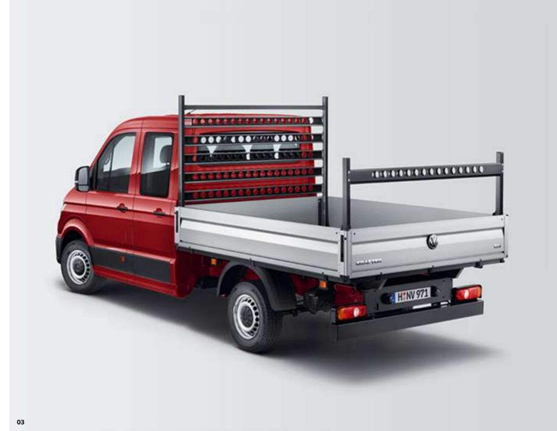
**03 Leiterträger.**<sup>2)</sup> Das feuerverzinkte Gestell ist vorn auf der Pritsche befestigt und dient dem sicheren Transport von Leitern und anderen langen Gegenständen. Auf Wunsch ist auch ein Leiterträger am hinteren Ende der Pritsche erhältlich. Sein Querträger lässt sich in Schritten von 115 mm auf drei verschiedenen Höhen fixieren.
