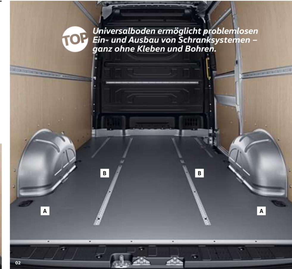
**02 Universalboden.**<sup>1), 2)</sup> Dieser Boden aus Holz ist die ideale Vorbereitung für die nachträgliche Montage von Regaleinbauten und Schranksystemen verschiedener Hersteller. Spezielle Adapter (A) ermöglichen in den Ausfräsungen die einfache Fixierung von Schrankeinbauten. Auf Wunsch sind für den Universalboden Verzurr-schienen (B) in Längs- und Querrichtung erhältlich.
