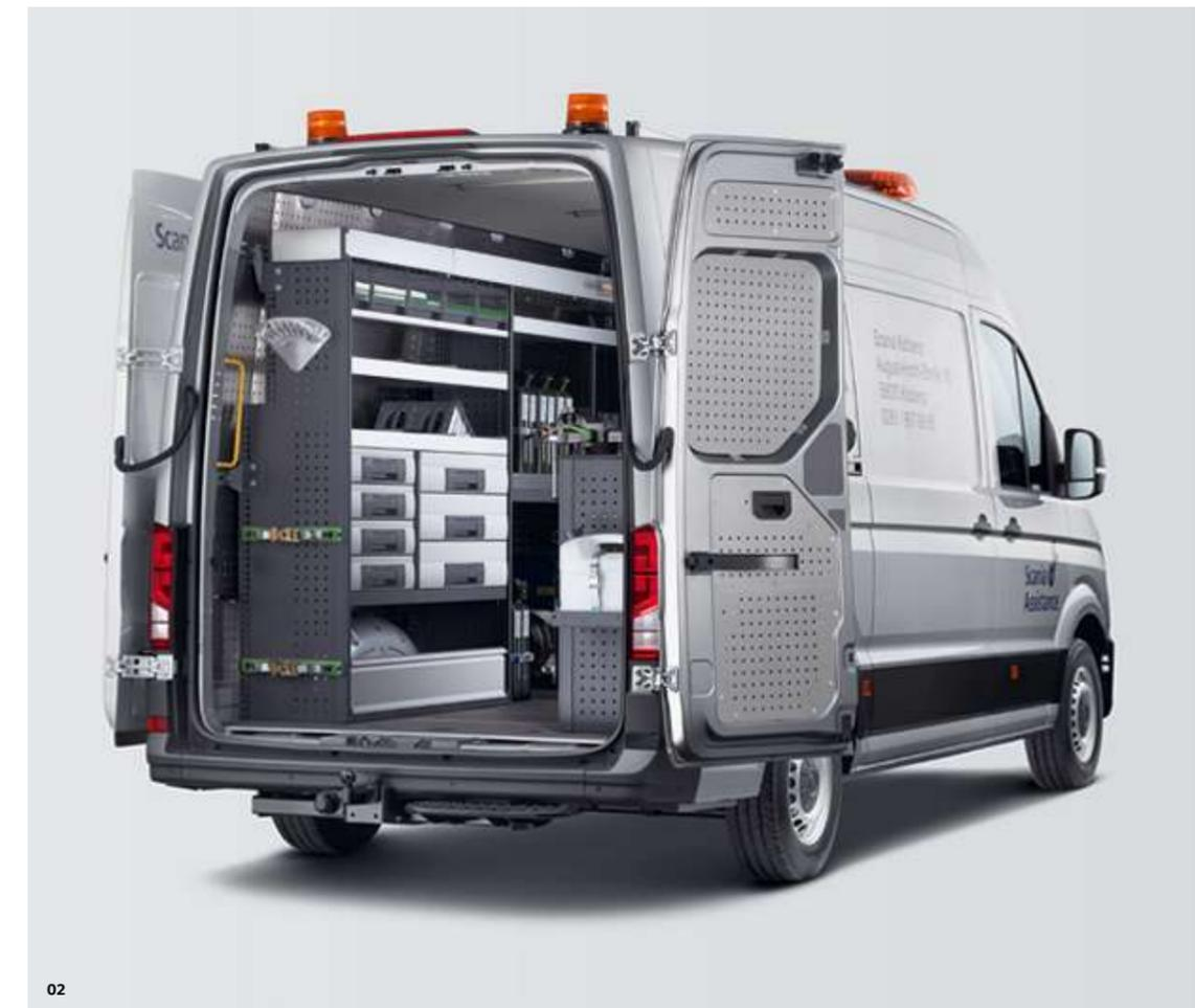
Den Einbau von Regaleinbauten erleichtern Sechskantlöcher für M6-Verschraubungen an den Innenwänden sowie der Universalboden. Optimale Befestigungs- und Belademöglichkeiten bieten Verzurrstreifen an allen Wänden, ein Dachinnenträger sowie die Überlademöglichkeit über dem Fahrerhaus. Optional ist zudem eine für Dauerbelastung optimierte Federung erhältlich.
