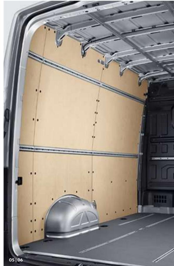
**05 Dachhohe Seitenverkleidung aus Sperrholz.\*** 5 mm dicke Sperrholzplatten machen diese Seitenverkleidung besonders stoßfest und widerstandsfähig.
