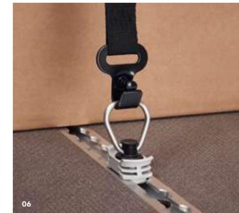
**06 Zurrgurttfitting.** Mithilfe des Zurrgurttfittings fixieren Sie das Transportgut stets fest im Laderaum. Die Befestigung erfolgt einfach an den Verzurrstreifen oder am Einzelverzurrpunkt der Spannstange. | KA | KO | PR | FG |
