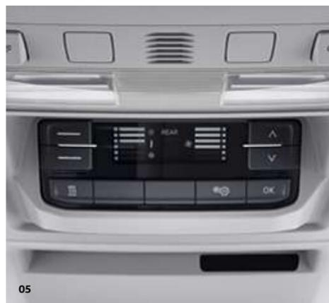
**Klimaanlage „Climatic“ mit zweitem Verdampfer und Dachinnenverkleidung** (o. Abb.). Für die professionelle Personenbeförderung kann der Crafter auch im Fahrgastraum klimatisiert werden. Die Ausströmer befinden sich im Dachhimmel, der zweite Verdampfer ist im Fahrerhausdach integriert. | KA | KO |
