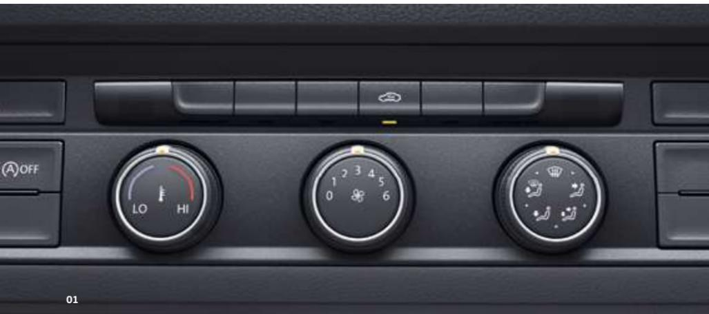
**01 Klimaanlage „Climatic“.** Die halbautomatische Klimaanlage verfügt über einen Innenraumsensor und gleicht die Raumtemperatur ständig mit dem gewünschten Wärmegrad im Fahrerhaus ab. | KA | KO | PR | FG |
