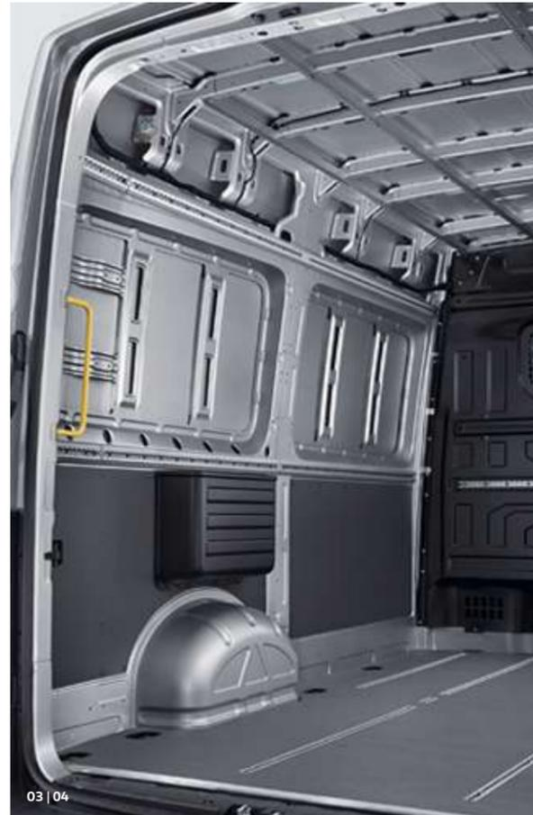
**03 Halbhohe Seitenverkleidung aus Kunststoff-Hohlkammerplatten.\*** Besonders robust ist die Verkleidung des Laderaums mit Kunststoff-Hohlkammerplatten. Sie werden vom Boden bis zur Brüstung montiert und sind besonders leicht zu reinigen.
