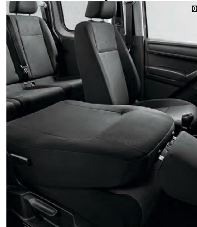
**01 Beifahrersitz mit klappbarer Lehne.**<sup>1)</sup> Für den Caddy Kombi ist auf Wunsch eine Durchladefunktion erhältlich. Klappt man die Rückenlehne des Beifahrersitzes komplett nach vorn, vergrößert sich die maximale Innenraumladelänge auf bis zu 3,01 m.<sup>2)</sup>
