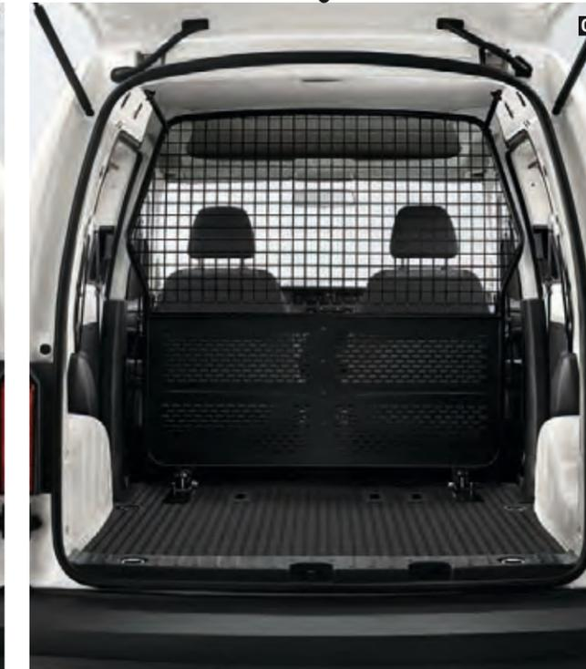
**03 Verstellbare Gittertrennwand.**<sup>1)</sup> Das robuste Gittergeflecht kann in zwei Positionen fixiert werden: hinter der zweiten Sitzreihe an der C-Säule oder hinter der nach vorn gewickelten zweiten Sitzreihe.
