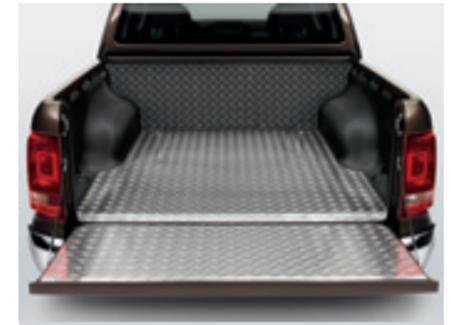
Die **Laderaumauskleidung aus Aluminium**. Die Bordstirnseite, die Ladefläche und die Heckklappe werden mit exakt zugeschnittenen Riffelblechen vor Kratzern geschützt, die Bordwandseiten mit passgenauen Kunststoffschalen.
