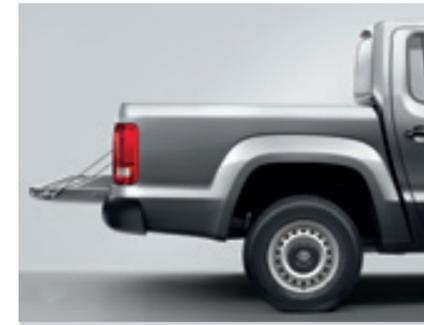
Die **Ladekantenhöhe und Ladebordwandhöhe**. Die Ladekantenhöhe ist mit 780 mm sehr niedrig, sodass ein leichtes Be- und Entladen möglich ist. Außergewöhnlich hoch ist die Bordwand mit 508 mm. So lässt sich auch Schüttgut transportieren.
