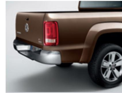
Der **Heckstoßfänger in Chrom**. Der Heckstoßfänger aus verchromtem Stahl verleiht dem Amarok ein noch markanteres Aussehen. Die integrierte Trittstufe erleichtert Ihnen zudem das Be- und Entladen der Ladefläche.
