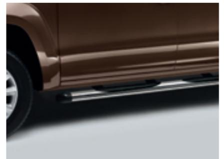
Die **Schwellerrohre mit Trittplätzen**. Diese Rohre aus glanzpoliertem Edelstahl geben dem Fahrzeug eine dynamisch-sportliche Note. Sie sind mit robusten Trittplätzen versehen und tragen 200 kg.
