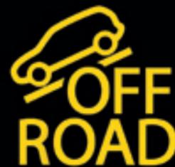
Das **Offroad-ABS**. Der Amarok ist zusätzlich zum herkömmlichen Antiblockiersystem auch mit einem Offroad-ABS ausgestattet, das speziell für den Fahrzeugeinsatz auf unbefestigten Wegen entwickelt wurde. Sobald die Funktion – per Tastendruck – aktiviert wird, vergrößert sich zum Beispiel das Bremsintervall. Die Räder blockieren kontrolliert, sodass der lose Fahrbahnbelag verschoben wird und sich Bremskeile vor den Rädern bilden. Das kann den Bremsweg wesentlich verkürzen.
