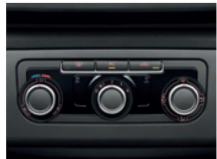
Die **Klimaanlage „Climatic“**. Sie verfügt über einen Innenraumsensor und gleicht ständig die Raumtemperatur mit dem gewünschten Wärmegrad ab. Gradzahl, Luftverteilung und Gebläsedrehzahl können individuell eingestellt werden.
