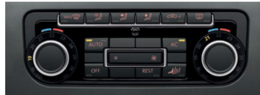
Die **Klimaanlage „Climatronic“**. Das System mit 2-Zonen-Temperaturregelung passt die Kühlung an Sonneneinstrahlung und Außentemperatur an. Die automatische Umluftschaltung und der Luftgütesensor schaffen ein angenehmes Klima.
