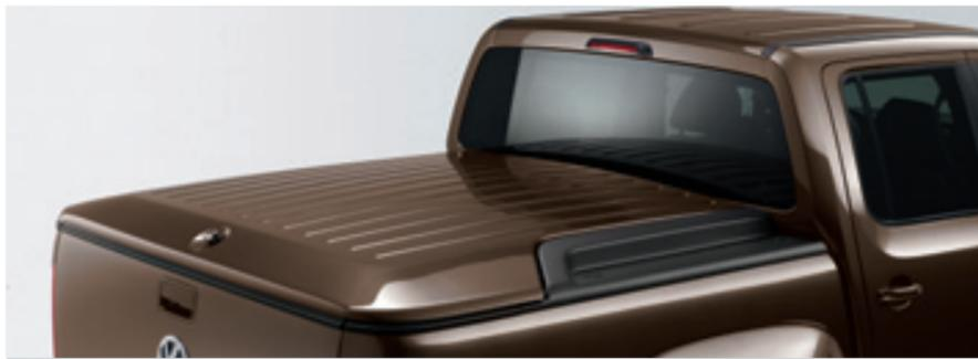
Die **Laderaumabdeckung aus Kunststoff**. Die abschließbare Laderaumklappe ist dank des Dichtungspaketes wind- und wetterfest. Mit Hilfe zweier Gasdruckfedern lässt sie sich leicht auf- und zuklappen. Zudem ist die Oberfläche in Wagenfarbe lackiert.
