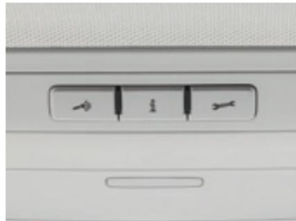
Die **Mobiltelefonvorbereitung**. In Verbindung mit den Radiosystemen „RCD 210“ und „RCD 310“ ist eine Mobiltelefonvorbereitung mit Bluetooth-Funktion, Mikrofon in der Dachkonsole und 3-Tasten-Modul zur Bedienung verfügbar.
