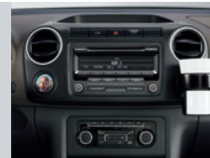
Das **Multifixierpunkt-Zubehör**. Im Bereich der Instrumententafel – optimal erreichbar und im Blickfeld des Fahrers – ist der Amarok mit zwei Multifixierpunkten ausgestattet. Hierfür sind viele praktische Produkte erhältlich: ein Becherhalter, ein Bildhalter, eine Zettelklemme oder ein Magnethalter zur Befestigung metallischer Gegenstände. Für die Grundversion kann die Aufnahme für den Multifixierpunkt nachgerüstet werden.
