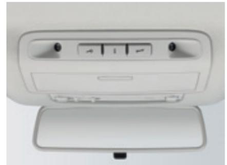
Die **Diebstahlwarnanlage**<sup>4)</sup>. Neben der Innenraumüberwachung umfasst die Ausstattung eine elektronische Wegfahrsperre, ein Back-up-Horn als akustische Warnanlage sowie einen Öffnungsschutz für den Tankdeckel, die Türen und die Motorhaube.
