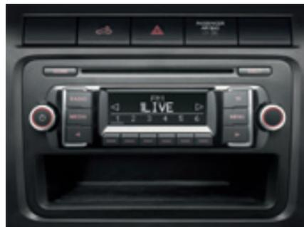
Das **Radiosystem „RCD 210“**. Das Radio verfügt über eine RDS-Senderanzeige, einen MP3-geeigneten CD-Player, eine Schnittstelle für die Mobiltelefonvorbereitung und zwei bzw. vier Lautsprecher à 20 Watt.
