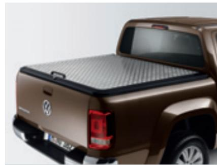
Die **Laderaumabdeckung aus Aluminium**. Diese abschließbare Abdeckung aus geriffeltem Metall schützt die Ladefläche dank des Dichtungspaketes zuverlässig vor Regen und Schnee. Sie lässt sich leicht auf- und zuklappen.
