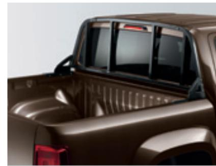
Das **Heckscheibengitter**. Zum Schutz vor Ladegutschlägen. Das Gitter wird auf der Laderaumkante montiert.
