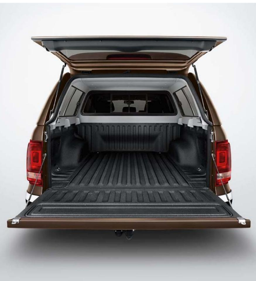
Das **Hardtop**. Es verfügt über eine Heckklappe mit großem Glaseinsatz und Gasdruckfedern sowie über ein Bugschiebefenster und seitliche Schiebefenster, die von innen verriegelt werden können. Dank des serienmäßigen Dichtungspaketes ist der Innenraum vor Staub und Regen geschützt. Des Weiteren ist das in Wagenfarbe lackierte Hardtop von innen verkleidet und mit einer Heckscheibenheizung sowie einer grünen Wärmeschutzverglasung ausgestattet.
