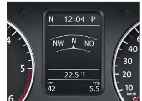
Die Multifunktionsanzeige „Plus“. Sie zeigt aktuelle Informationen, u. a. die verbleibende Reichweite, die Außentemperatur und den Durchschnittsverbrauch, an. Zudem ist u. a. eine Navigationsfunktion und eine Türüberwachung integriert.
