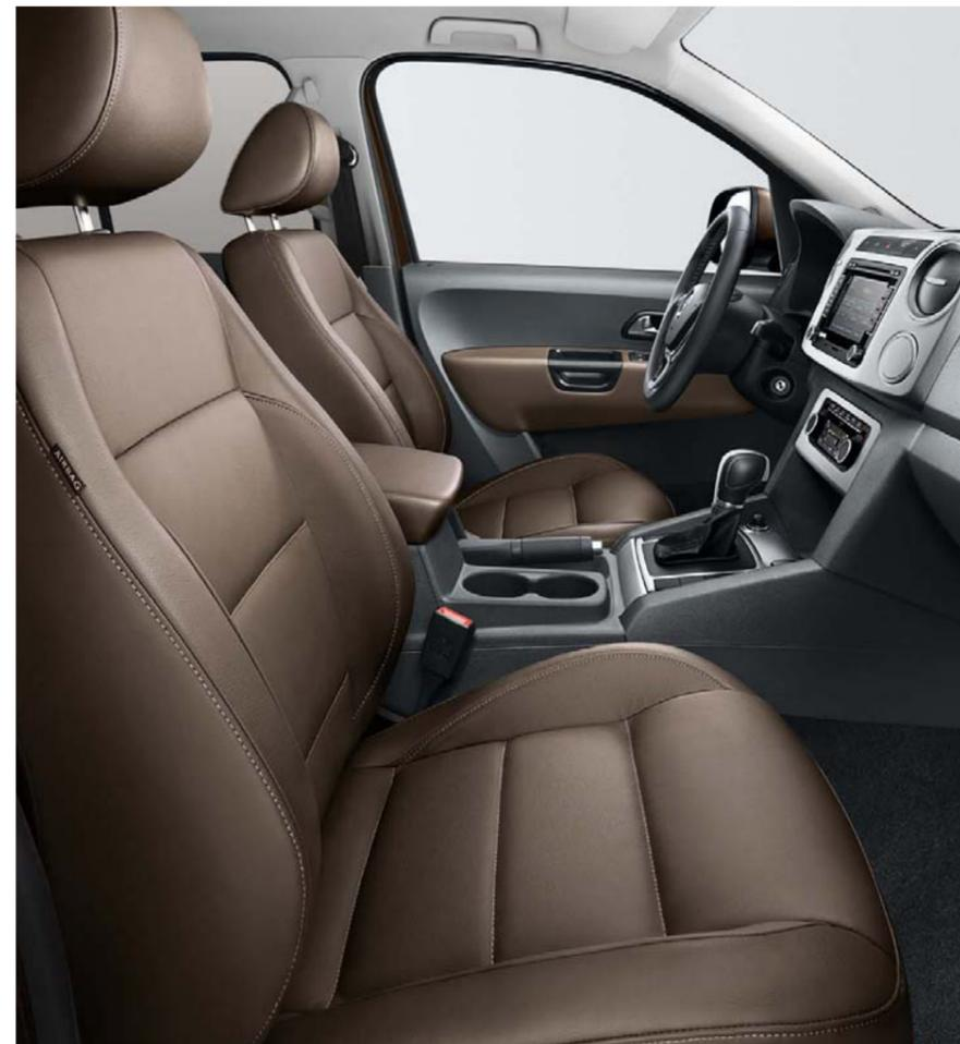
Der Fahrer- und der Beifahrerplatz. Die beiden ergonomischen Sitze können individuell eingestellt, auf Wunsch beheizt und optional mit einer Lendenwirbelstütze ausgestattet werden. In der Mittelkonsole stehen zwei Becherhalter zur Verfügung. Weitere Ablagemöglichkeiten befinden sich in den Ausstattungslinien Trendline und Highline unter den Sitzen. Zum Schutz des Fahrers und des Beifahrers gibt es einen Fahrer- und einen Beifahrerairbag sowie zwei Kopf-Thorax-Airbags.
