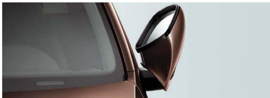
Die **elektrisch anklappbaren Außenspiegel**.<sup>2)</sup> Für den Amarok sind elektrisch verstell- und beheizbare Außenspiegel mit integrierter Antenne optional erhältlich, im Amarok Trendline und im Amarok Highline sind sie bereits Serie. Noch mehr Komfort bieten die elektrisch anklappbaren Seitenspiegel. Mit Hilfe eines Drehreglers kann die Fahrzeugbreite einfach um ca. 17 cm reduziert werden.
