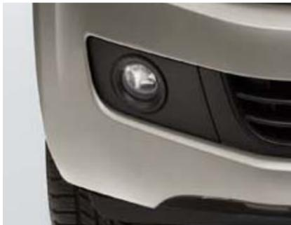
Die **Nebelscheinwerfer**. Sie sind in den Stoßfänger integriert und sorgen bei schlechter Witterung für optimale Sicht.
