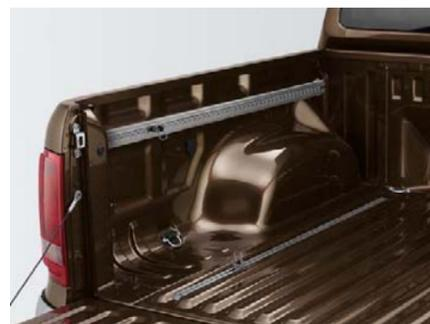
Das **Schienensystem**.<sup>2)</sup> Es ist mit zwei Schienenprofilen auf der Ladefläche oder mit vier, zwei auf der Ladefläche und zwei an den Seitenbordwänden, erhältlich. Beide Systeme können mit der Laderaumbeschichtung kombiniert werden.
