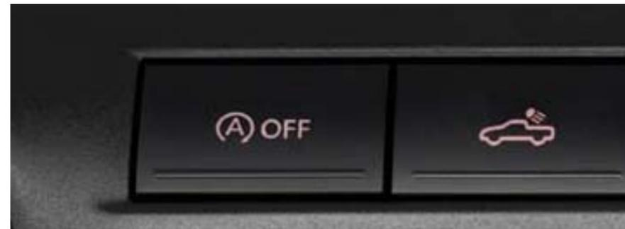
Das **Start-Stopp-System**. Das Start-Stopp-System steht für sparsames und schadstoffarmes Fahren. Beim Halten im Stau oder an einer Ampel reicht es, die Kupplung zu lösen und den Gang herauszunehmen, und der Motor schaltet sich aus. Zum Weiterfahren kuppeln Sie einfach wieder ein. Beim 8-Gang-Automatikgetriebe lassen Sie im Stand den Fuß auf der Bremse und der Motor schaltet ab. Nach Lösen der Bremse schaltet sich der Motor automatisch wieder ein.
