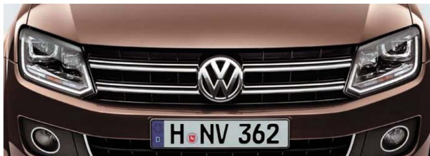
Das **Xenon Design Paket**. Es umfasst eine Doppelchromleiste am Kühlergrill, Bi-Xenon-Scheinwerfer mit LED-Tagfahrlicht sowie abgedunkelte Rückleuchten und eine LED-Kennzeichenbeleuchtung.
