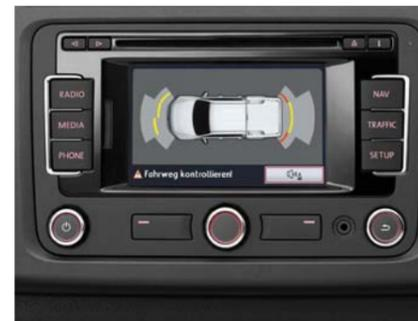
Der ParkPilot. Warntöne signalisieren dem Fahrer im Rahmen der Grenzen des Systems, wie groß beim Einparken die Distanz zum Hindernis ist. Zusätzlich zum akustischen Hinweis zeigt das Display des Radiosystems „RCD 310“ oder der Radio-Navigationssysteme „RNS 315“ und „RNS 510“ den Abstand hinter dem Fahrzeug optisch an. Beim Amarok Trendline und Amarok Highline wird zusätzlich der Abstand vor dem Fahrzeug angezeigt.
