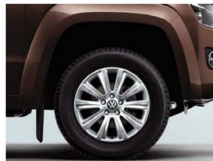
Die **Leichtmetallräder „Durban“** 7½ J x 18 in Silber, inklusive Radlaufverbreiterungen. Mit Reifen 255/60 R 18. Diese Leichtmetallräder sind nur in Verbindung mit der Doppelchromleiste erhältlich.
