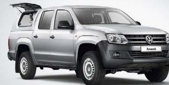
Der Amarok erfüllt eine Vielzahl individueller Anforderungen. Hierzu kann das Fahrzeug mit den Lösungen diverser Aufbauhersteller kombiniert werden. Der robuste Leiterrahmen verfügt über standardisierte Befestigungspunkte, die eine nachträgliche Montage erleichtern. Über die elektrische Schnittstelle können u. a. Kranaufbauten, Kennleuchten, Seilwinden und Hydraulikaggregate angesprochen werden. Zudem sind alle drei Ausstattungsvarianten auch ohne Ladefläche bestellbar.
