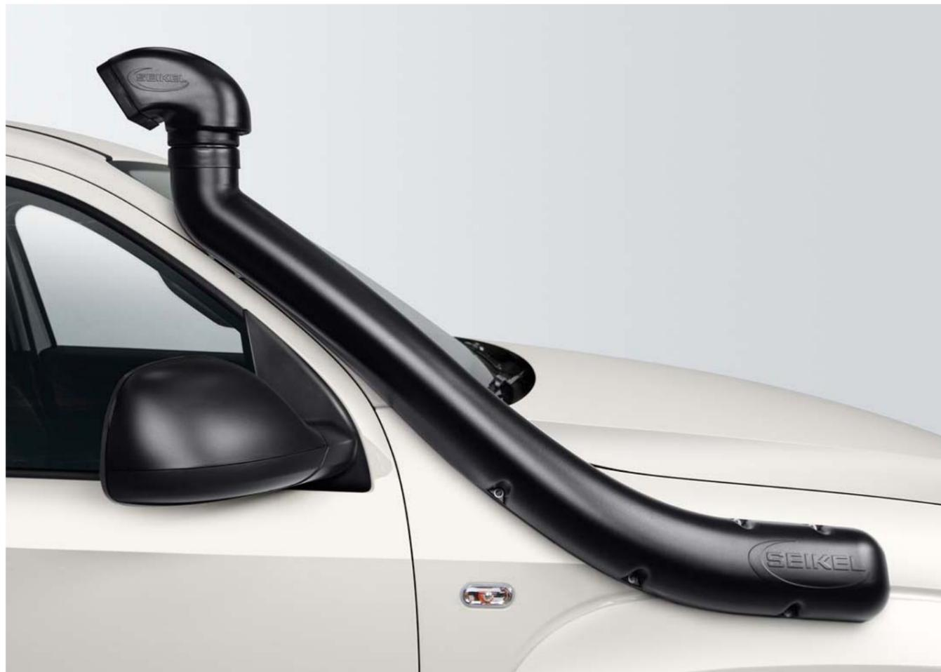
Der **Snorkel**.<sup>2)</sup> Er ist wahlweise aus Polyethylen oder aus leichter Carbonfaser gefertigt und wird am Amarok entlang der A-Säule befestigt. Er schützt den Motor vor dem Eindringen von Staub und Wasser während einer Offroad-Fahrt. Die vorgeschriebene Wattiefe darf hierbei nicht überschritten werden. Volkswagen Nutzfahrzeuge empfiehlt die Anbringung des Snorkels, wenn Sie häufig auf staubigen Straßen unterwegs sind, da seine Verbrennungsluftansaugung hochgelegt positioniert ist.
