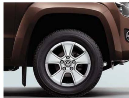
Die **Leichtmetallräder „Amazonit“** 6½ J x 16. Mit profilstarken All-Terrain-Reifen<sup>1)</sup> 245/70 R 16. Nur in Verbindung mit den Offroad-Paketen als Beipack erhältlich.
