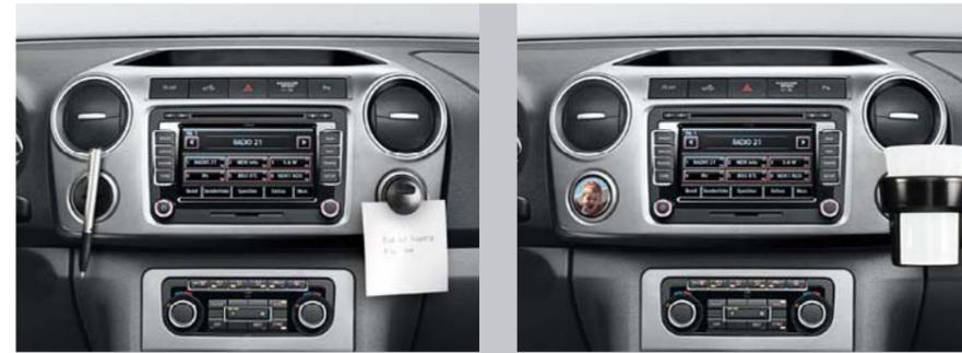
Das Multifixierpunkt-Zubehör. Die beiden Multifixierpunkte befinden sich unter den beiden mittleren Luftausströmern und sind für Fahrer und Beifahrer jederzeit gut erreichbar. Ein Becherhalter, ein Bildhalter, eine Zettelklemme und ein Magnethalter für metallische Gegenstände werden bereits mitgeliefert. Sie alle lassen sich schnell an den Multifixierpunkten befestigen.
