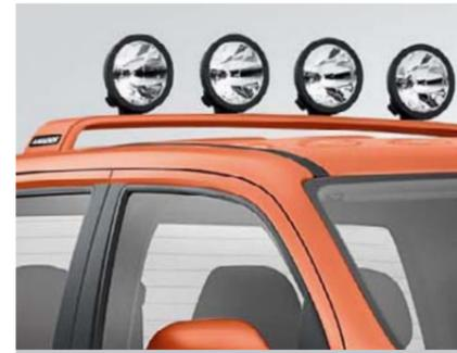
Der **Lampenbügel**. Auf Wunsch ist ein in Wagenfarbe lackierter Lampenbügel mit vier Rundscheinwerfern erhältlich. Diese übernehmen die Fernlichtfunktion der Frontscheinwerfer.
