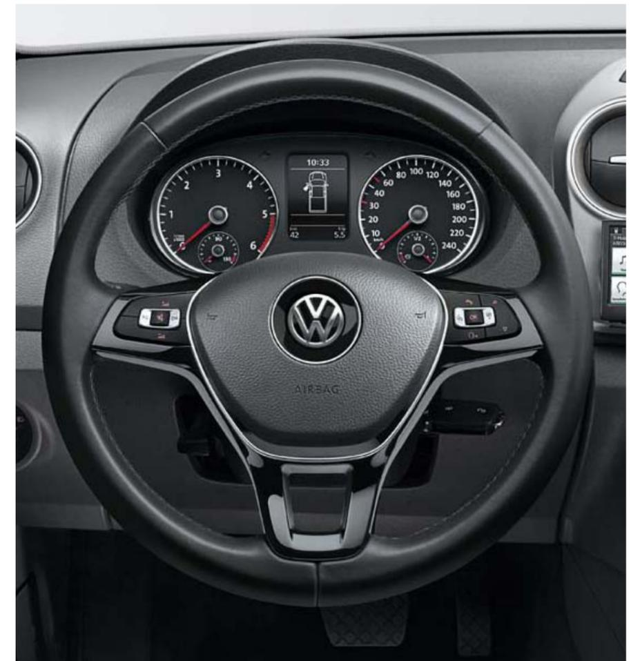
Das Multifunktions-Lederlenkrad. Es ist mit schwarzem Klavierlack über- und mit feinem Leder bezogen und bietet viele Funktionen, die das Fahren noch entspannter und angenehmer machen. So lassen sich zum Beispiel über die Bedientasten alle erhältlichen Radio- und Navigationssysteme sowie die Telefonfreisprechanlage wahlweise mit links oder mit rechts bedienen.
