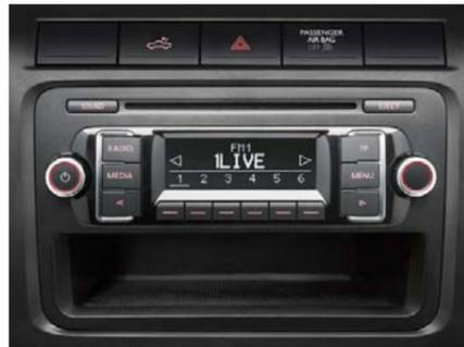
Das Radiosystem „RCD 210“. Das Radio verfügt über eine RDS-Senderanzeige, einen MP3-gerechten CD-Player, eine Schnittstelle für die Mobiltelefonvorbereitung und zwei Lautsprecher à 20 Watt.
