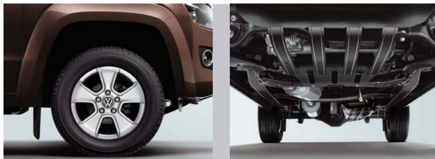
Das **Offroad-Paket I**. Für mehr Sicherheit im Gelände steht ein Offroad-Paket zur Verfügung. Es umfasst jeweils einen Unterfahrschutz für das Getriebe sowie eine 245/70-A/T-Geländebereifung<sup>1)</sup> auf 16-Zoll-Leichtmetallrädern „Amazonit“. Das Paket ist mit allen verfügbaren Antriebsvarianten kombinierbar.
