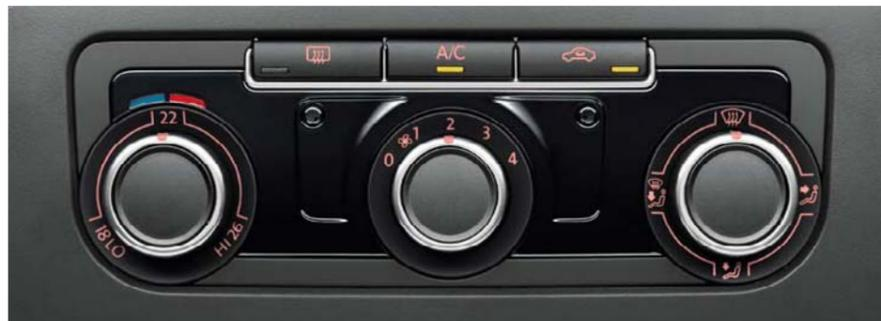
Die Klimaanlage „Climatic“. Sie verfügt über einen Innenraumsensor und gleicht ständig die Raumtemperatur mit dem gewünschten Wärmegrad ab. Gradzahl, Luftverteilung und Gebläsedrehzahl können individuell eingestellt werden.
