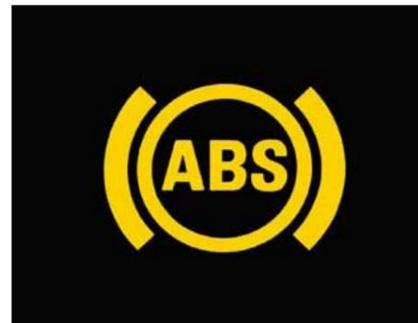
Das **Antiblockiersystem (ABS)**. Droht ein Rad beim Bremsen zu blockieren, greift das System sofort ein und reduziert kontrolliert den Bremsdruck. So hilft es, den Amarok auch bei einer Vollbremsung lenkbar zu halten.
