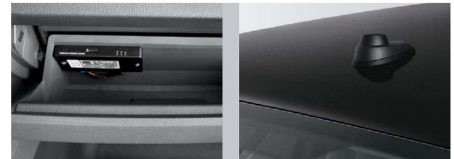
Der **drahtlose Internetzugang**.<sup>2)</sup> Für alle, die häufig mit einem Notebook oder einem Tablet unterwegs sind. Das Set besteht aus einer Dachantenne und einem WLAN-Router und bietet Ihnen einen schnellen und bequemen Internetzugriff inklusive GPS-Ortungssystem.
