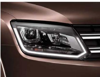
Die **Bi-Xenon-Scheinwerfer**. Sowohl das Abblend- als auch das Fernlicht werden über die Bi-Xenon-Scheinwerfer erzeugt. Dadurch erweitert sich das Sichtfeld und erhöht sich die Sicherheit. Das elegante LED-Lichtband übernimmt das Tagfahrlicht.
