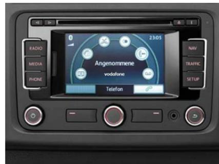
Die Mobiltelefonfreisprecheinrichtung. In Verbindung mit allen Radio- und Radio-Navigationssystemen ist eine Mobiltelefonfreisprecheinrichtung mit Bluetooth-Funktion und Mikrofon in der Dachkonsole verfügbar.
