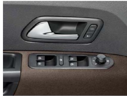
Das „Comfort & Function Paket“. Mit einem einfachen Tastendruck können Sie die Fenster und die beheizbaren Außenspiegel elektrisch bedienen. Zusätzlich umfasst dieses Paket eine Zentralverriegelung mit Funkfernbedienung.
