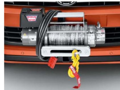
Die **Seilwinde**.<sup>2)</sup> Sie kann entweder an der Fahrzeugfront oder auf der Ladefläche befestigt werden. Die robuste Seilwinde ist mit einem 30-m-Kunststoffseil ausgestattet und besitzt, an der Fahrzeugfront angebracht, eine maximale Zugkraft von 3,6 t.
