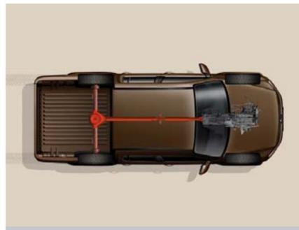
Der **Hinterradantrieb**. Über eine Kardanwelle wird die gesamte Antriebskraft auf die Hinterachse übertragen. Dies ermöglicht ein komfortables Handling. Der 4x2-Antrieb ist ausgelegt für Straßen und Wege.
