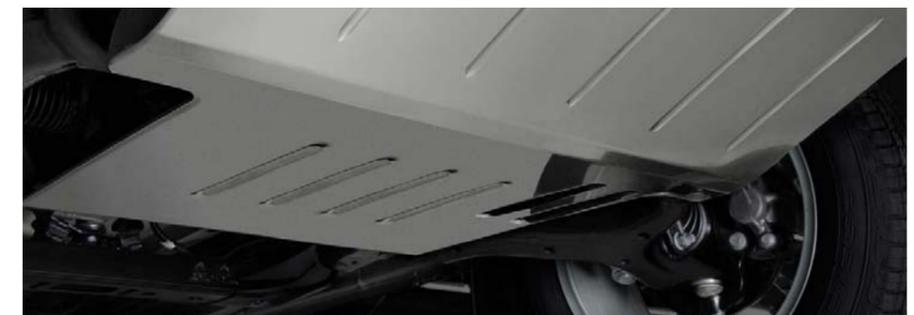
Der **Motorunterfahrerschutz „Field & Forest“**.<sup>2)</sup> Dieser geschlossene Unterfahrerschutz aus 5 mm dickem Aluminium ist als Rutsche ausgelegt und zusätzlich mit Verstärkungsrippen versehen. Er schützt den Motor, das Vorderachs-Differenzialgehäuse und die Anlenkpunkte der unteren Querlenker. Seine Konstruktionsweise orientiert sich speziell an den Anforderungen in forst- und landwirtschaftlichen Betrieben.
