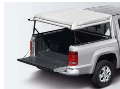
Der **Aufsatz mit Plane und Spriegel**.<sup>2)</sup> Die verzinkten Vierkant-Stahlrohre sind fest mit den Seitenbordwänden und der Rückwand des Fahrerhauses verbunden. Über den Spriegel ist eine hochwertige Plane gespannt, die sich an drei Seiten öffnen lässt.
