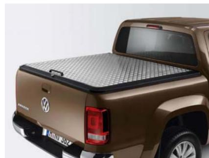
Die **Laderaumabdeckung aus Aluminium**. Diese abschließbare Abdeckung aus geriffeltem Aluminium schützt die La-defläche dank des Dichtungspakets vor Staub und Regen. Sie kann bei Bedarf leicht abgenommen werden.
