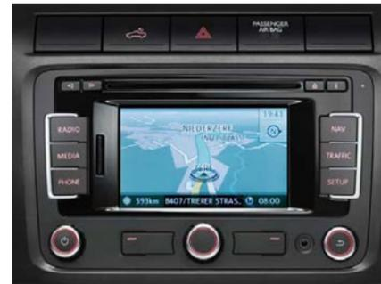
Die Navigationsfunktion „RNS 315“ für das Radio „RCD 310“. Sie bietet einen Farbtouchscreen, eine Bluetooth-fähige Freisprecheinrichtung, einen 4-GB-Flash-Speicher, einen SD-Card-Slot, sechs Lautsprecher u. v. m.
