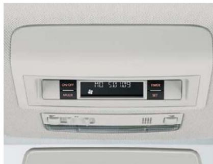
Die Wasserzusatzheizung. Für die Amarok Modelle ist in Verbindung mit der Klimaanlage „Climatronic“ auf Wunsch eine Wasserzusatzheizung erhältlich. Sie erlaubt ein Vorwärmen des Motors und sorgt gleichzeitig dafür, dass es im Innenraum schneller warm wird bzw. dieser ebenfalls bereits vorgewärmt ist. Die Bedieneinheit ist leicht erreichbar in die Dachkonsole integriert, die Wasserzusatzheizung kann jedoch auch mit Hilfe der Fernbedienung an- und eingestellt werden.
