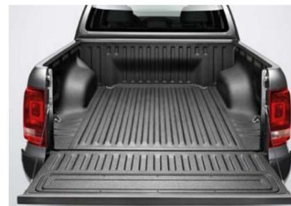
Die **Laderaumbeschichtung**. Die anthrazitfarbene UV-beständige Spezialbeschichtung schützt den Laderaum vor mechanischen und chemischen Gebrauchsspuren.
