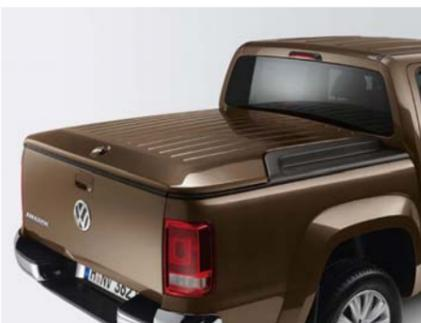
Die **Laderaumabdeckung aus Kunststoff**. Die in Wagenfarbe lackierte, abschließbare Abdeckung schützt die La-defläche dank des Dichtungspakets vor Staub und Regen. Sie ist auf Wunsch mit einem Exterieurpaket kombinierbar.
