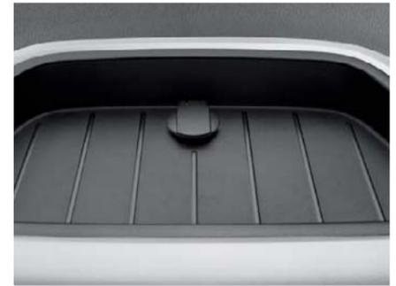
Die 12-Volt-Steckdose. Sie befindet sich auf der Instrumententafel und ermöglicht beispielsweise das Laden eines mobilen Navigationsgeräts.
