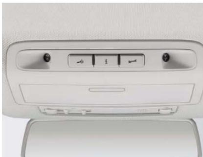
Die **Diebstahlwarnanlage**. Neben der Innenraumüberwachung umfasst die Ausstattung eine elektronische Wegfahrsperrung, eine akustische Warnanlage, einen deaktivierbaren Safelock sowie einen Abschleppschutz.
