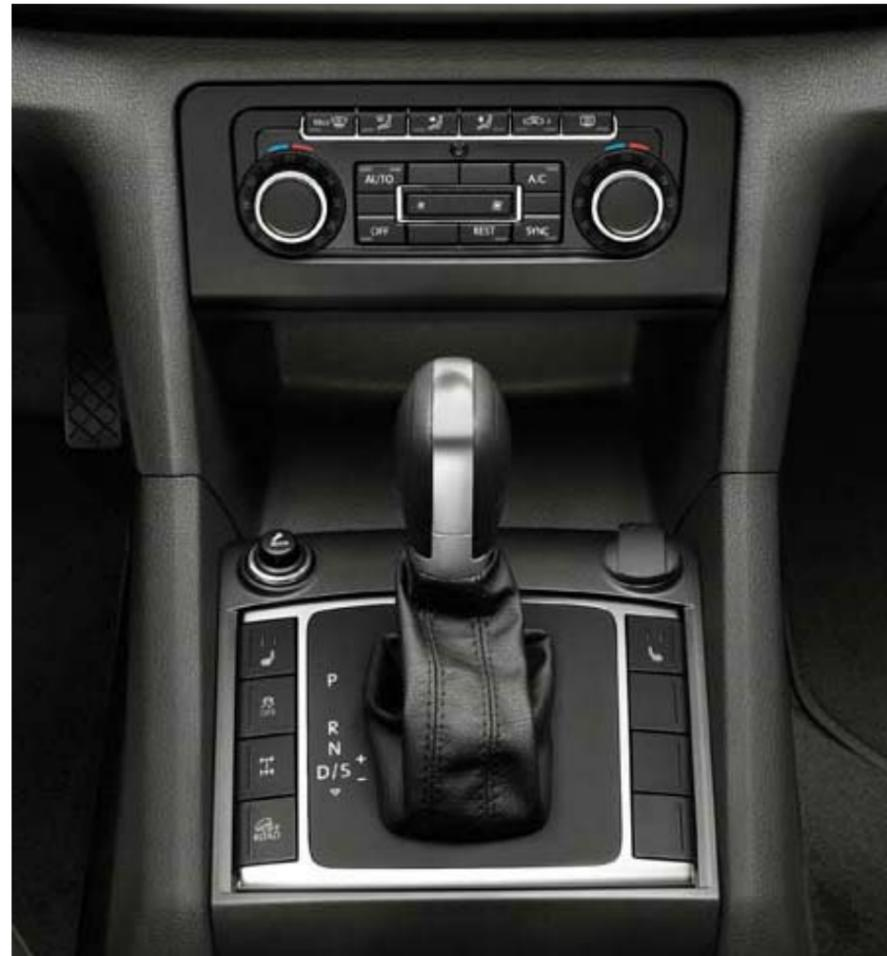
Das **8-Gang-Automatikgetriebe**. Es ist für den 132-kW-Motor<sup>1)</sup> erhältlich und kann sowohl mit dem permanenten Allradantrieb 4MOTION als auch mit dem Hinterradantrieb kombiniert werden. Der erste Gang ist für den Geländeeinsatz und das Anfahren im Hängerbetrieb optimiert. Dadurch wird ein zusätzliches Untersetzungsgetriebe überflüssig. Der achte Gang hingegen verfügt über eine längere Übersetzung und ist für kraftstoffsparende Fahrten im niedrigen Drehzahlbereich konzipiert.
