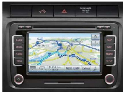
Das Radio-Navigationssystem „RNS 510“. Es besitzt einen 16-cm-Farbtouchscreen, eine 30-GB-Festplatte, einen SD-Card-Slot und einen MP3-fähigen CD-Player. In Kombination mit dem Multifunktions-Lederlenkrad ist Sprachsteuerung möglich.
