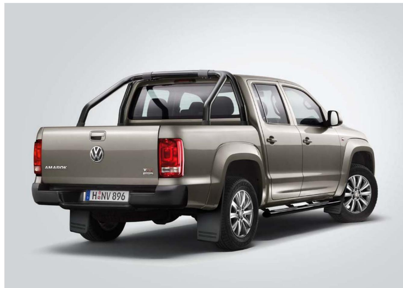
Das **Exterieurpaket in Schwarz**. Dieses Paket macht den Amarok noch eine Spur markanter. Die StylingBar aus Stahl hat einen Rohrdurchmesser von 76 mm und ist schwarz pulverbeschichtet. Schwarze Schwellerrohre mit Trittflächen runden den Auftritt ab. Das Paket ist auf Wunsch auch ohne StylingBar erhältlich.
