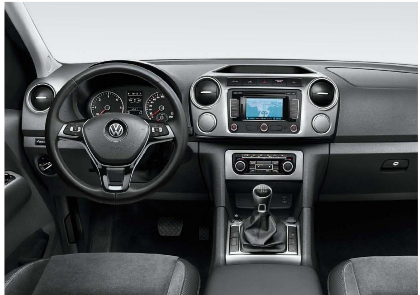
Das Interieur. Die ergonomisch geformten Sitze sind mit hochwertigem „Alcantara“ in Anthrazit/Titanschwarz bezogen, das Multifunktions-Lederlenkrad ist mit Klavierlack veredelt. Über die Schaltasten des Lenkrads haben Sie direkten Zugriff auf die Multifunktionsanzeige „Plus“, die Mobiltelefonvorbereitung und das Radiosystem mit Navigationsfunktion „RNS 315“. Beim Rückwärtseinparken unterstützt Sie die Rückfahrkamera „Rear Assist“.
