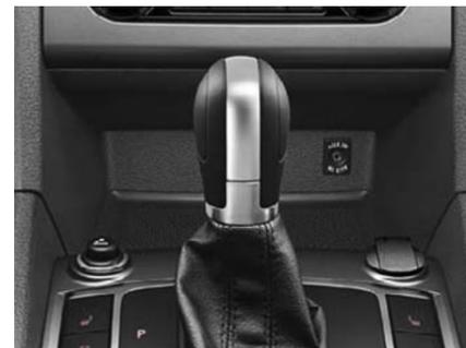
Die AUX-IN-Schnittstelle. An diese können externe Audioquellen, z. B. ein MP3-Player, angeschlossen werden. Die Bedienung erfolgt über das jeweils angeschlossene Gerät. Beim „RNS 315“ und „RNS 510“ ist die AUX-IN-Schnittstelle serienmäßig.
