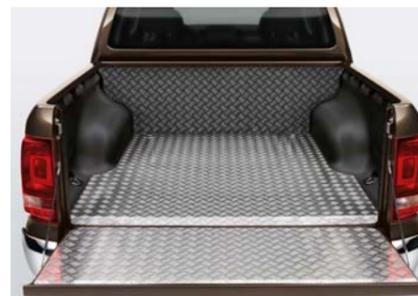
Die **Laderaumauskleidung aus Aluminium**. Die Bordstirnseite, die Ladefläche und die Ladeklappe werden mit exakt zugeschnittenen Riffelblechen vor Kratzern geschützt, die Bordwandseiten mit passgenauen Kunststoffschalen.
