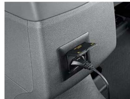
Der **230-V-Wechselrichter**.<sup>2)</sup> Er wandelt den im Fahrzeug generierten Gleichstrom in 230-V-Wechselstrom (max. 150 W) um. Über die handelsübliche Eurosteckdose können z. B. Notebooks betrieben oder Mobiltelefone aufgeladen werden.
