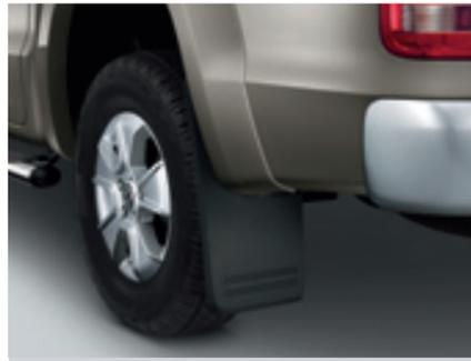
Die **Schmutzfänger vorn und hinten**. Sie sind aus Kunststoff gefertigt, an der Innenseite der Radkästen befestigt und schützen Ihr eigenes und die folgenden Fahrzeuge vor hochschleuderndem Schmutz und Steinen.
