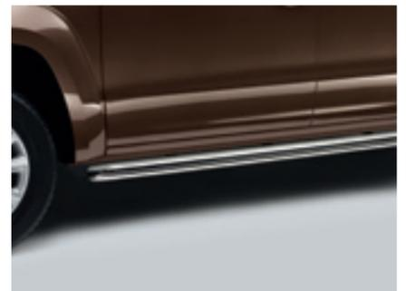
Die Schwellerrohre. Glanzpolierter Edelstahl schafft eine sportlich-edle Anmutung. Die Rohre mit einem Durchmesser von 76 mm werden ohne zusätzliches Bohren mit je drei Haltern an den serienmäßigen Befestigungspunkten montiert.
