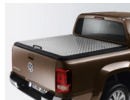
Die Laderaumabdeckung aus Aluminium. Diese abschließbare Abdeckung aus geriffeltem Metall schützt die Ladefläche zuverlässig vor Regen und Schnee. Dank zweier Gasdruckfedern lässt sie sich leicht auf- und zuklappen.
