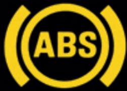
Das **Antiblockiersystem (ABS)**. Droht ein Rad beim Bremsen zu blockieren, greift das System sofort ein und reduziert kontrolliert den Bremsdruck. So hilft es, den Amarok auch bei einer Vollbremsung lenkbar zu halten.
