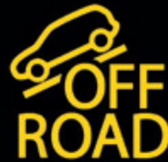
Das **Offroad-ABS**. Zusätzlich zum serienmäßigen Antiblockiersystem ist für den Amarok ein Offroad-ABS erhältlich, speziell entwickelt für den Fahrzeu-einsatz auf unbefestigten Wegen. Sobald die Funktion – per Tastendruck – akti-viert wird, vergrößert sich zum Beispiel das Bremsintervall. Die Räder blockieren kontrolliert, sodass der lose Fahrbahn-belag verschoben wird und sich Brems-keile vor den Rädern bilden. Das kann den Bremsweg wesentlich verkürzen.
