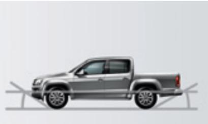
Der **Böschungswinkel und die Wattiefe**. Der Amarok trotzt steilen Hügeln ebenso wie kleinen Furten. So beeindruckt der Amarok mit einem Böschungswinkel von 28° vorn und 23,6° hinten (28° hinten ohne Stoßfänger) sowie einer Wattiefe von bis zu 500 mm.
