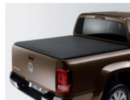
Die Laderaumabdeckplane. Sie lässt sich mit wenigen Handgriffen an Schnellspannhalterungen fixieren. Drei Querträger sorgen für hohe Stabilität. Die schwarze Plane ist reißfest, wasserabweisend und aufrollbar.
