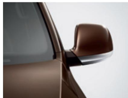
Die elektrischen Außenspiegel. Sie sind beheizbar und mit einer integrierten Antenne ausgestattet. So haben Sie nicht nur klare Sicht, sondern auch einen klaren Radioempfang.
