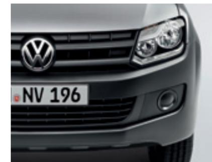
Der Frontstoßfänger mit schwarzer Narbung. Er ist besonders robust und unempfindlich. Auf Wunsch kann der Frontstoßfänger in Wagenfarbe lackiert werden.
