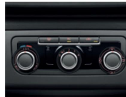
Die **Klimaanlage „Climatic“**. Sie ver-fügt über einen Innenraumsensor und gleicht ständig die Raumtemperatur mit dem gewünschten Wärmegrad ab. Gradzahl, Luftverteilung und Gebläse-drehzahl können individuell eingestellt werden.
