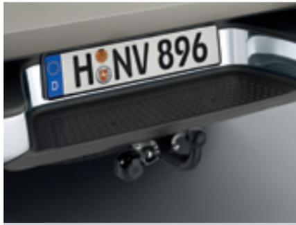
Die **Anhängevorrichtung**. Sie ist mit einer Anhängelast von bis zu 2.800 kg bei 12 % Steigung so robust wie der Amarok selbst.
