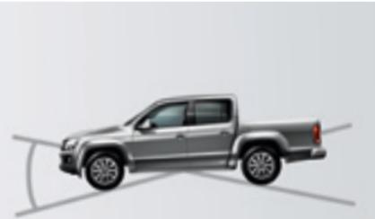
Der **Rampenwinkel**. Der Amarok bringt Sie gut über Stock und Stein. Und über alles, was deutlich größer ist. Bei einem Rampenwinkel von 23°<sup>2)</sup> sind selbst Baumstämme und Felsen kein Hindernis mehr.
