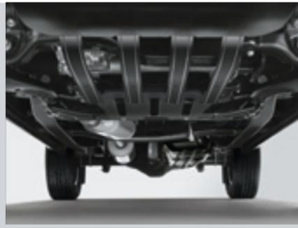
Das **Offroad-Paket I**. Damit Sie auf Feldwegen und im Gelände noch sicherer unterwegs sind, lässt sich der Amarok mit einem robusten Offroad-Paket ausstatten. Es umfasst einen Unterfahrschutz für den Motor und das Getriebe sowie eine 245/70 A/T-Geländebereifung auf 16"-Leichtmetallrädern „Amazonit“. Dieses Paket ist für den Amarok mit Hinterradantrieb sowie den Amarok mit permanentem 4MOTION Antrieb erhältlich.
