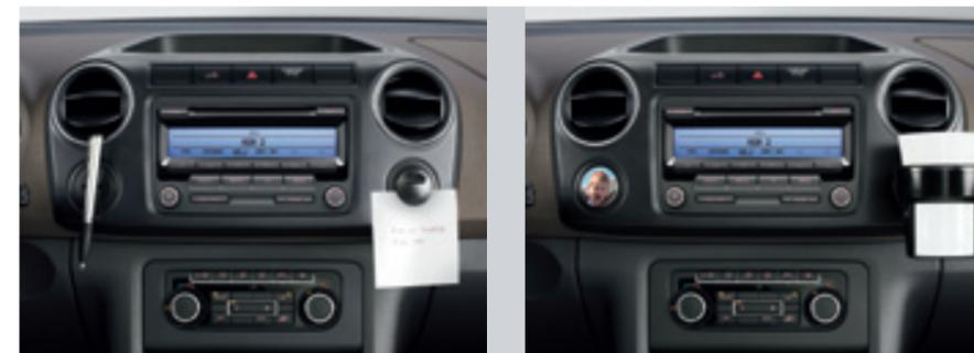
Das Multifixierpunkt-Zubehör. Im Bereich der Instrumententafel – optimal erreichbar und im Blickfeld des Fahrers – ist der Amarok mit zwei Multifixierpunkten ausgestattet. Hierfür sind viele praktische Produkte erhältlich: ein Becherhalter, ein Bildhalter, eine Zettelklemme oder ein Magnethalter zur Befestigung metallischer Gegenstände. Für die Grundversion kann die Aufnahme für den Multifixierpunkt nachgerüstet werden.
