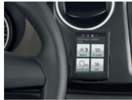
Die Bluetooth-Freisprecheinrichtung „Touch Phone-Kit“. Das 2,8"-TFT-Farbdisplay mit Touchscreen bietet höchsten Bedienkomfort. Eine sichere Handhabung während der Fahrt ist dank Sprachsteuerung jederzeit möglich.
