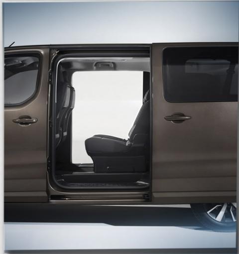
Zum Öffnen der optionalen, sensorgesteuerten Automatik-Schiebetür einfach den Fuß unter dem hinteren Seitenschweller bewegen, und schon öffnet sie sich von allein.
