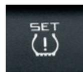
Die serienmäßige **Reifendrucküberwachung** registriert über die ABS-Sensoren die Veränderung der Umlaufgeschwindigkeit eines zu gering befüllten Reifens und weist per Kontrollleuchte und Signalton darauf hin.
