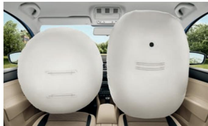
Im Fall der Fälle schützen **Fahrer- und Beifahrerairbag** die Passagiere auf den vorderen Sitzplätzen. Der Beifahrerairbag kann deaktiviert werden, wenn sich auf dem Beifahrersitz eine rückwärtsgerichtete Babyschale befindet.
