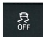
Eine Reihe elektronischer Systeme sorgt für eine sichere Fahrt. So z. B. die **elektronische Stabilisierungskontrolle (ESC)** oder die **Antriebsschlupfregelung (ASR)**. Sie sorgt dafür, dass die Räder beim Beschleunigen nicht durchdrehen. Das System kann je nach Ausstattung über eine Taste in der Mittelkonsole deaktiviert werden.
