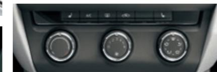
Mit der **Klimaanlage** können Sie den Temperaturbereich, die Intensität und die Richtung der Luftströmung manuell einstellen.
