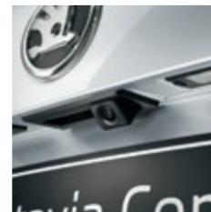
Für noch einfacheres Einparken können Sie Ihr Fahrzeug mit einer **Rückfahrkamera** ausstatten. Sie kontrolliert den Bereich hinter dem Fahrzeug und zeigt den perfekten Weg zum sicheren Einparken in die gewünschte Parklücke an. Die Fahrzeugbreite wird ebenfalls berücksichtigt. Dieses Assistenzsystem gibt es in Verbindung mit einer Telefonfreisprecheinrichtung.
