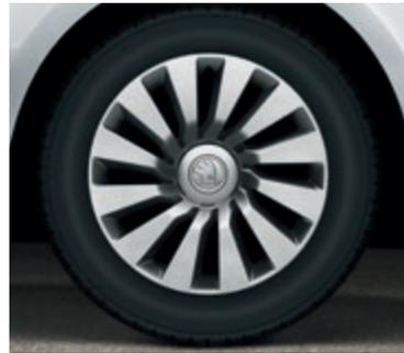
Stahlfelgen 6,0jx16" mit 205/55-R16-Bereifung und Radzierblenden **Tekton**. Serie bei Active und Ambition.
