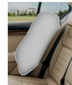
**Seitenairbags vorn und hinten** schützen bei einem Seitenaufprall Becken und Brustkorb der Fahrzeugpassagiere.
