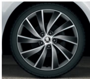
Leichtmetallfelgen **Turbine** 7,5j x 18" mit 225/40-R18-Bereifung. Serie bei L&K.
