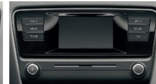
Das **Musiksystem Bolero** verfügt über ein 6,5" großes Touchscreen-Farbdisplay mit Multitouch-Bedienung, Wischfunktion und Näherungssensor. Hier bieten Line-in-Audioanschluss, USB-Anschluss, Bluetooth Audio-streaming und SD-Speicherkarten-Slot vielfältige Möglichkeiten zum Abspielen der gewünschten Musik, auch im MP3- und WMA-Format. Über DAB+ können digitale Radiosender empfangen werden.
