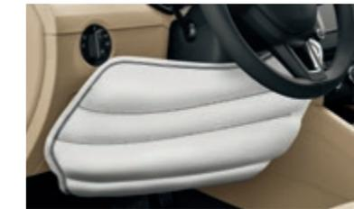
Der **Fahrer-Knieairbag** unterhalb der Lenksäule schützt die Beine des Fahrers.
