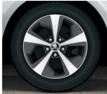
Leichtmetallfelgen **Lepus** 6,5jx16" mit 205/55-R16-Bereifung. Serie bei GreenLine.
