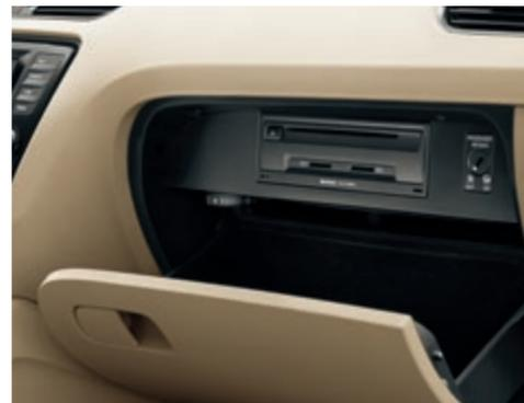
In Verbindung mit dem Musiksystem Bolero und dem Radio-Navigationssystem Amundsen befinden sich die **SD-Speicherkarten-Slots** im Handschuhfach auf der Beifahrerseite. Bei Wahl des Radio-Navigationssystems Columbus ist hier ebenfalls der **DVD-Spieler** untergebracht.
