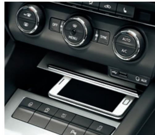
Komfortables Telefonieren: Die in Verbindung mit der Bluetooth-Telefonfreisprecheinrichtung Komfort in die Mittelkonsole integrierte **Phonebox** ermöglicht eine gute Empfangsqualität mittels Induktionsfeld und bietet einen sicheren Aufbewahrungsort für Ihr Handy während der Fahrt. Dazu verfügt die Mittelkonsole über einen **Line-in-Audioanschluss** und einen **USB-Anschluss**.
