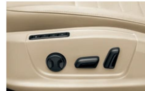
Der **elektrisch einstellbare Fahrersitz** verfügt über einen Speicher, in den drei verschiedene Sitz- und Außenspiegelpositionen eingegeben werden können. Des Weiteren kann eine Sitzposition auch auf dem Fahrzeugschlüssel gespeichert werden. Beim Entriegeln des Fahrzeugs bewegt sich der Sitz automatisch in die gespeicherte Position und der Fahrer findet seine bevorzugte Sitzeinstellung vor.
