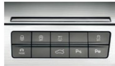
In Reichweite des Fahrers befindet sich die **Funktionstastenleiste**. Je nach Ausstattung und Motorvariante lassen sich über einzelne Tasten die Funktionen von Zentralverriegelung, Start-Stopp-Automatik, Reifendrucküberwachung, Fahrprofilwahl, ASR, vorderen Parksensoren und Parklenkassistent bedienen.
