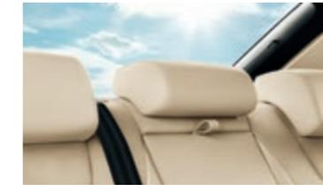
Die **dritte Kopfstütze** im Fond ist höhenstellbar und trägt zur Sicherheit des Passagiers auf dem mittleren Rücksitz bei.
