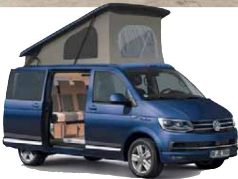
Das Reimo Easy Fit Schlafdach ist extrem flach konstruiert und mit nur ca. 7 cm Höhe sehr aerodynamisch.
