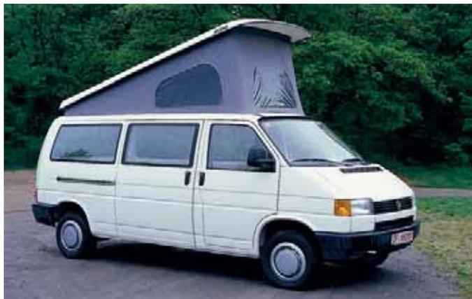
Gasfederunterstützte Dachaufstellung vorne hoch. Mit Teilegutachten\*. Stehhöhe bei geöffnetem Dach ca. 195 - 245 cm. Fahrzeughöherhöhung ca. 6 cm. Integrierte Regenrinne. 3 Fenster im Zeltbalg (1 davon mit Folie), Moskitonetz mit Reißverschluss. Schlaffläche ca. 200x120 cm. Zeltbalg 100% Baumwolle. Bezug 100% Polyester. Glasschiebedach und Solarzelle möglich. Verdeckte Aufnahme der Aktivschiene ohne zusätzliche Fahrzeughöherhöhung möglich. Dachschalenfarbe Weiß. 21121 2499,-
