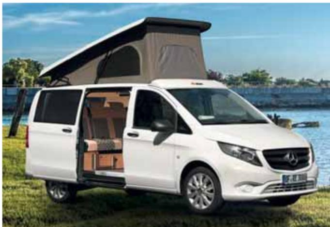
Gasfederunterstützte Dachaufstellung vorne hoch. Fertig vormontiert, inkl. Frontspoiler. 2 seitliche Fenster (Moskitonetz herausnehmbar), 1 in der Front integriertes Folienfenster. Fahrzeughöhe inkl. Dach ca. 197 cm. Stehhöhe ca. 170 - 222 cm. Zeltbalg 100% Baumwolle. Mit Integral-Verstärkungsrahmen. Dachschalenfarbe Weiß
