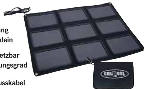
Monokristallines Solarpanel, 50 W Leistung zum Anschluss an Laderegler (V max. 17,4 V / I max. 2,87 A). Ideal zum Laden der Starterbatterie oder der Bordbatterie. Inkl. Tasche mit Aufhängeösen. Maße: L 96 x B 68 x H 0,8 cm. Zusammengefaltete: 22 x 32 x 6 cm. Gewicht: 2,5 kg.
