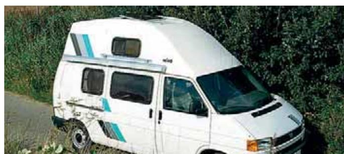
Elegante Dachform. Dachmaße ca. L335 x B149 x T85 cm. Fahrzeugerhöhung ca. 74 cm. Stehhöhe ca. 210 cm. Fenster seitlich und hinten max. 70 x 30 cm. Option: verdeckte Aktivträgersystem und Schiebedachluke 52 x 54 cm möglich. Mit Teilegutachen\*. Dachfarbe Weiß
