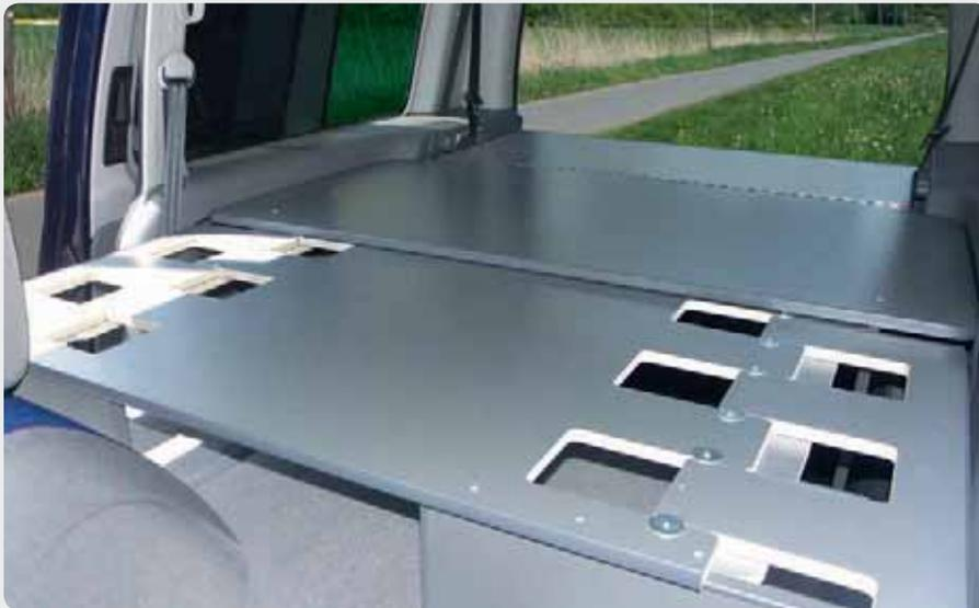
Die völlig ebene Liegefläche mit hohem Schlafkomfort für 2 Personen nutzt clever die maximale Innenbreite des Fahrzeugs (Abb. zeigt Unterkonstruktion ohne Polster)
