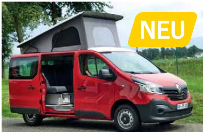
Gasfederunterstützt, Dachaufstellung vorne hoch. Mit Front- und 2 Seitenfenster. Die Front kann mit Reißverschluss geöffnet werden. Seitenfenster mit Moskitonetzen. Himmel (100% Polyester), Zeltbalg grau (100% Baumwolle). Mit Teilegutachten\*. Dachschalenfarbe Weiß
