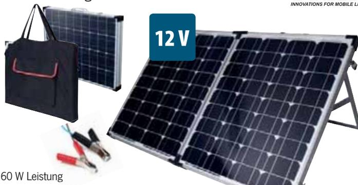
Monokristallines Solarpanel mit 60 W Leistung (V max. 21,7 / I max. 3,82 A). Integrierter USB-Anschluss 5 V/1,2 A im Laderegler. Transporttasche im Lieferumfang. Maße: L 540 x B 440 x H 70 mm. Zusammengefaltete: 1085 x 440 x 35 mm. Gewicht: 8 kg.
