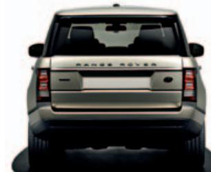
Spurweite hinten 1.683 mm
