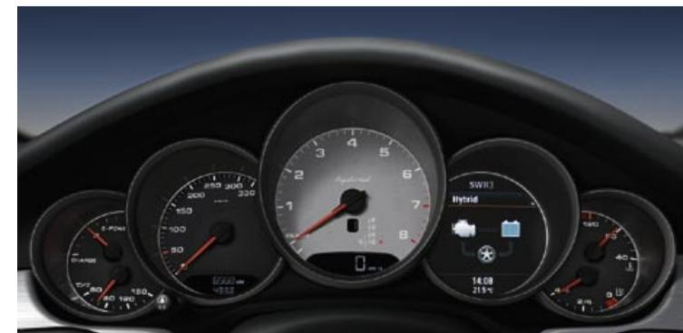
Hybrid-Anzeige im Kombiinstrument
