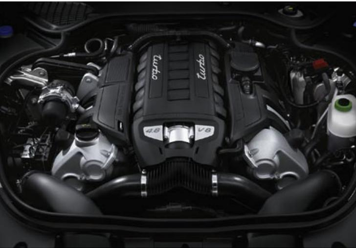
V8-Zylinder-Biturbo-Motor im Panamera Turbo
