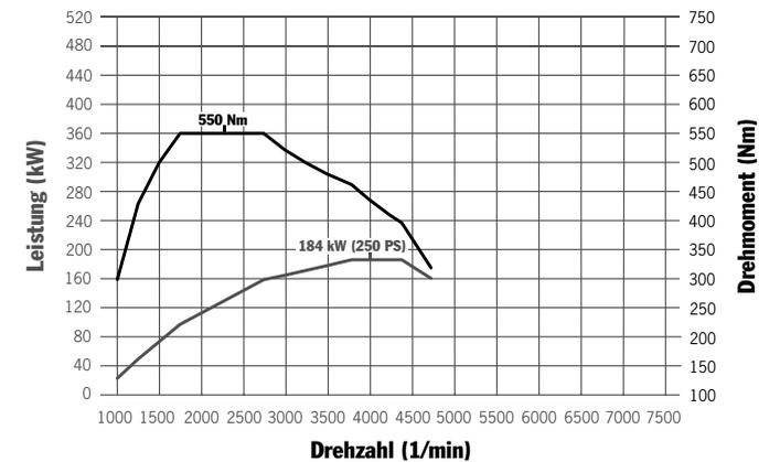
Panamera Diesel: 184 kW (250 PS) bei 3.800–4.400 1/min, 550 Nm zwischen 1.750 und 2.750 1/min
