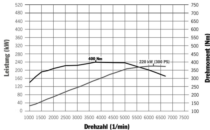
Panamera und Panamera 4: 220 kW (300 PS) bei 6.200 1/min, 400 Nm bei 3.750 1/min
