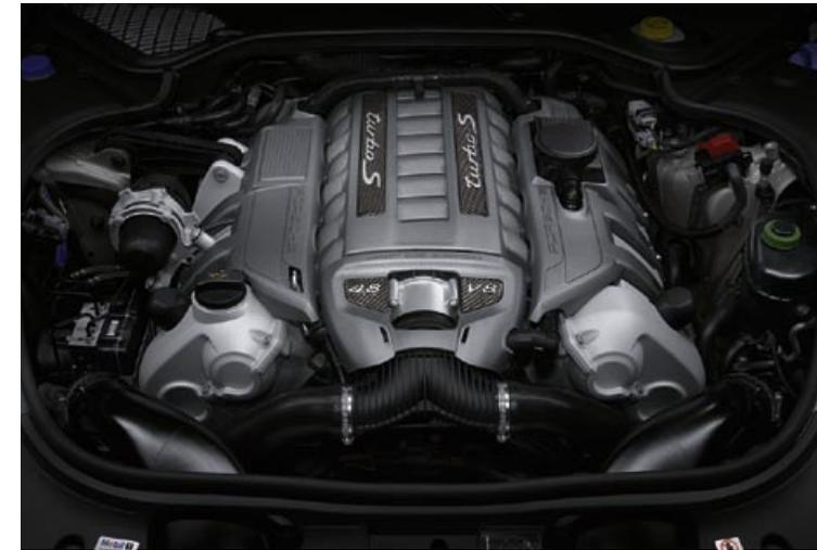
V8-Zylinder-Biturbo-Motor im Panamera Turbo S
