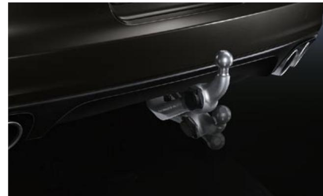
Elektrisch ausklappbare Anhängезugvorrichtung
