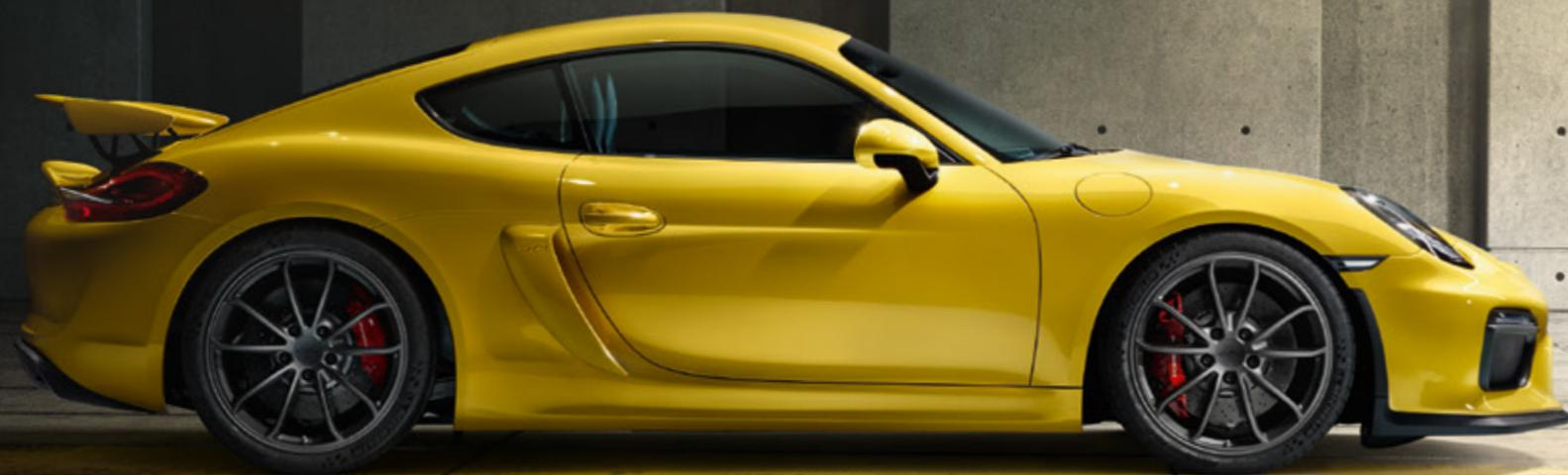
Auch die seitlichen Lufteinlässe hinter den Türen sind ein Musterbeispiel für performanceorientiertes Design: Sideblades mit geprägtem „GT4“ Schriftzug sorgen für zusätzlichen Staudruck. Das Ergebnis: eine bessere Luftansaugung und effizientere Kühlung des Motors.
