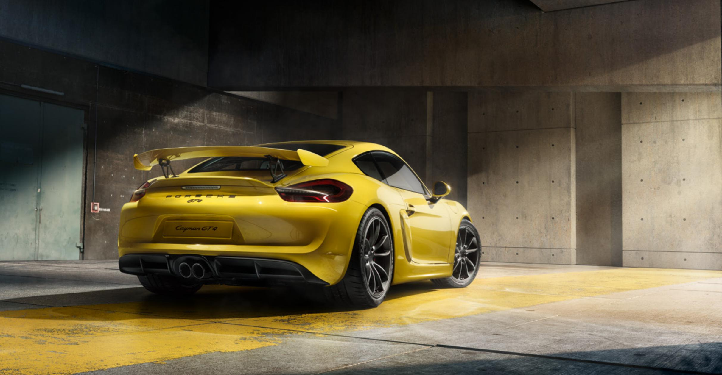
Am deutlichsten zeigt sich die Abstammung des neuen Cayman GT4 am Heck. Der feststehende Flügel mit Stützen aus Aluminium steht für Motorsport in Reinkultur. In Kombination mit dem darunter liegenden Spoiler mit integrierter Abrisskante – dem Gurney Flap – sorgt er für spürbaren Abtrieb an der Hinterachse. Die Sideplates des Flügels sind auf bestmögliche Aerodynamik abgestimmt: Noch ein Beleg dafür, dass alle Details konsequent aufeinander abgestimmt sind.
