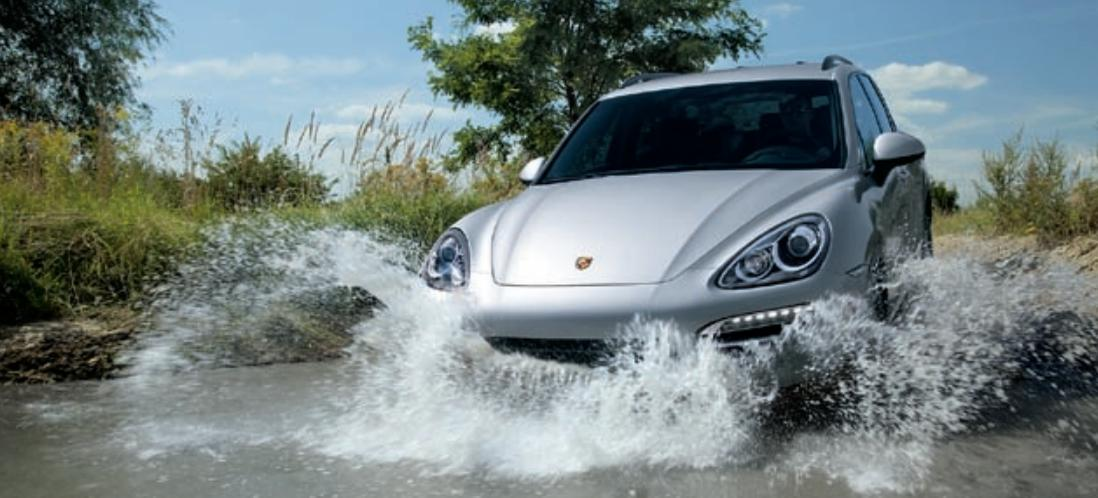
Zusätzlich wird bei Fahrzeugen mit Luftfederung inkl. PASM das Geländeniveau angefahren. Über die Schalterwippe der Luftfederung ist auch die Anwahl des Sondergeländeniveaus möglich, um Böschungs- und Rampenwinkel sowie die Wattiefe zu erhöhen.
