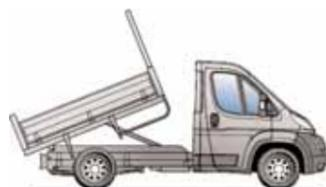
Benne sur châssis cabine
