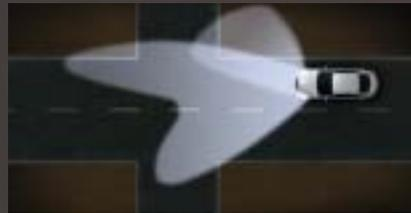
**Statisches Abbiegelicht (bis 40 km/h und im Rückwärtsgang).** Aktiviert durch den Blinker, sorgt es an Kreuzungen durch zusätzliche Reflektoren, die im rechten Winkel zum Fahrzeug strahlen, beim Abbiegen für Sicherheit.
