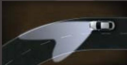
**Dynamisches Kurvenlicht (alle Geschwindigkeitsbereiche).** Zur Ausleuchtung von Kurven schwenken die Scheinwerfer – gesteuert durch Lenkradeinschlag und Geschwindigkeit – bis zu 15° nach links oder rechts.
