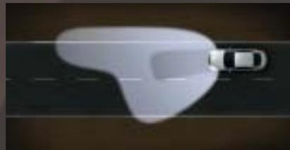
**Schlechtwetterlicht (bis 70 km/h).** Bei einsetzendem Regen droht Blendgefahr für Sie und den Gegenverkehr durch die Reflexion unmittelbar vor dem Fahrzeug. In diesem Bereich wird deshalb die Ausleuchtung reduziert.
