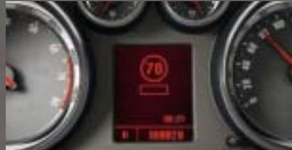
Im Gegensatz zu den vorprogrammierten Anzeigen, die manche Navigationssysteme bieten, informiert der Verkehrsschildassistent des Opel Insignia über die aktuelle Situation – also z. B. auch an Baustellen und bei neuer Beschilderung. Der Verkehrsschildassistent erkennt die runden Standard-Verkehrsschilder zu Geschwindigkeitsbegrenzungen und Überholverbot sowie deren Aufhebung. Er wird automatisch aktiviert zwischen 14 km/h und 200 km/h bei Tag bzw. 150 km/h bei Nacht.
