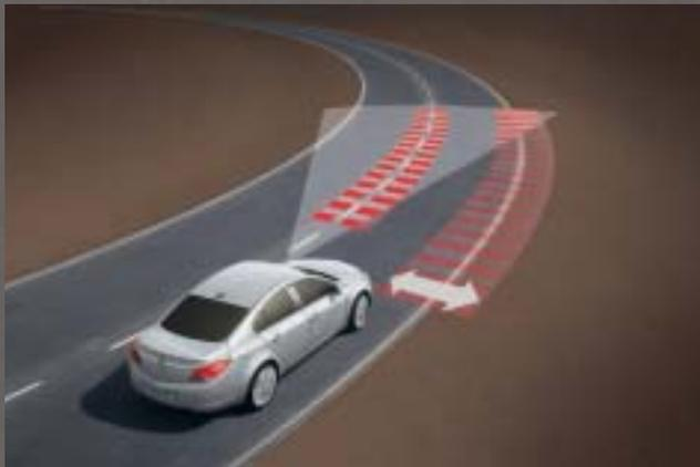
Die Frontkamera des Opel Insignia registriert sowohl die unterbrochenen als auch die durchgehenden Linien zur Fahrbahnbegrenzung. Wird eine der Linien unbeabsichtigt überfahren, macht der Spurassistent durch einen Warnton und eine Anzeige im Drehzahlmesser den Fahrer darauf aufmerksam.
