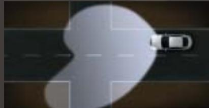
**Stadtlicht (30–55 km/h).** Wenn in diesem Geschwindigkeitsbereich eine Straßenbeleuchtung erkannt wird, schaltet AFL+ auf ein dem Stadtverkehr angepasstes Lichtprofil um.
