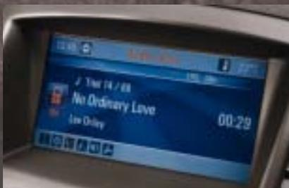
**Aux-In-Stereoeingang und USB-Anschluss.** Für externe Audiogeräte wie MP3-Player und iPods. Über USB angeschlossene Audioquellen werden im Display dargestellt und über das Infotainment-System gesteuert.
