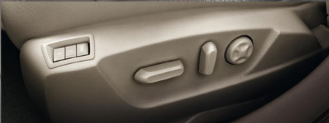
**Elektrische Sitzeinstellung mit Memory-Funktion.** Einmal eingestellt, kann die optimale Position von Fahrersitz und Außenspiegel nach einem Fahrerwechsel auf Knopfdruck abgerufen werden. Die Memory-Funktion wird auch automatisch über den Fahrzeugschlüssel aktiviert.
