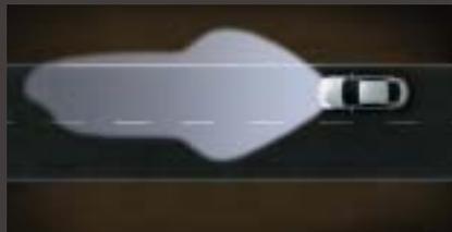
**Autobahnlicht (ab 100 km/h).** Bei konstant schneller Fahrt auf gerader Strecke oder in lang gezogenen Kurven erkennt AFL+, dass Sie auf der Autobahn unterwegs sind, und erhöht sowohl die Reichweite als auch die Leuchtkraft der Scheinwerfer.
