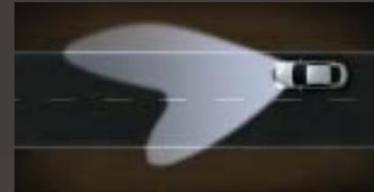
**Landstraßenlicht (55–100 km/h).** Die weitreichende Ausleuchtung des rechten Fahrbahnrandes lässt potenzielle Gefahrenquellen – z. B. wechselndes Wild – schon aus weiter Entfernung erkennen.
