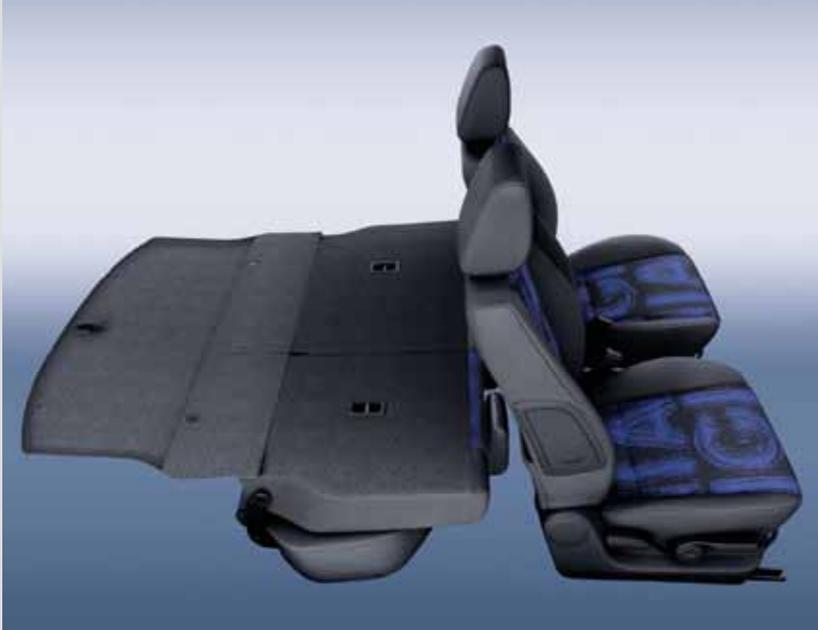
⬆️ ▶️ **Ebene Ladefläche.** Die Rücksitzlehnen des Opel Agila Edition lassen sich 1/3 zu 2/3 geteilt umklappen. Werden die Rücksitzlehnen nach vorn umgeklappt, senken sich die Sitze automatisch ab. Auf diese Weise entsteht eine ebene Ladefläche.
