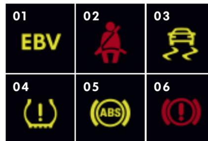
**01** Wenn sich das Fahrzeuggewicht beim Bremsen auf die Vorderräder legt, verhindert die **Elektronische Bremskraftverteilung (EBV)** das Blockieren der weniger belasteten Hinterräder. So bleiben Sie stets sicher in der Fahrspur.
