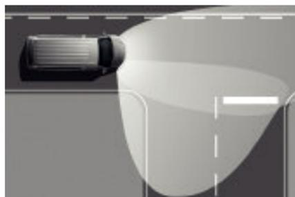
Das **Abbiegelicht** der Nebelscheinwerfer leuchtet beim Abbiegen den kurveninneren Straßenrand aus, wenn Sie 40 km/h oder langsamer fahren. So erkennen Sie mögliche Gefahren schneller und kommen sicher ans Ziel.
