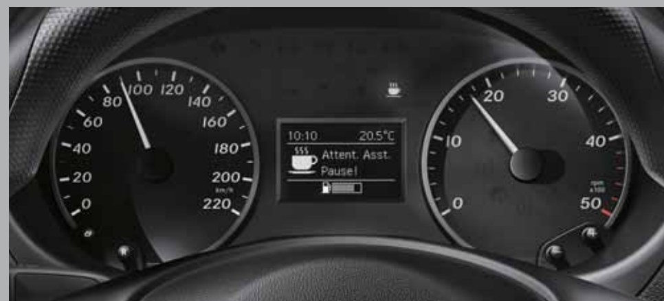
Der serienmäßige ATTENTION ASSIST kann mithilfe zahlreicher Parameter typische Anzeichen von Ermüdung erkennen und den Fahrer warnen.
