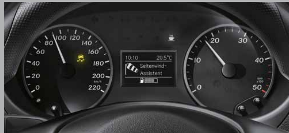
Der serienmäßige Seitenwind-Assistent hilft, Spurversatz bei böigem Seitenwind zu vermeiden.
