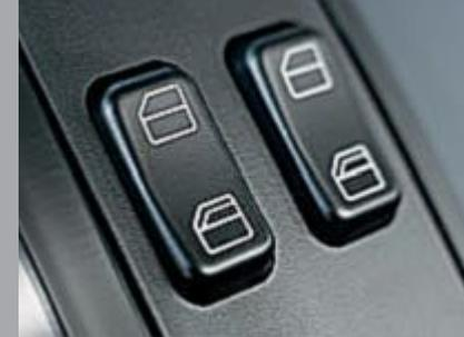
○ **Fensterheber.** Elektrische Fensterheber für die Fahrer- und Beifahrertür erleichtern die Bedienung.
