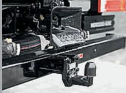
○ **Anhängerkupplung.** Ab Werk sind für den Vario sowohl eine Kugelkopf-Anhängerkupplung als auch verschiedene Bolzen-Anhängerkupplungen erhältlich.
