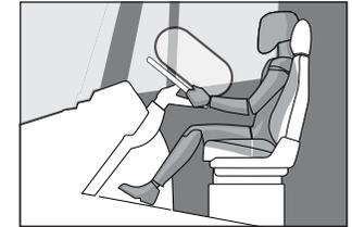
**Fahrer-Front-Airbag.** Als Ergänzung der Sicherheitsausstattung ist für den Vario ein Front-Airbag am Fahrerplatz erhältlich. Er erhöht das Schutzpotenzial des angegurten Fahrers und ist damit ein zusätzliches Rückhaltesystem zum Sicherheitsgurt.
