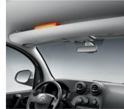
● **Ablagefach über Frontscheibe.** Die offene Ablage für Fahrer und Beifahrer über der Windschutzscheibe bietet ein Gesamtvolumen von 12,6 Litern.
