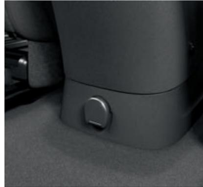
○ **Steckdose 12 V Fahrgastraum.** An der Rückseite der Mittelkonsole befindet sich eine 12-V-Steckdose mit 10 A Stromstärke.
