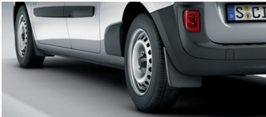
**Schmutzfänger.** Sie schützen vor Schmutz und Kratzern im Bereich der Seitenflanken, des Hecks und des Unterbodens.
