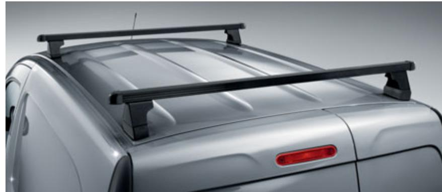
**Lastenträger<sup>1</sup>.** Das robuste Vierkantprofil bildet die Basis für diverse Aufsätze. Zum Verschrauben an vorhandenen Befestigungspunkten im Dachkanal.
