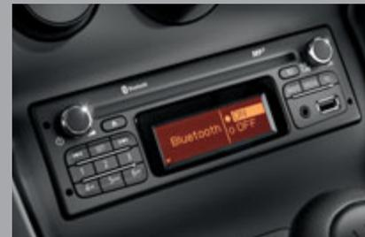
**Radio.** Das optionale LCD-Radio enthält eine Aux- und USB-Schnittstelle. Es ermöglicht Bluetooth®-Telefonie und -Audiostreaming. Auf Wunsch ist ein CD-Laufwerk erhältlich.
