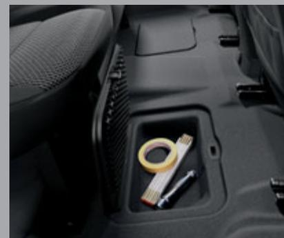
**Staufächer im Boden des Fahrgastraums.** Auf Wunsch können im hinteren Fahrgastraum im Boden 2 Staufächer integriert werden. Beide Staufächer bieten je einen Raum von ca. 6,6 Litern.
