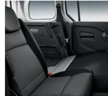
● **Fondsitzbank 1. Reihe klappbar 1/3 zu 2/3 mit Kopfstützen.** Die im Verhältnis 1/3 zu 2/3 umklappbare 3er-Sitzbank ermöglicht auch den Transport großer Gegenstände.
