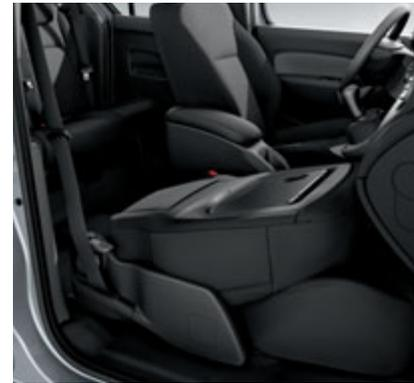
○ **Beifahrersitz klappbar.** Die Rückenlehne des Beifahrersitzes lässt sich herunterklappen und bietet so eine Ladelänge von bis zu 2,8 m.
