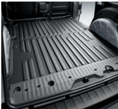
● **Kunststoffboden im Fahrgast- und Laderaum**. Der geräuschreduzierende Kunststoffboden im Fahrgast- und Laderaum ist einfach zu reinigen und schützt den Boden vor Kratzern und Dellen.
