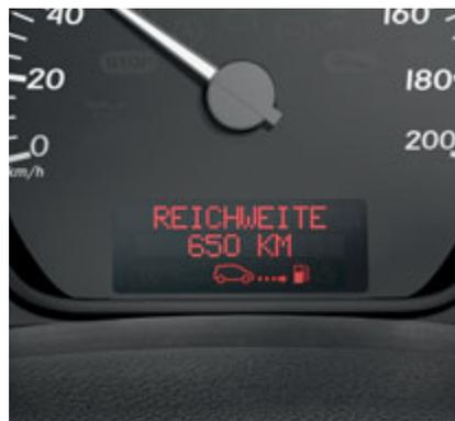
● **Reiserechner.** Der Reiserechner zeigt Kraftstoffverbrauch, Distanz, Reichweite oder Durchschnittsgeschwindigkeit auf einen Blick.
