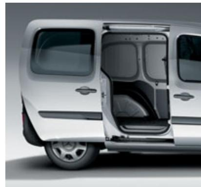
● **Schiebetür rechts mit Fenster<sup>4</sup>**. Rechtsseitige Schiebetür mit komfortabler Türöffnung, Fenster und breiter Einstiegsstufe für leichten Zugang.
