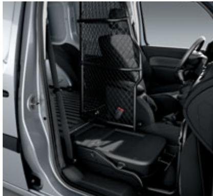
○ **Beifahrersitz klappbar.** Die Rückenlehne des Beifahrersitzes lässt sich beim Citan Kastenwagen herunterklappen und bietet so eine Ladelänge von bis zu 2.886 mm.
