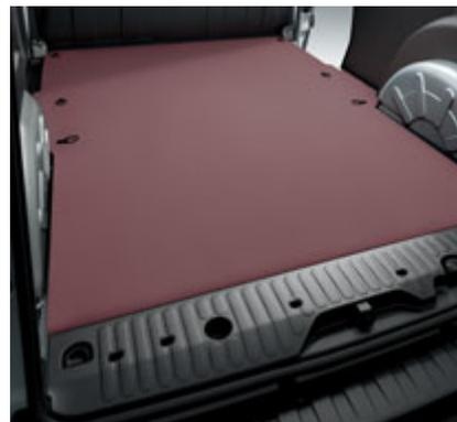
○ **Holzfußboden im Laderaum**. Schützt den Laderaumboden, erleichtert Beladen und Reinigung und verbessert die Isolierung.
