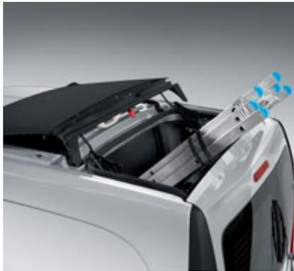
○ **Leiterklappe<sup>1</sup>**. Die Leiterklappe an der Dachrückseite ermöglicht es, bei Bedarf auch sehr lange Güter zu transportieren.
