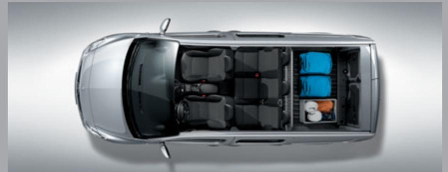
Der Citan Mixto verbindet komfortable Beförderungsmöglichkeiten und hochflexible Laderaumnutzung. Die optionale einteilige 3er-Sitzbank in erster Reihe kann bei Bedarf mit wenigen Handgriffen in ein Lastschutzgitter verwandelt und der Laderaum so deutlich auf bis zu 3,7 m<sup>3</sup> vergrößert werden.
