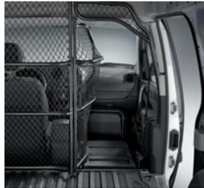
○ **Beifahrersitz und Lastschutzgitter klappbar<sup>2</sup>**. Je nach Fahrzeuglänge entsteht so eine ebene Fläche und ein vergrößerter Fahrgastraum von bis zu max. 2.886 mm.
