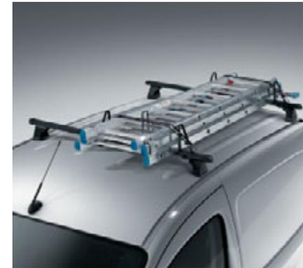
**Leiterhalter.** Zum sicheren Transport diverser Leitern auf dem Fahrzeugdach. Nur in Verbindung mit Lastenträger.
