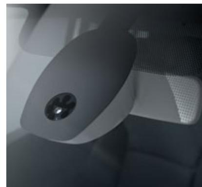
○ **Licht- und Regensensor.** Der Licht- und Regensensor passt Beleuchtung und Wischintervall automatisch der Umgebungshelligkeit bzw. Witterung an.
