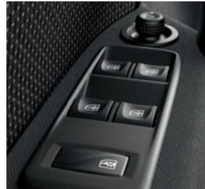
○ **Fensterheber vorn elektrisch, Fahrerseite mit Komfortbedienung.** Die elektrischen Fensterheber öffnen und schließen die Fenster. Auf der Fahrerseite genügt ein kurzes Betätigen des Schalters.
