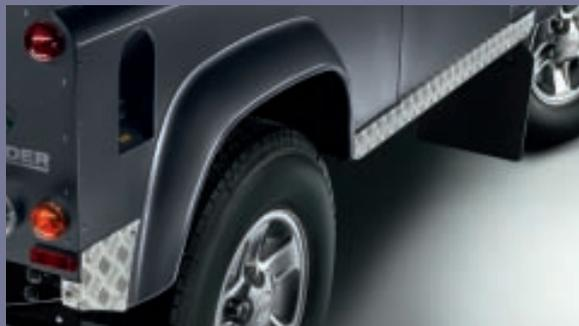
**Kit de protection en tôle gauffrée**
