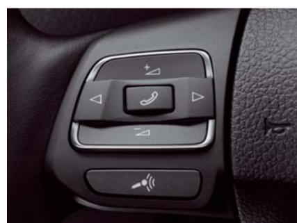
Die Mobiltelefonvorbereitung verfügt über Freisprecheinrichtung, Radiostummschaltung und Bluetooth-Schnittstelle und ist mit vielen gängigen Mobiltelefonen kombinierbar.
