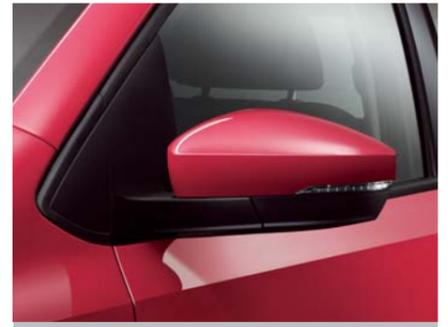
Der Außenspiegel mit integrierter Blinkleuchte ist in Wagenfarbe lackiert und passt optimal zum prägnanten Design der Karosserie. Zudem sind die Außenspiegel elektrisch einstell- und beheizbar.
