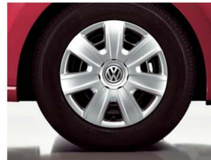
Das 14-Zoll-Stahlrad mit Bereifung 175/70 R 14 hat eine robuste Radvollblende mit sieben Speichen.
