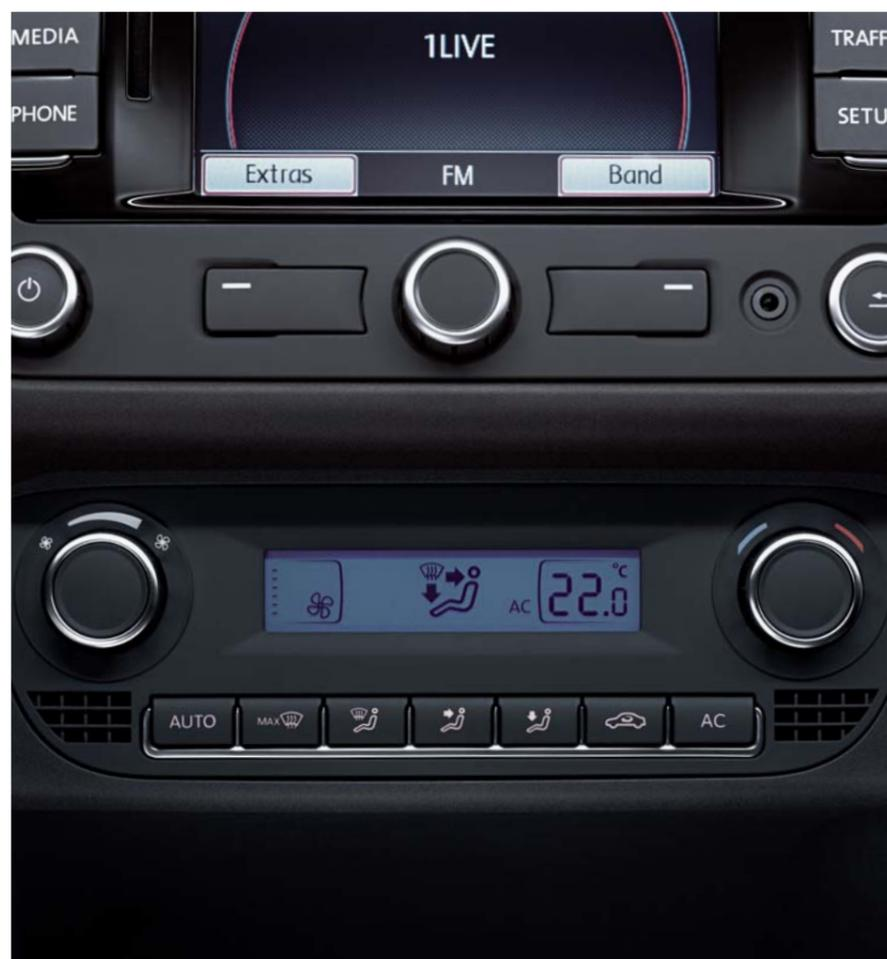
Die Klimaanlage „Climatronic“\* mit elektronischer Regelung ermöglicht es Ihnen, die gewünschte Temperatur konstant zu halten, der Aktivkohleinsatz des integrierten Staub- und Pollenfilters hält schlechte Gerüche draußen. Außerdem kühlt sie das Handschuhfach.
