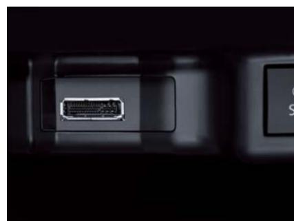
Die Multimediabuchse MEDIA-IN mit USB-Schnittstelle erlaubt den Anschluss externer Audioquellen und deren Bedienung über das jeweilige Radio oder Radio-Navigationssystem.
