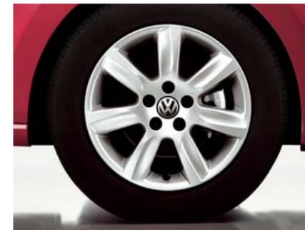
Mit seinem modernen Design wird das Leichtmetallrad „Riverside“ mit 15 Zoll und Bereifung 185/60 R 15 dem ausgefallensten Geschmack gerecht.
