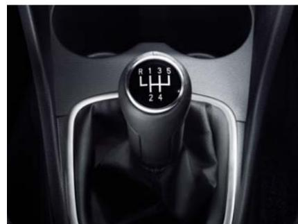
Das 5-Gang-Schaltgetriebe ist voll synchronisiert und damit leicht zu schalten. So bleiben Sie bequem im richtigen Drehzahlbereich.
