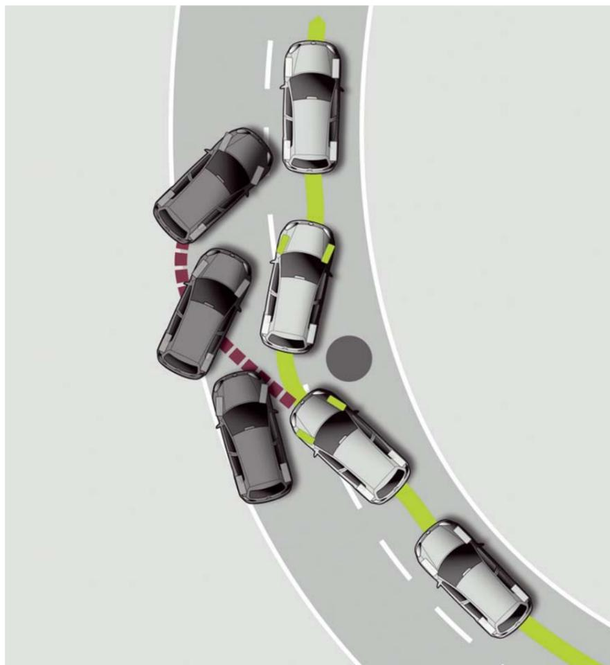
Das Elektronische Stabilisierungsprogramm (ESP) mit Berganfahrassistenten verhindert in kritischen Fahrsituationen ein Ausbrechen des Fahrzeuges, indem es gezielt in das Brems- und Motormanagement eingreift.
