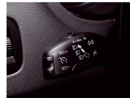
Ab 30 km/h hält die **Geschwindigkeitsregelanlage** Ihr gewähltes Tempo konstant, ohne dass Sie Gas geben müssen. Bei Betätigung von Bremse oder Kupplung schaltet sie sich automatisch wieder aus.
