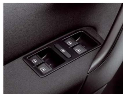
**Elektrische Fensterheber vorn und hinten** regeln die Luftzufuhr ganz bequem. Zu Ihrer Sicherheit: Sobald der hochsensible Einklemmschutz einen Widerstand zwischen Fenster und Rahmen registriert, wird die Scheibe sofort ein Stück abgesenkt.
