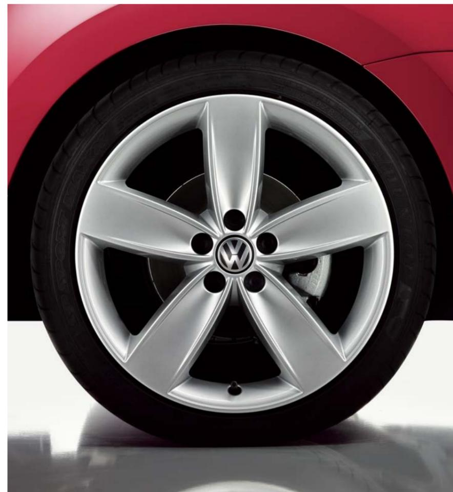
Schlichte Sportlichkeit: Das 17-Zoll-Leichtmetallrad „Boavista“ Volkswagen Individual\* mit Bereifung 215/40 R 17 verleiht Ihrem neuen Polo einen konsequent eigenständigen Auftritt. Selbstverständlich verfügen alle Leichtmetallräder über diebstahlsichere Schrauben. Zusätzlich ist bei allen 16- und 17-Zoll-Leichtmetallrädern ein platzsparendes Reserverad mit Wagenheber und Bordwerkzeug inklusive.
