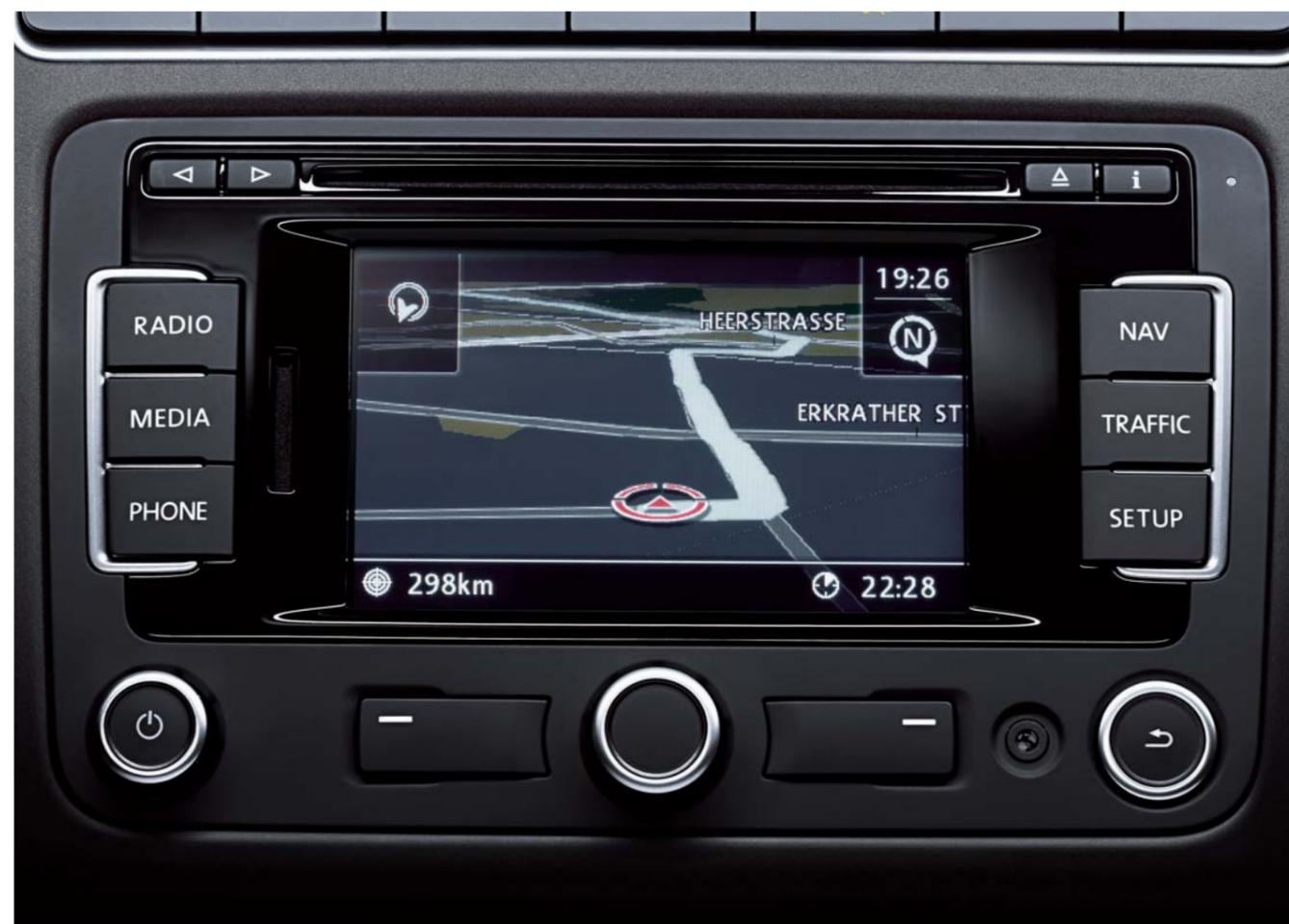
Das Radio-Navigationssystem „RNS 310“ mit CD-Laufwerk und MP3-Wiedergabefunktion spielt auch bei eingeschalteter Zielführung Audio-CDs ab. Es hat ein als Touchscreen steuerbares Farbdisplay mit übersichtlicher Kartennavigation sowie einen Leseschacht für SD-Karten.
