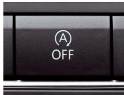
Innovativ: Das Start-Stopp-System steht für noch sparsameres und schadstoffärmeres Fahren. Beim Halten im Stau oder an einer Ampel reicht es, die Kupplung zu lösen, und der Motor schaltet sich aus. Zum Weiterfahren kuppeln Sie einfach wieder ein.
