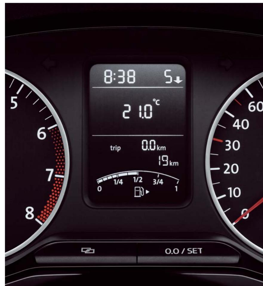
Auf der **Multifunktionsanzeige** lassen sich während der Fahrt relevante Informationen wie aktuelle und durchschnittliche Verbrauchswerte, Durchschnittsgeschwindigkeit, Reichweite, Fahrstrecke sowie Uhrzeit und Außentemperatur ablesen. Außerdem ist für alle Modelle mit einem Dieselmotor die Gangempfehlung im Kombi-Instrument inklusive.
