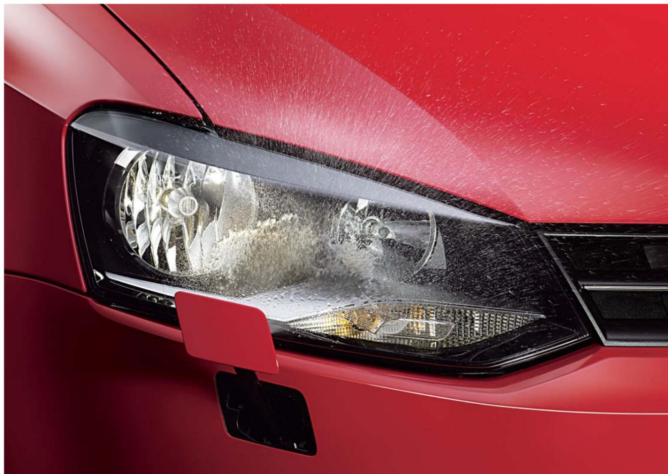
Die Scheinwerfer-Reinigungsanlage ist Teil des Winterpakets. Sie erhöht die Sicherheit bei Regen, Schnee und aufgewirbeltem Schmutz. Für noch mehr Komfort und Sicherheit in der kalten Jahreszeit sind in diesem nützlichen Paket auch beheizbare Vordersitze und automatisch beheizte Scheibenwaschdüsen vorn enthalten. Zusätzlich kann es um Winterreifen auf Stahlrädern ergänzt werden.
