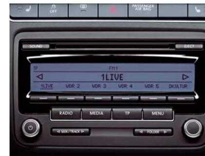
Das Radio „RCD 310“ besitzt ein CD-Laufwerk sowie die Multimediabuchse MEDIA-IN und spielt Dateien im MP3- und WMA-Format ab. Satten Sound gewährleisten insgesamt sechs Lautsprecher und eine Ausgangsleistung von 4 x 20 Watt.
