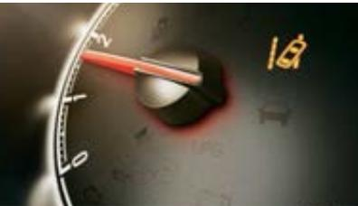
**Der Spurassistent.** Sie haben nicht geblinkt und laufen Gefahr, bei mehr als 60 km/h aus der Spur zu geraten? Der Assistent schlägt rechtzeitig Alarm.
