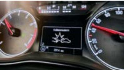
**Der Frontkollisionswarner und die Abstandsanzeige.** Ab einer Geschwindigkeit von 40 km/h warnt Sie das System vor Auffahrunfällen, wenn Ihr Corsa sich vorausfahrenden Fahrzeugen zu schnell nähert.
