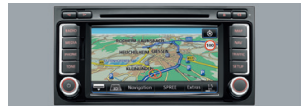
Das Radio-Navigationssystem „RNS 510“ . Dieses System verfügt über eine AUX-IN-Schnittstelle im Handschuhfach und einen 6,5"-Farbtouchscreen. Auf der mitgelieferten DVD ist das Kartenmaterial für Westeuropa gespeichert. Es kann auf die 30-GB-Festplatte des „RNS 510“ kopiert werden, sodass Sie gleichzeitig über die acht Lautsprecher Ihre Lieblings-CD hören können. Alternativ lässt sich das Gerät per Sprachbefehl bedienen.
