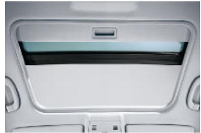
□ **Glasdach**, elektrisch, mit Schiebe- und Hebefunktion sowie Komfortöffnung über die Fernbedienung.
