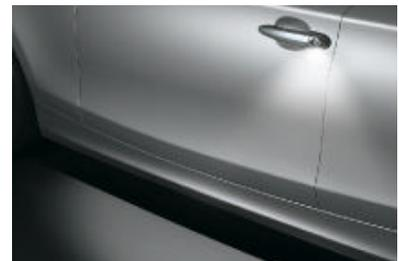
□ **Lichtpaket** umfasst die Vorfeldbeleuchtung in den Türgriffen, die nach dem Entriegeln der Türen den Einstiegsbereich 20 Sekunden lang ausleuchtet – für einen sicheren Einstieg bei Dunkelheit. Weitere Umfänge: Leseleuchten vorn und hinten mit Ambientelicht, Fußraumleuchte vorn sowie Make-up-Spiegel-Beleuchtung für Fahrer und Beifahrer.
