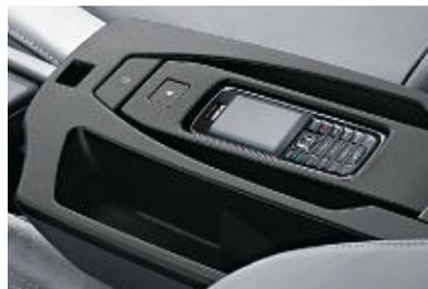
□ **Handyvorbereitung Business mit Bluetooth-Schnittstelle inkl. BMW Assist** (inkl. Freisprecheinrichtung, Anschluss für Lademöglichkeit und Außenantenne). Über einen separat erhältlichen Snap-In-Adapter kann ein Bluetooth-fähiges Handy angeschlossen werden, dass sich auch via iDrive (in Verbindung mit Navigationssystem) bedienen lässt.
