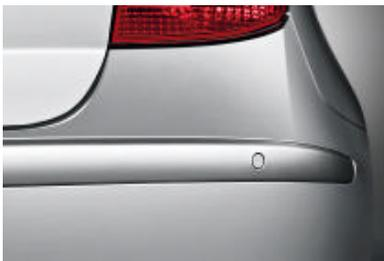
□ **Park Distance Control (PDC)**, erhältlich für vorn und hinten sowie nur für hinten, erleichtert das Einparken und Rangieren auf engstem Raum; die Annäherung Ihres Fahrzeugs an ein Hindernis wird durch Warntöne gemeldet. In Verbindung mit Navigationssystem auch optisch im Control Display.
