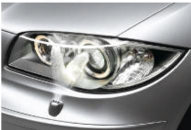
□ **Scheinwerfer-Waschanlage** ermöglicht bei jeder Witterung eine optimale Leuchtkraft der Scheinwerfer. Parallel zur Frontscheibe werden bei eingeschaltetem Licht auch die Scheinwerfergläser automatisch gereinigt (in der Ausstattung Xenon-Licht enthalten).
