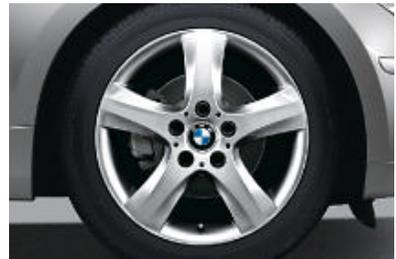
□ **BMW Leichtmetallräder Sternspeiche 142** mit Mischbereifung und Notlaufeigenschaften, vorn 7 J x 17 Zoll mit Bereifung 205/50 R 17, hinten 7,5 J x 17 Zoll mit Bereifung 225/45 R 17.
