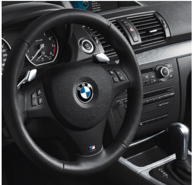
□ **Schaltwippen am Lenkrad** für eine besonders dynamische Fahrweise (in Verbindung mit der 6-Gang Automatic Steptronic); erhältlich für das Sport-Lederlenkrad oder das M Lederlenkrad (hier abgebildet mit Interieurleisten in Aluminium Glaciersilber).
