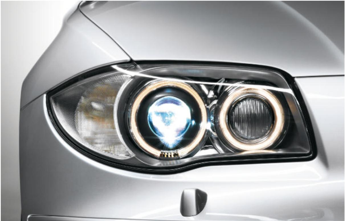
□ **Xenon-Licht für Ablend- und Fernlichtfunktion, inkl. LED-Heckleuchten**, Scheinwerfer-Waschanlage, Tagfahrlicht sowie vier Leuchtringen und automatischer Leuchtweitenregulierung, leuchtet die Fahrbahn nachts, bei schlechter Witterung oder Sicht deutlich besser aus.
