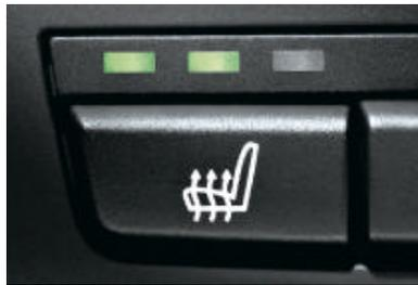
□ **Sitzheizung** für Fahrer- und Beifahrersitz (dreistufig), Sitzfläche und Rückenlehne, inkl. Seitenwangen, sind beheizbar und spenden bereits kurz nach Fahrtbeginn behagliche Wärme (abgebildet mit Klimaanlage).
