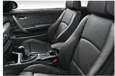
□ **Sportsitz** für Fahrer und Beifahrer (hier abgebildet mit auf Wunsch erhältlichem Leder Boston Schwarz), optimaler Seitenhalt durch stufenlose elektrische Sitzlehnenbreitenverstellung. Sitzlängsverstellung, Sitzhöhe, Lehnen- und Sitzneigung sowie Oberschenkelauflage sind manuell verstellbar.
