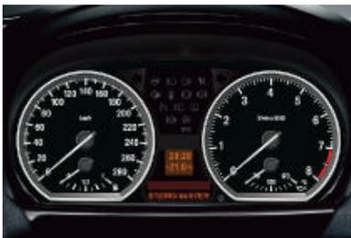
■ **Instrumententafel** verfügt beim 130i über eine spezielle Skalierung mit erweiterten Anzeigebereichen sowie Öltemperaturanzeige.
