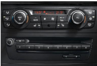
□ **Klimaautomatik** (hier abgebildet), inkl. AUC, Mikrofilter, Beschlag- und Solarsensor sowie ALL-Taste, sorgt schnell für Ihr Wunschklima und hält eine vorgewählte Temperatur konstant. Mit getrennter Temperatureinstellung für rechts/links.
