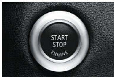
■ **Start-/Stop-Knopf** zum Starten des Motors. Der Zündschlüssel wird eingesteckt, und der Motor kann per Knopfdruck gestartet bzw. gestoppt werden.
