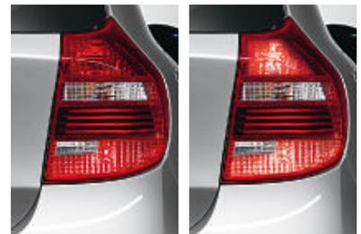
■ **Zweistufige Bremsleuchten** helfen nachfolgenden Fahrzeugen, Ihre Bremsituation besser einschätzen zu können: Im Falle einer Notbremsung vergrößert sich die Leuchtfläche der Bremsleuchten. So kann der nachfolgende Verkehr sofort ein leichtes Abbremsen von einer Vollbremsung unterscheiden – für noch mehr Fahrsicherheit.
