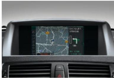
□ **Navigationssystem Business**, inkl. Radio Professional mit CD-Laufwerk, iDrive Controller mit Direktwahltasten, Favoritentasten, integriertem Speicher für Navigationsdaten, Pfeil- oder kombinierter Pfeil- und Kartendarstellung, feststehenden und hochauflösenden 6,5-Zoll-Displays.
