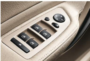
■ **Fensterheber vorn, elektrisch**, Zug-Druckschalter und Mautfunktion „Auf-Zu“, Komfortschließung rundum und Einklemmschutz.
