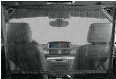
□ **Gepäckraumtrennnetz** schützt davor, dass bei starkem Bremsen Gegenstände in den Fahrgastraum fallen. Das Trennnetz ist nur funktionsfähig bei umgeklappter Rücksitzlehne.
