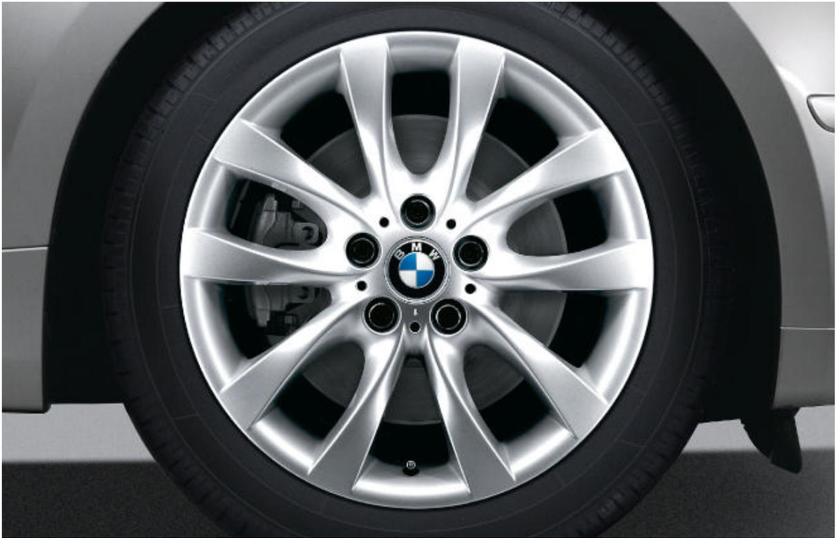
□ **BMW Leichtmetallräder V-Speiche 217** mit Mischbereifung und Notlaufeigenschaften, vorn in der Größe 7,5 J x 18 Zoll mit Reifen im Format 215/40 R 18, hinten in 8,5 J x 18 Zoll mit der Bereifung 245/35 R 18.
