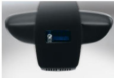
□ **Regensensor, inkl. Fahrlichtautomatik;** einmal aktiviert, schaltet der Regensensor je nach Stärke des Regens automatisch die Scheibenwischer ein und regelt selbsttätig die Wischfrequenz. Die integrierte Fahrlichtautomatik schaltet bei beginnender Dunkelheit oder Tunnelfahrten automatisch das Abblendlicht ein.
