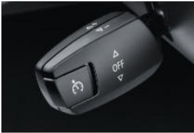
□ **Geschwindigkeitsregelung** speichert ab ca. 30 km/h die gewünschte Geschwindigkeit und hält sie konstant (Betätigung über Lenkstockhebel links). Nach einer Beschleunigung erreicht das Fahrzeug automatisch wieder die ursprünglich gespeicherte Geschwindigkeit. Durch Bremsen wird die Funktion außer Kraft gesetzt.
