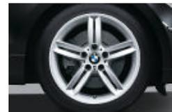
□ **BMW Leichtmetallräder Doppelspeiche 208 M** mit Mischbereifung und Notlauf Eigenschaften: vorn 7,5 J x 18 Zoll mit Bereifung 215/40 R 18, hinten 8,5 J x 18 Zoll mit Bereifung 245/35 R 18.
