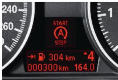
■ **Auto Start Stop Anzeige** (für alle Vierzylinder-Modelle in Verbindung mit 6-Gang Schaltgetriebe) signalisiert im Info Display, wenn der Motor über die Auto Start Stop Funktion abgeschaltet ist (z. B. vor einer Ampel oder bei einem Stau). Die Anzeige erlischt wieder beim erneuten automatischen Starten des Motors.
