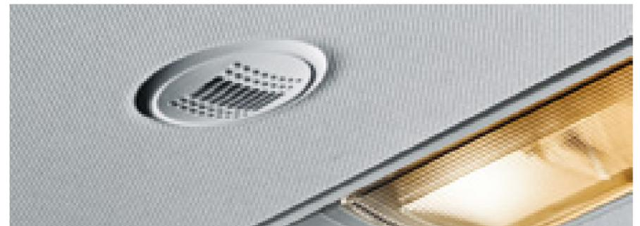
Das **„Digital Voice Enhancement (DVE)“**. Mikrofone über den Vordersitzen und im Dachhimmel des Fahrgastraums machen Gespräche zwischen den Passagieren viel angenehmer. DVE ist nur zusammen mit dem Radio „RCD 310“ sowie dem Radio-Navigationssystem „RNS 510“ erhältlich. Eine Mobiltelefonvorrichtung ist problemlos mit DVE kompatibel, sodass sich auch die Fahrgäste mit dem Anrufenden unterhalten können.
