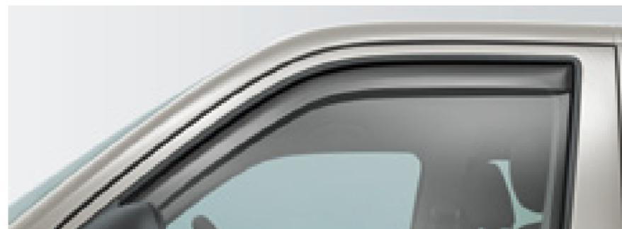
Der **Wind- und Regenabweiser**. Bei der Fahrt mit leicht geöffnetem Fenster werden Spritzwasser und störende Windgeräusche wirksam reduziert, bei seitlich einfallender Sonne wird Blendschutz gegeben. Der Abweiser hat eine exakte Passform und ist ohne Bohren und Kleben leicht zu montieren. Das zweiteilige Set besteht aus je einem Windabweiser für das rechte und das linke Seitenfenster.
