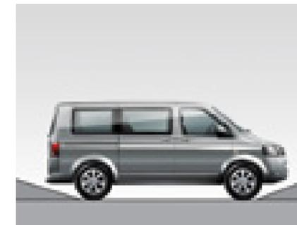
Der **Böschungswinkel: 17° hinten, 21° vorne**. Hangfahrten sind für den Multivan kein Problem. Dank seines Radstandes setzt er mit seinen Stoßfängern auch dann nicht auf, wenn der Böschungswinkel vorne 21° beträgt.<sup>5)</sup>
