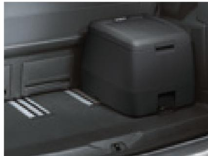
Die **Isolierbox**. Sie wird elektrisch betrieben und ist zum Kühlen und Wärmen geeignet. Die anthrazitfarbene 32-l-Isolierbox kann 1,5-l-Flaschen liegend und 1,0-l-Flaschen stehend aufnehmen.
