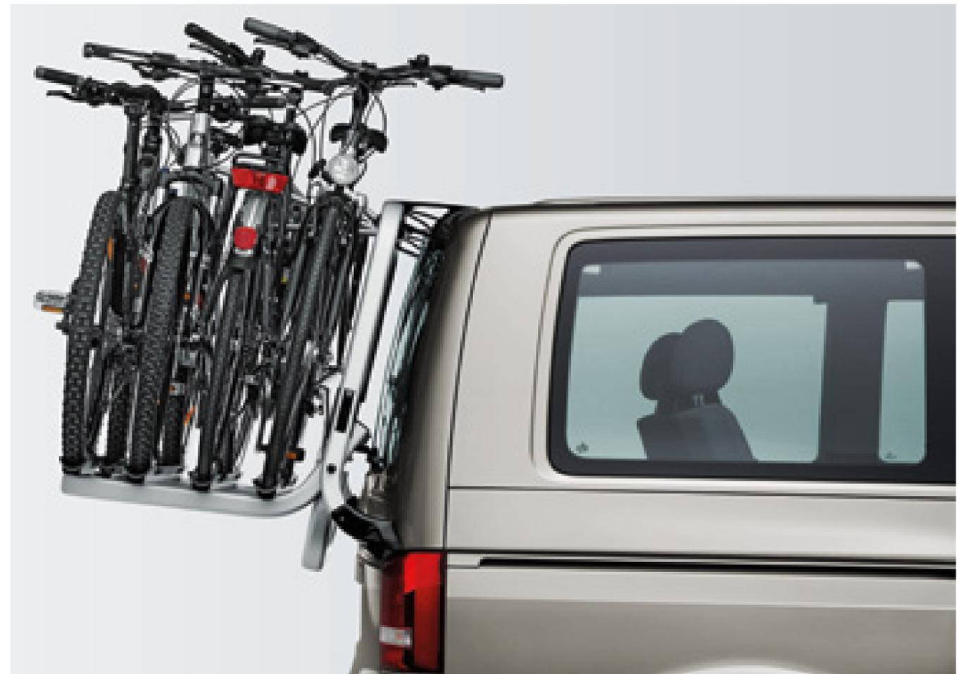
Der **Fahrradträger**. Der aus eloxiertem Aluminiumprofil gefertigte, 13 kg leichte Träger ist für den Transport von bis zu vier Fahrrädern (max. 60 kg) konstruiert und lässt sich durch Vormontage schnell an der Heckklappe anbringen. Er ist mit einer diebstahlhemmenden Verschlusseinrichtung versehen. Das Öffnen der Heckklappe bleibt von der Montage des Trägers (ohne Fahrrad) unbeeinträchtigt.
