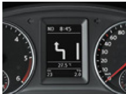
Die **Multifunktionsanzeige „Plus“**. Das monochrome TFT-Display zeigt aktuelle Informationen an, u. a. Außentemperatur, Reichweite, Durchschnittsgeschwindigkeit und -verbrauch. Im Highline und PanAmericana ist die MFA „Premium“ Serie.
