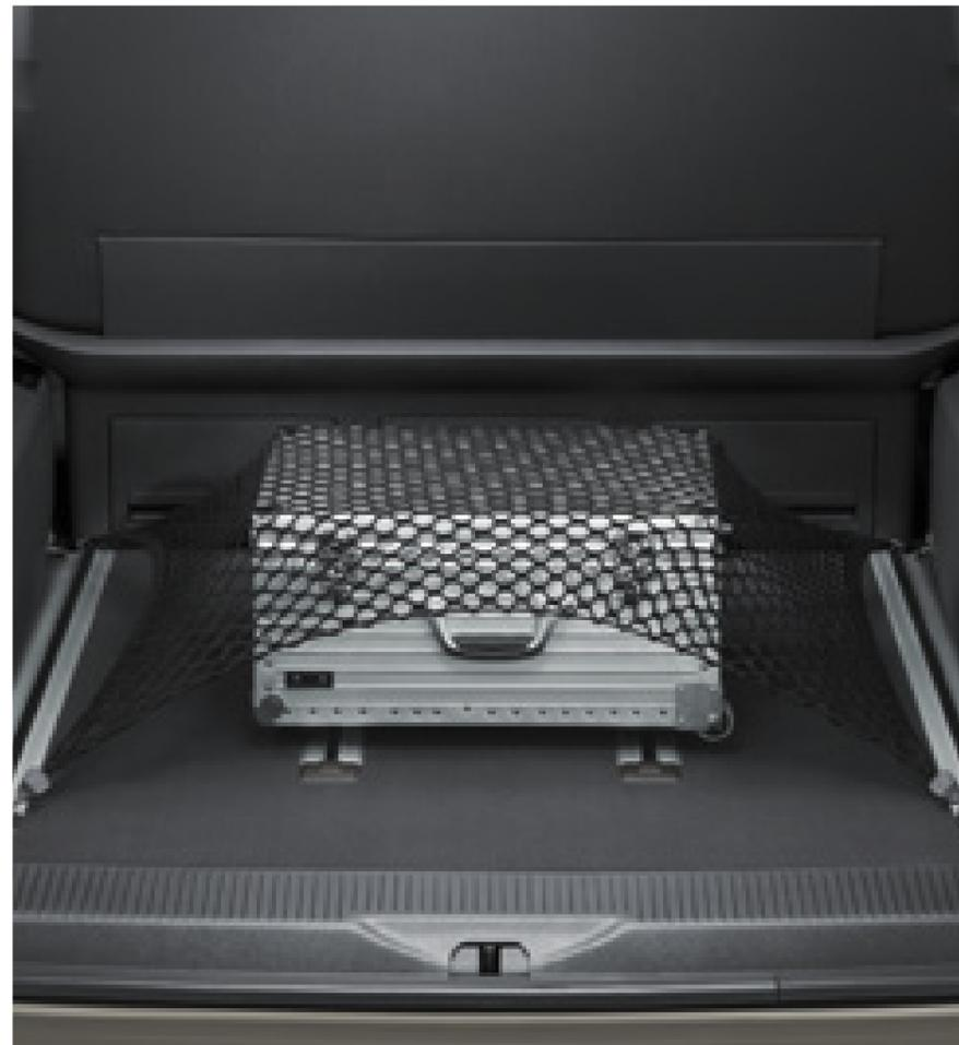
Das **Gepäcknetz**. Damit nichts ins Rutschen kommt und alles an seinem Platz bleibt, wird das reißfeste Netz mit seinen Befestigungshaken an den serienmäßig vorhandenen Verzurrösen im Laderaum eingespannt.
