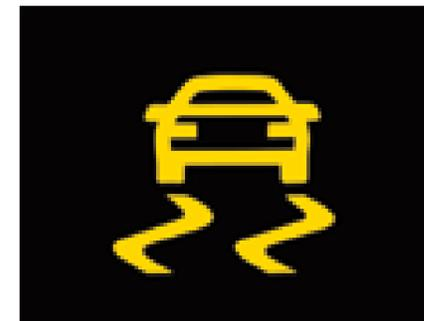
Das **elektronische Stabilisierungsprogramm** inkl. elektronischer Differenzialsperre (EDS). Die Elektronik kann ein Ausbrechen des Fahrzeugs verhindern, indem sie kontrolliert in das Brems- und Motormanagement eingreift.<sup>3)</sup>
