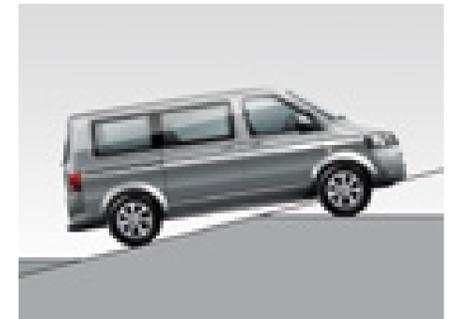
Der **Rampenwinkel: 14°**. Je mehr Spielraum zum Boden, desto mehr Spielraum auf neuen Wegen. Selbst Kuppen mit einem Rampenwinkel von bis zu 14° überwindet der Multivan nahezu spielend.<sup>5)</sup>
