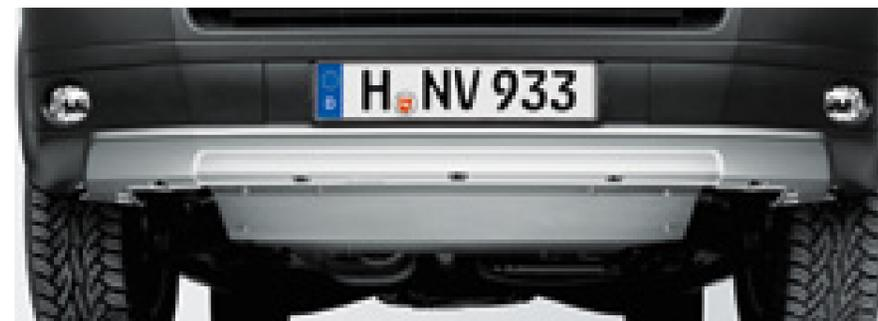
Der **Motorunterfahrerschutz**. Die stabile Metallplatte bietet auch in extremen Situationen ein Höchstmaß an Schutz für den Motor und das Getriebe. Darüber hinaus sind weitere Schutzvorrichtungen für den Unterboden bestellbar, z.B. für den Tank. Bitte beachten Sie, dass durch das erhöhte Fahrzeug-Leergewicht die Nutzlast geringer wird.
