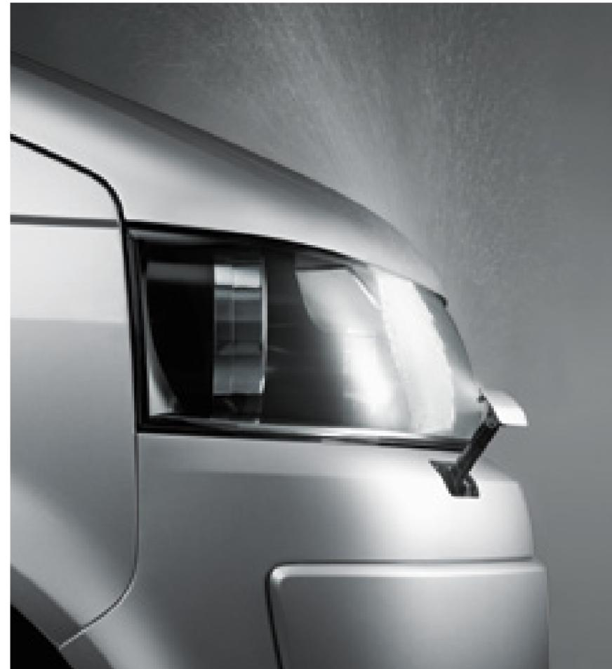
Die **Scheinwerferreinigungsanlage**. Ist das Abblend- oder Fernlicht eingeschaltet, werden bei jedem fünften Waschvorgang der Windschutzscheibe die Scheinwerfergläser mitgereinigt.
