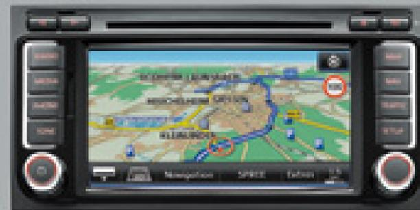
Das **Radio-Navigationssystem „RNS 510“**. Dieses System bietet alle Funktionen des „RNS 315“, verfügt jedoch über einen Farbtouchscreen mit einer Diagonalen von über 16 cm. Auf der mitgelieferten DVD ist das Kartenmaterial für Westeuropa gespeichert. Es kann auf die 30-GB-Festplatte des „RNS 510“ kopiert werden, sodass Sie während der Navigation den CD-Schacht nutzen können, um über die acht Lautsprecher Ihre Lieblings-CD zu hören. Zudem ist das Gerät mit einer Spracherkennung ausgestattet.
