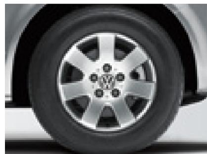
Die **rollwiderstandsoptimierten Reifen**. Der Multivan mit BlueMotion Technology nimmt den Kontakt zur Straße über rollwiderstandsoptimierte Reifen auf. Der geringere Rollwiderstand reduziert den Kraftstoffverbrauch und damit den CO<sub>2</sub>-Ausstoß.
