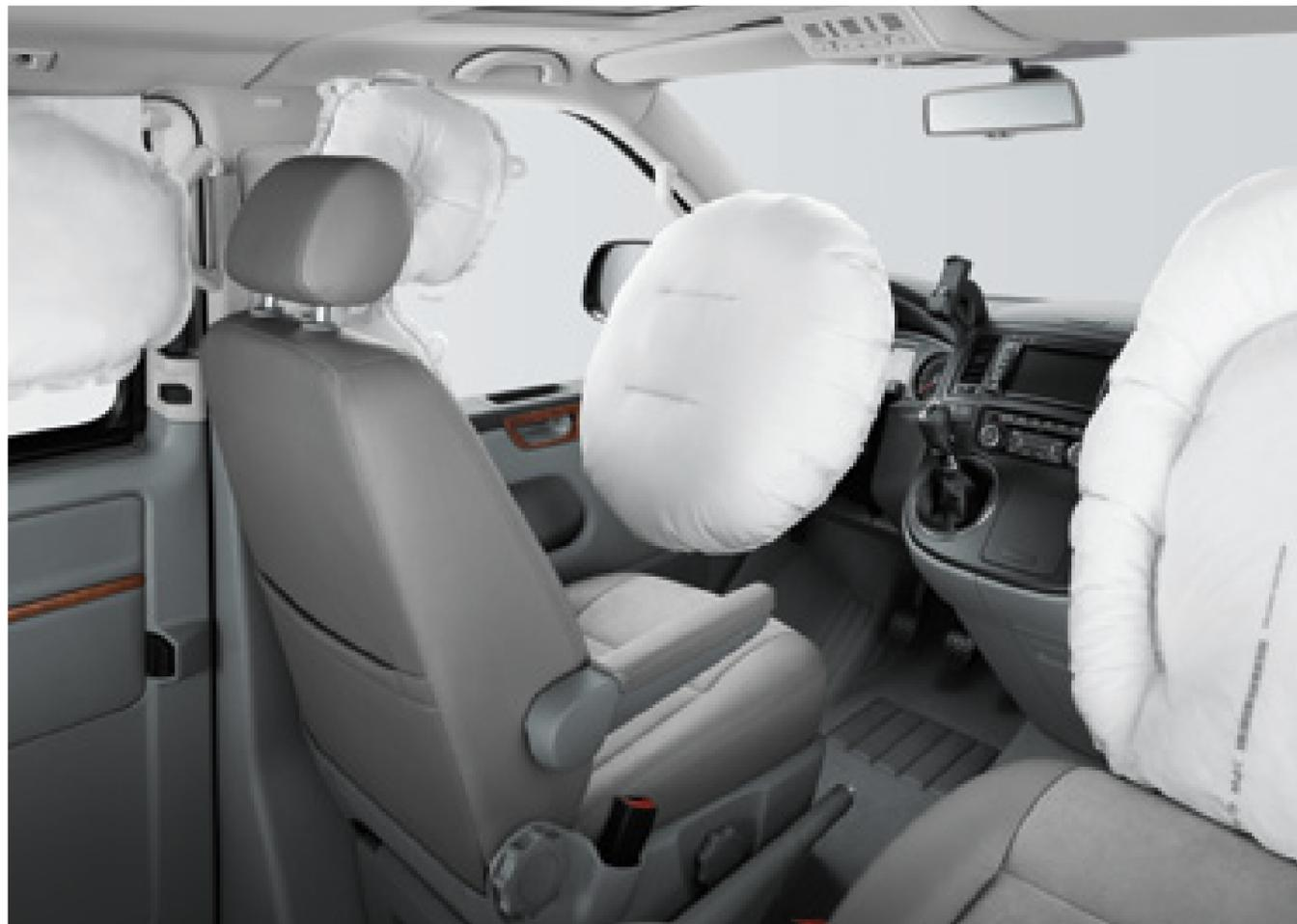
Die **Airbags**. Wer täglich unterwegs ist, sollte optimal geschützt sein. Deshalb ist der Multivan serienmäßig nicht nur mit einem Fahrer- und einem Beifahrerairbag ausgestattet, sondern auch mit Seiten- und Kopfairbags. Der Beifahrerairbag kann mit dem Fahrzeugschlüssel deaktiviert werden. Im Fahrgastraum schützen zudem optionale Kopfairbags<sup>2)</sup> die Passagiere.
