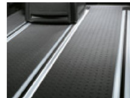
**Das 4-Schienen-System.** Darin können z. B. eine 3er-Sitzbank, die Einzelsitze und die Isolierbox befestigt und verschoben werden. Der Multivan Highline und der Comfortline mit zwei Schiebetüren verfügen über ein 6-Schienen-System.
