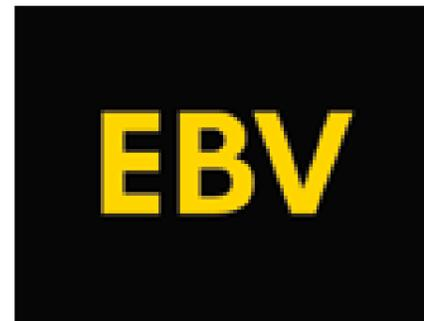
Die **elektronische Bremskraftverteilung (EBV)**. Wenn sich das Fahrzeuggewicht beim Bremsen auf die Vorderäder legt, verhindert sie das Blockieren der weniger belasteten Hinterräder.
