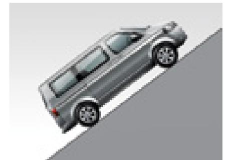
Die **Steigfähigkeit: 37°**. Serpentinen und ansteigendes Gelände nimmt der Multivan mit 132-kW-Motor<sup>4)</sup> und 3.000 kg Fahrzeuggewicht nahezu mühelos bis zu einer Steigung von 37°.
