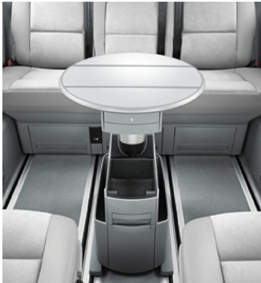
**Der Multifunktions-tisch.** Dieser Tisch bietet neben einer runden Ablagefläche zahlreiche Fächer für kleine und große Reiseutensilien. Bei Nichtgebrauch wird die Tischplatte um 90° gedreht, zusammengeklappt und im Tischfuß versenkt. Danach kann der Multifunktions-tisch auf den beiden zusätzlichen Mittelschienen zwischen die Einzelsitze geschoben werden.
