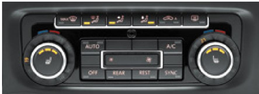
Die **Klimaanlage „Climatronic“**. Dieses System bietet eine 3-Zonen-Temperaturregelung für Fahrer, Beifahrer und Passagiere im Fahrgastraum. Es erkennt die Stärke der Sonneneinstrahlung und die Außentemperatur und führt entsprechend mehr oder weniger kühle Luft zu. Die automatische Umluftschtung und der Luftgütesensor schaffen ein angenehmes Klima.
