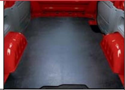
▶ **Holzboden.** Eine robuste, speziell konstruierte Sperrholzplatte schützt Fracht und Fahrzeugboden.
