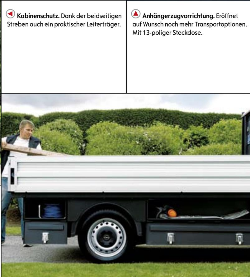
▶ **Unterflur-Staukästen.** Werkzeug und Kleinteile kommen sicher mit – in den geräumigen, abschließbaren Staukästen.
