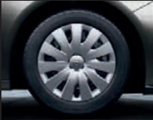
Stahlräder mit ganzflächiger Abdeckung, 7J x 17 mit Reifen 235/55 R 17 (PWP). Serie für Edition in Verb. mit Benzinmotoren.
