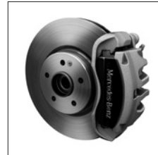
43,2 cm (17") Bremsanlage an der VA und Bremsättel mit »Mercedes-Benz« Schriftzug (BS1)
