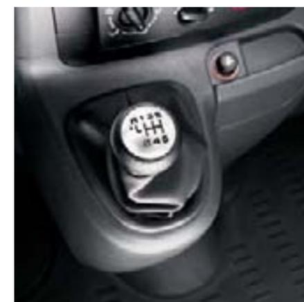
*Cambio a 5 o 6 marce a seconda delle motorizzazioni, con leva sulla plancia.*
