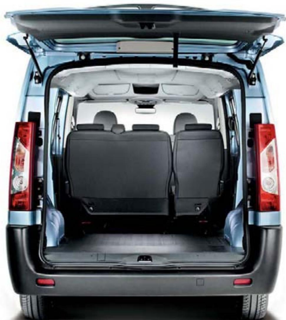
Scudo Combi e Panorama sono disponibili nelle versioni passo corto e passo lungo, entrambe a 5/6 o 8/9 posti. La seconda e la terza fila di sedili possono essere ripiegate, impacchettate o rimosse quando è necessario riservare più spazio per i bagagli.
