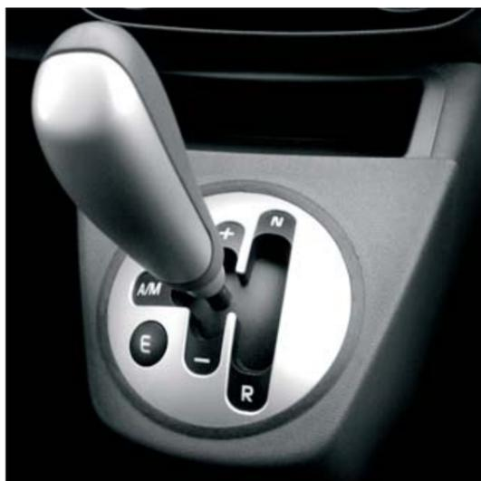
La boîte de vitesses robotisée Comfort - Matic offre rapidité de passage et précision. Elle propose 3 modes de fonctionnement : automatique, économique et séquentiel.
