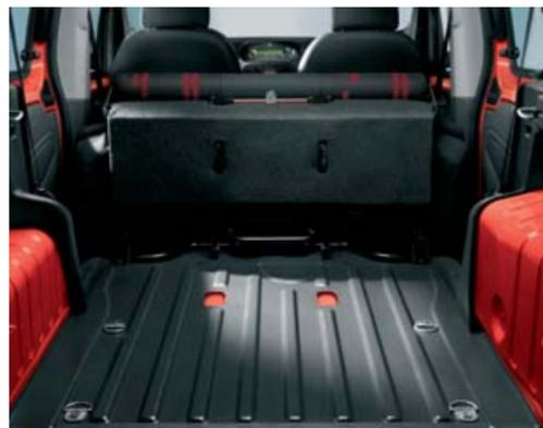
La modularité est assurée par une banquette arrière rabattable et escamotable qui permet d'obtenir un espace de chargement allant jusqu'à 2,5 m<sup>3</sup>.
