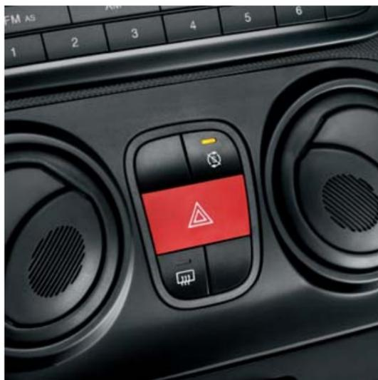
Le système Start&Stop™ coupe le moteur pendant les arrêts de courte durée, comme par exemple à un feu rouge, et le redémarre automatiquement lorsque la pédale d'embrayage est enfoncée. Disponible de série sur les motorisations Diesel Multijet, le système Start&Stop™ permet de réduire la consommation de carburant et les émissions.
