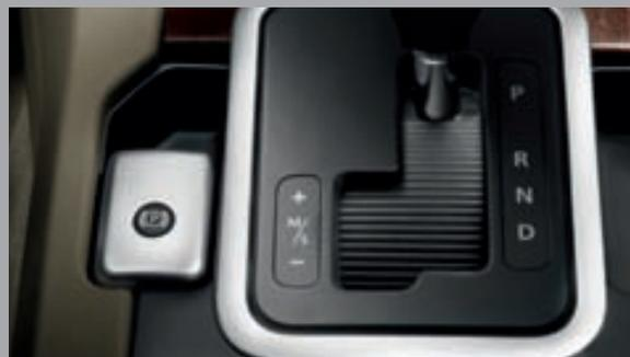
**FREIN DE PARKING ÉLECTRIQUE (OU EPB).** Un commutateur placé à côté du sélecteur de vitesses active ou désactive le frein de parking sur les roues arrière. En mode manuel, il vous suffit de tirer sur la poignée de frein pour enclencher le frein de parking ou de le relâcher pour libérer le véhicule. Lors de la mise en mouvement du véhicule, le frein de parking se désactive automatiquement.
