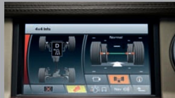
**SUSPENSION PNEUMATIQUE**. Suspension pneumatique à 4 roues indépendantes avec hauteur de caisse variable et liaisons transversales électroniques qui apportent l'avantage d'une garde au sol constante, quel que soit la répartition des charges à bord. Pour vous défaire des obstacles difficiles, la hauteur de caisse peut être rehaussée jusqu'à 125 mm ou abaissée de 50 mm pour faciliter l'accès et le chargement.
