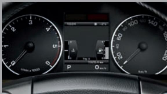
**TABLEAU DE BORD ÉLECTRONIQUE** avec écran TFT (Thin Film Transistor) de 5 pouces (12,7 cm) pour afficher les informations de navigation, les principaux indicateurs de conduite et les messages d'alerte.
