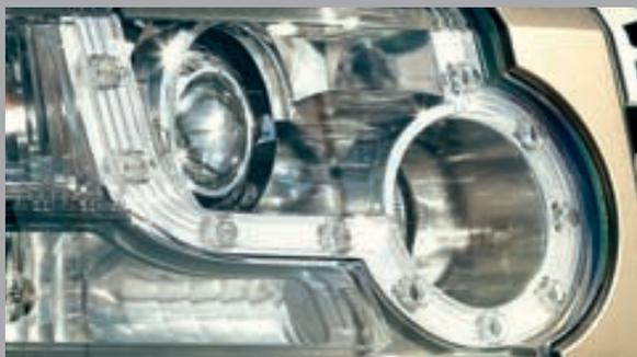
**ALLUMAGE AUTOMATIQUE DES PHARES AVEC SYSTEME ANTI-EBLOUISSEMENT\***. Détecte les feux avant ou arrière des autres véhicules et passe automatiquement en feux de croisement jusqu'à ce que la source lumineuse de ces véhicules disparaisse. Cette technologie sait également distinguer les phares des véhicules d'autres sources lumineuses.
