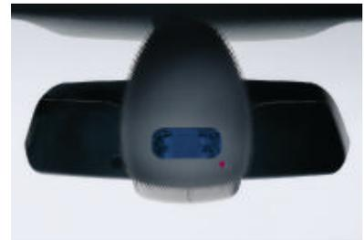
□ **Regensensor, inkl. Fahrlichtautomatik**: Einmal aktiviert, schaltet der Regensensor je nach Stärke des Regens automatisch die Scheibenwischer ein und regelt die Wischfrequenz. Die integrierte Fahrlichtautomatik schaltet bei beginnender Dunkelheit oder Tunnelfahrten automatisch das Abblendlicht ein (Serie für X3 xDrive35d).
