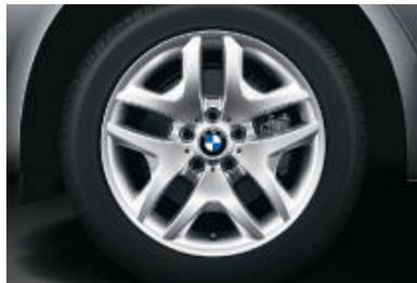
**BMW Leichtmetallräder Doppelspeiche 192 M mit Mischbereifung:** vorn 8 J x 18 Zoll mit Bereifung 235/50 R 18, hinten 9 J x 18 Zoll mit Bereifung 255/45 R 18.
