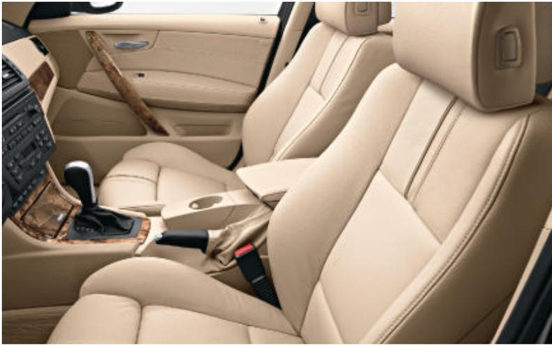
□ **Sportsitz** für Fahrer und Beifahrer, hoch ausgeformte Sitzwangen sorgen für optimalen Seitenhalt in jeder Fahrsituation; Sitzhöhe, Lehnen- und Sitzneigung, Längsposition sowie Oberschenkelauflage sind individuell verstellbar.
