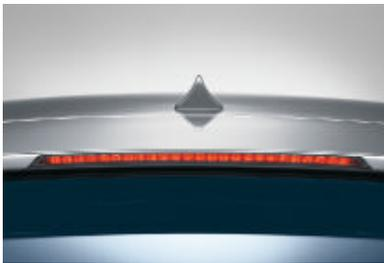
■ **Bremsleuchte**, dritte, für mehr Sicherheit hochgesetzt und in den in Wagenfarbe lackierten Dachspoiler integriert.
