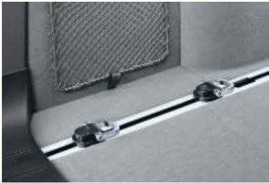
□ **Ablagenpaket** enthält die Armauflage vorn, Gepäcknetze an den vorderen Sitzlehnen, Gepäcknetze an der Mittelkonsole unten auf der Beifahrerseite und im Gepäckraum links, Verzurrschienen mit vier arretierbaren Ösen (Abbildung) im Gepäckraumboden sowie einen Wendeboden, Multifunktionshaken und ein Flaschenspannband im Gepäckraum.
