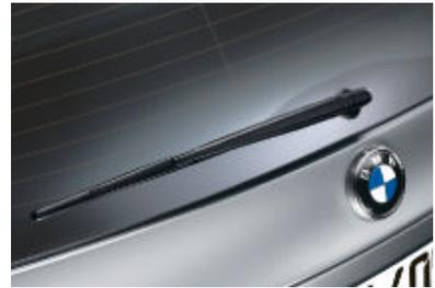
■ **Heckscheibenwischer** mit Intervallschaltung.
