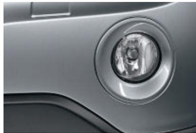
■ **Nebelscheinwerfer**, in der Frontschürze integriert, für mehr Sicherheit bei schlechten Sichtverhältnissen.
