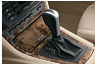
□ **6-Gang Automatic Getriebe Steptronic**, mit Adaptiver Getriebesteuerung (AGS), Shift-/Interlock; die Schaltung ermöglicht sehr komfortable und sportliche Gangwechsel – für ein Höchstmaß an Fahrdynamik (Serie für X3 xDrive35d, nicht erhältlich für X3 xDrive20i und X3 xDrive18d).
