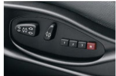
□ **Komfortsitz** für Fahrer und Beifahrer mit Rafftaschen, elektrischer Sitzhöhen- und Lehnen- sowie Längspositions- und Neigungsverstellung, inkl. Memory-Funktion für Fahrersitz und Außenspiegel (Bordsteinautomatik). Zusätzliche elektr. Verstellfunktionen: variable Schulterabstützung, Kopfstützen und Lordosenstütze.
