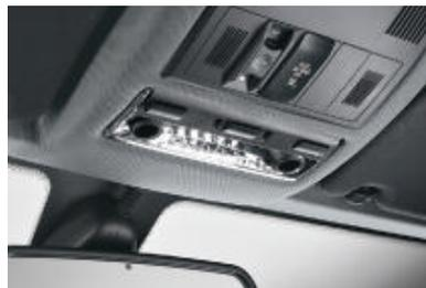
■ **Innenleuchten** mit Innenlichtautomatik, „weicher“ Ein-/Aus-Schaltung beim Öffnen/Schließen des Fahrzeugs, Auflichtbeleuchtung der Mittelkonsole sowie für X3 xDrive30i, xDrive30d und xDrive35d Leseleuchten vorn und hinten, Fußraumleuchten vorn sowie Make-up-Spiegel-Leuchten.
