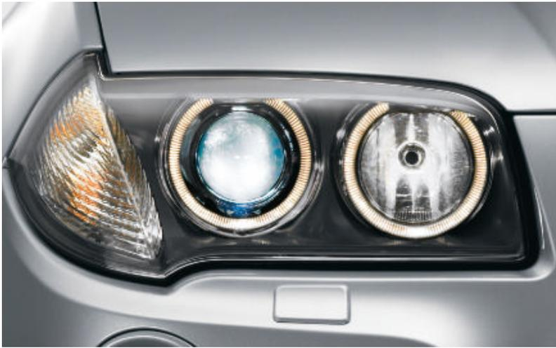
□ **Xenon-Licht für Abblend- und Fernlichtfunktion**, inkl. Scheinwerfer-Waschanlage und automatischer Leuchtweitenregulierung, leuchtet die Fahrbahn nachts, bei schlechter Witterung oder Sicht deutlich besser aus.
