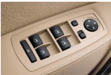
■ **Fensterheber**, elektrisch, Zug-Druckschalter, inkl. Maufunktion, Einklemmschutz und Komfortschließung rundum.
