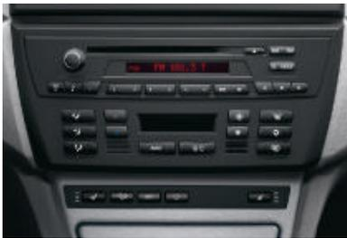
■ **Radio BMW CD**, 6 x 25 Watt Verstärkerleistung, integriertes CD-Laufwerk, motorischer CD-Einzug/-Ausschub.
