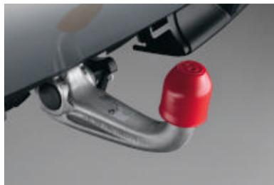
□ **Anhängerkupplung** mit abnehmbarem Kugelkopf, inkl. Anhänger-Stabilitätskontrolle (in DSC integriertes System, das über die Belegung der Steckdose am Heck aktiviert wird). Eine angepasste Federung an der Hinterachse gleicht das zusätzliche Gewicht der Kupplung aus.
