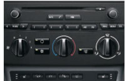
■ **Klimaanlage**, inkl. Mikrofilter, ermöglicht zu jeder Jahreszeit ein komfortables Innenraumklima, Luftmengenregelung und Luftverteilung manuell einstellbar.
