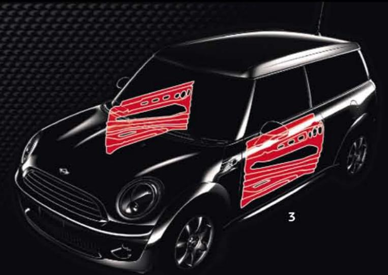
**3 VERSTÄRKUNGSPROFILE.** Diese Elemente werden im oberen und mittleren Bereich der Türen sowie im Bereich der Seitenschweller integriert. Sie erzeugen eine sehr hohe Steifigkeit der Karosserie und bieten bei einer Kollision hohen Insassenschutz.
