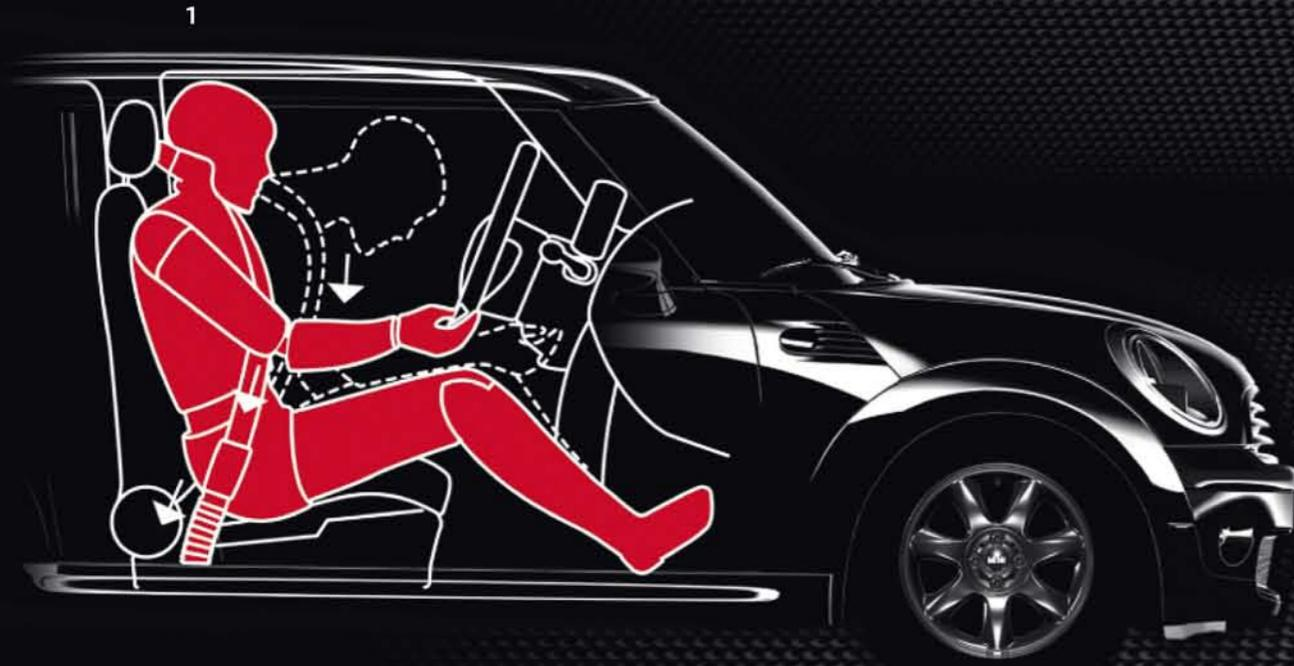
**1 RÜCKHALTESYSTEM.** Im Fall eines Crashes werden Fahrer und Beifahrer mit einer Kombination aus 3-Punkt-Sicherheitsgurt, Gurtstrammer und Gurtkraftbegrenzer geschützt.
