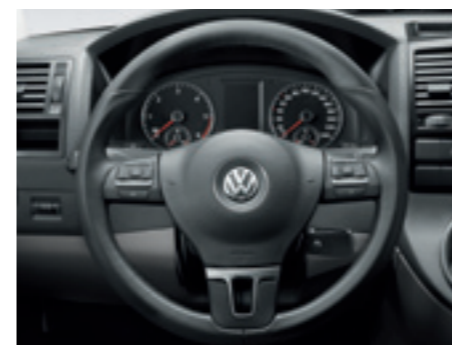
Das Multifunktionslenkrad . Über integrierte Schalter lassen sich das Radiosystem und ein optionales Mobiltelefon bedienen. Serienmäßig sind alle Lenkräder in Höhe und Neigung verstellbar.
