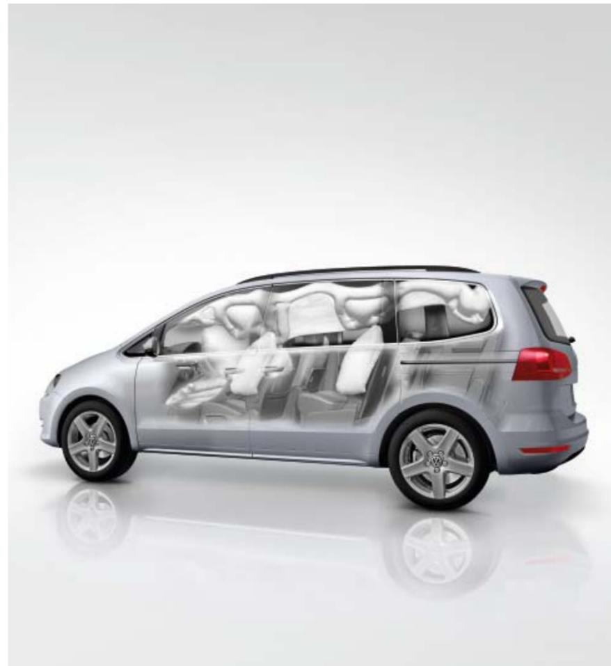
Front- und Seitenairbags für Fahrer und Beifahrer sowie Kopfairbags für Front- und Fondpassagiere sorgen für optimalen Insassenschutz. Auf der Fahrerseite befindet sich zusätzlich ein Knieairbag. Die Airbags werden im Falle eines Crashes innerhalb weniger Millisekunden ausgelöst und von einem Gasgenerator gefüllt.
