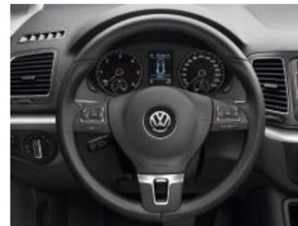
Über das **Multifunktions-Lederlenkrad** können Sie zum Beispiel Radio-Navigationssystem und Mobiltelefon bequem handhaben. In Verbindung mit dem Doppelkupplungsgetriebe DSG lassen sich die Gänge mittels griffiger Schaltwippen wechseln.
