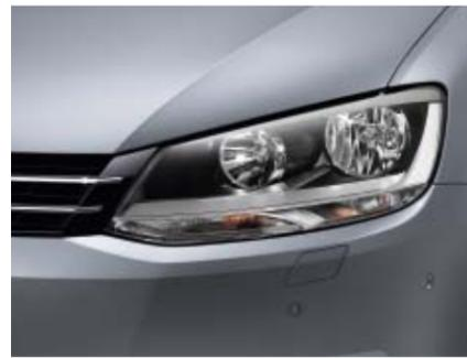
Die **Halogen-Hauptscheinwerfer in Klarglas mit Tagfahrlicht** ermöglichen bei jedem Wetter eine bessere Sicht und können auf Wunsch um den „Light Assist“ ergänzt werden.
