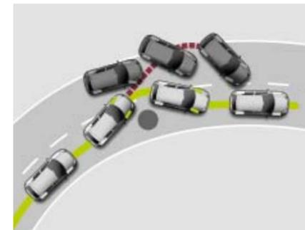
Das Elektronische Stabilisierungsprogramm (ESP) verhindert in kritischen Fahrsituationen ein Ausbrechen des Fahrzeuges, indem es gezielt in das Brems- und Motormanagement eingreift.
