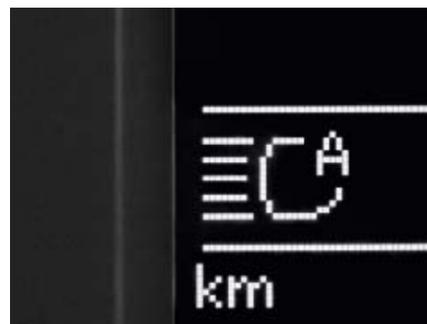
Der „Light Assist“ maximiert die Einschaltzeit des Fernlichts bei Dunkelheit und blendet nur ab, wenn Umgebung oder Gegenverkehr es erfordern. So genießt der Fahrer eine optimale Fahrbahnausleuchtung, ohne das Fernlicht selbst betätigen zu müssen.
