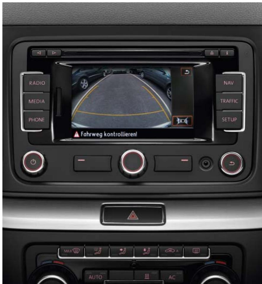
Auf dem Radio- bzw. Navigationsdisplay wird das elektronisch entzerrte Bild der Rückfahrkamera „Rear Assist“ in der Heckklappe wiedergegeben. Durch freie Sicht hinter das Fahrzeug ist so besseres und einfacheres Einparken möglich. Auch das Ankuppeln eines Anhängers wird dadurch erleichtert.
