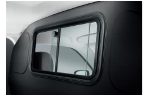
Das Schiebefenster in der Trennwand zum Laderaum ermöglicht jederzeit einen Blick in den Laderaum. Eine halbhohle Trennwand ist auch erhältlich (o. Abb.).
