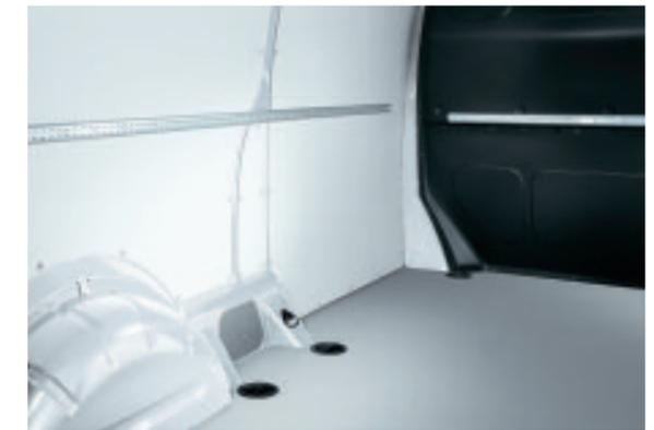
Ein robuster Holzboden für den Laderaum und Verzurrösen und -schienen an Seiten- und Trennwand.
