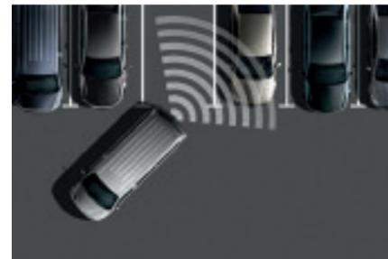
Beim **Spurwechselassistenten Side Assist** überwachen Radarsensoren den Verkehr. Sollte sich beim Spurwechsel ein Fahrzeug im nicht einsehbaren Bereich befinden, warnt Sie das System über eine Anzeige in den Außenspiegeln.
